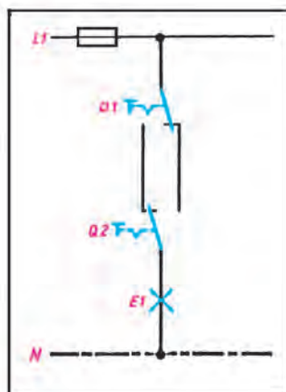
شکل ۱۹- شمای مسیر جریان کلید تبدیل
