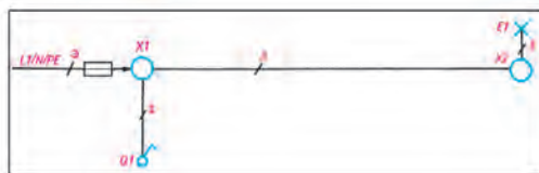
شکل ۱۱- شمای فنی مدار کلید یک پل
