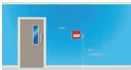
شکل ۸۴- محل و ارتفاع نصب شستی اعلام حریق
