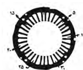
شکل ۷۹- ورق هسته الکتروموتور کولر و شیار شروع سیم پیچ
