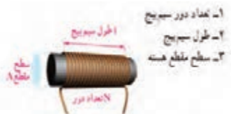
شکل ۳-۸. پارامترهای مهم در یک سلف
