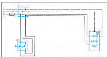
شکل ۱۵- شمای حقیقی مدار کلید دوبل شکل ۱۶- شمای مسیر جریان کلید دوبل
