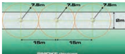
شکل ۸۵- محدوده نصب دتکتور دودی و حرارتی
