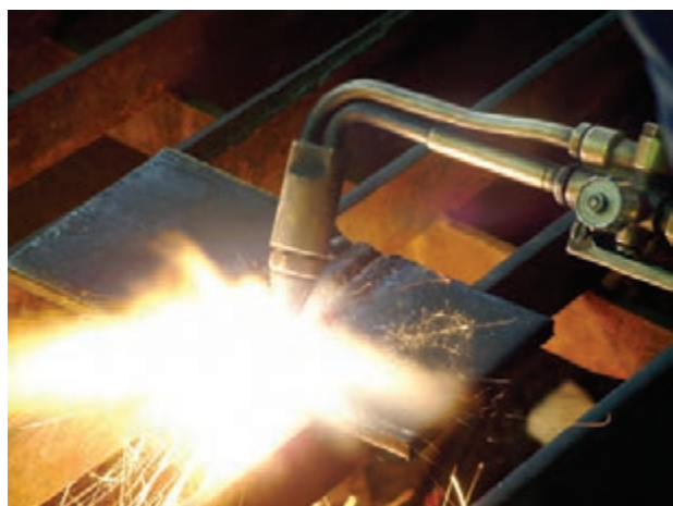
شکل ۲-۶- برشکاری با گاز
