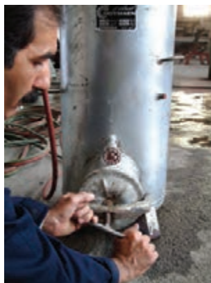
شکل ۲-۳۶ بستن دریچه‌ی محفظه‌ی کاربید
