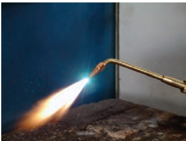
شکل ۲-۳- شعله‌ی سوختن گاز استیلن با اکسیژن
