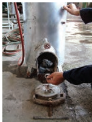
شکل ۲-۳۴ قرار دادن کاربید در محفظه‌ی مخصوص
