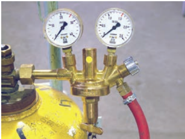
شکل ۱۳۵-۲- پیچ تنظیم فشار استیلن روی رگولاتور
