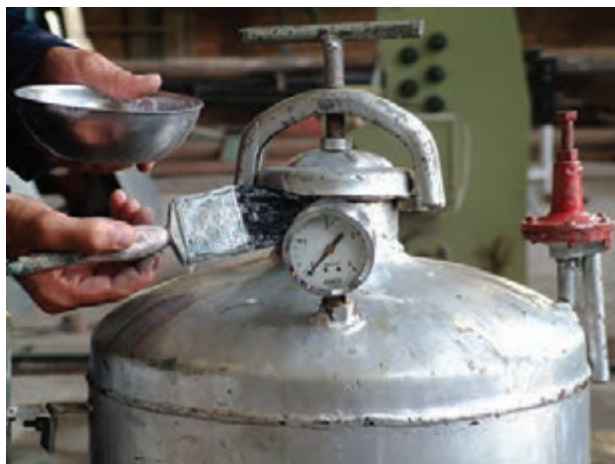
شکل ۲-۳۸- کنترل نشتی گاز
