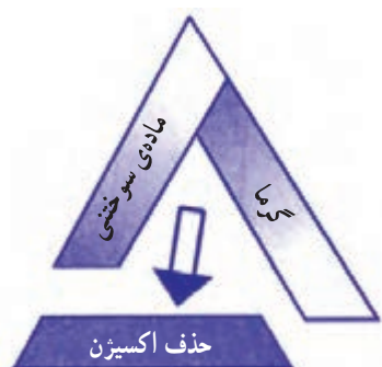
شکل ۱۶-۱- ممانعت از رسیدن اکسیژن به ماده‌ی سوختنی
