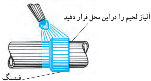
شکل ۴-۱۹- ترتیب گرم کردن لوله و فیتینگ
