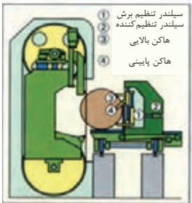
شکل ۳- شماتیک ماشین بلوک بُری
