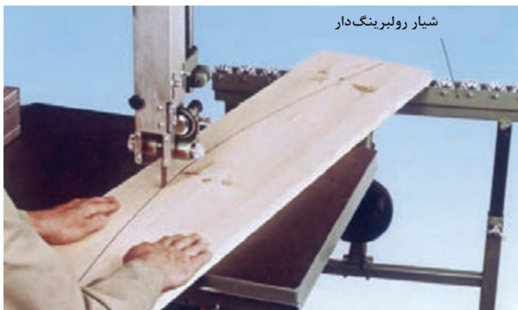
شکل ۱- طرز قرار دادن دست‌ها روی قطعه کار هنگام بریدن
