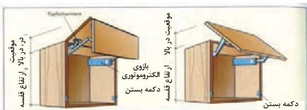
شکل ۷- درهای آویز در حالت قرارگیری در بالای قفسه
