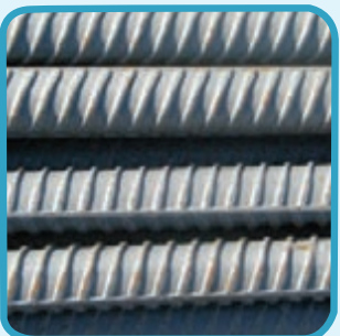
شکل ۱۷-۱- میلگرد با رویه آجدار
