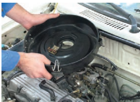
شکل ۱۰۰-۱ پیاده کردن مجموعه هواکش
