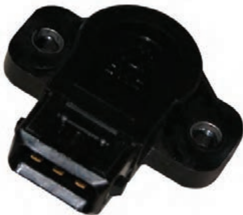
شکل ۲-۳۰- سنسور موقعیت دریچه گاز
