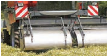
ماشین برداشت گل های بابونه با استفاده از روش شانه با حرکت دورانی و تخلیه خارجی
