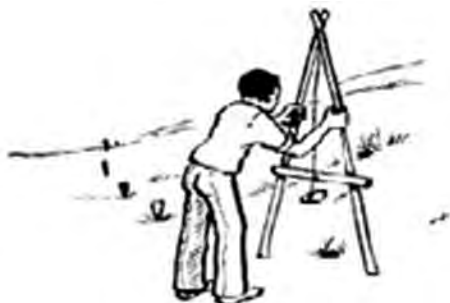
طرز استفاده از قاب مخصوص رسم خطوط تراز
