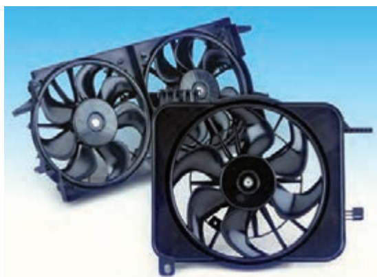
شکل ۶-۶ فن‌های الکتریکی مورد استفاده در خودروها
