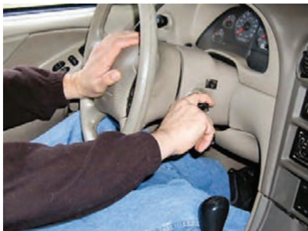
شکل ۴۵- ۷- روشن کردن موتور
