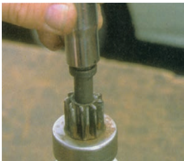
شکل ۸-۶۰ – خارج کردن حلقه رینگ‌ی از شیار شافت
