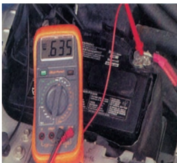
شکل ۸-۳۷ – اندازه‌گیری افت ولتاژ جریان ورودی کابل استارتر
