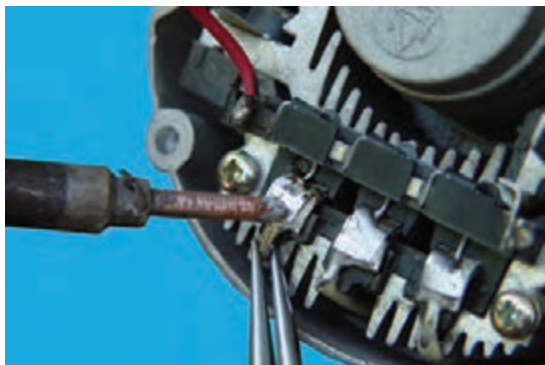
شکل ۷-۵۶- جدا کردن سیم‌های استاتور از یک‌سوکننده
