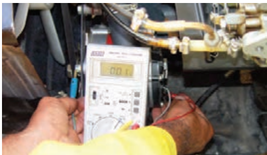
شکل ۷۲-۷ - اتصال ولت‌متر بین ترمینال B و بدنه
