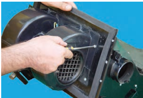
شکل ۴-۳۶- باز کردن پیچ‌های محفظه‌ی موتور
