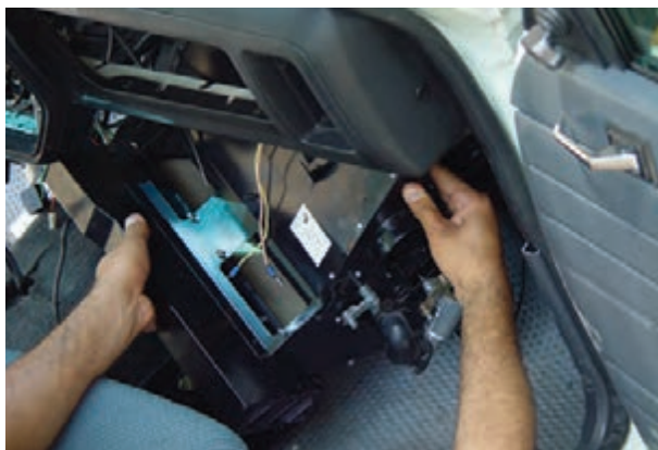
شکل ۴-۳۴- خارج کردن بخاری از محل نصب آب
