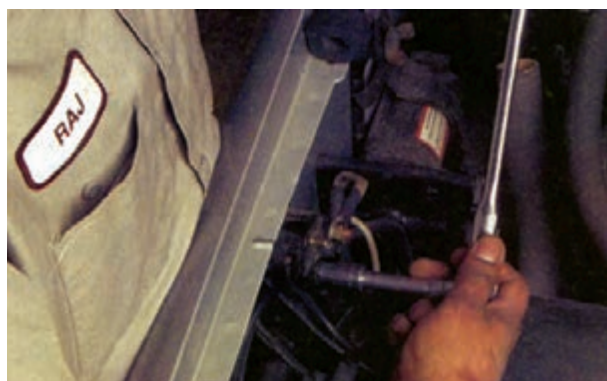
شکل ۸-۴۵ - اندازه‌گیری افت ولتاژ رله‌ی استارتر
