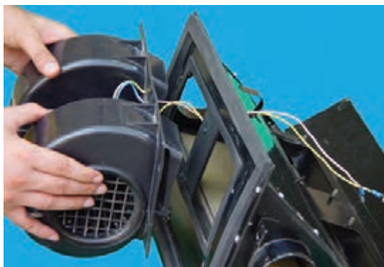
شکل ۴-۳۷ – جدا کردن محفظه‌ی موتور از بخاری
