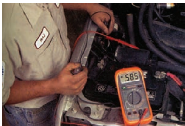
شکل ۸-۴۴ اندازه‌گیری افت ولتاژ پلاتین‌های سولونوید استارتر
