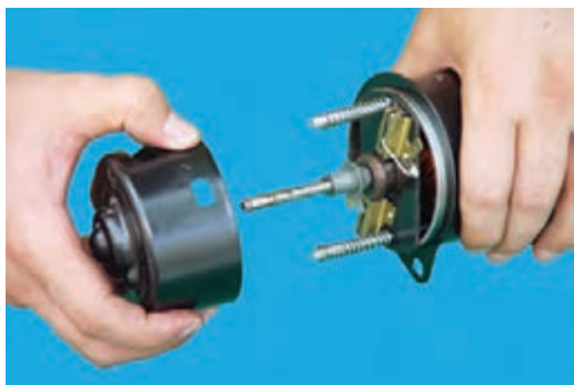
شکل ۴۵-۴ جدا کردن پوسته‌ی موتور
