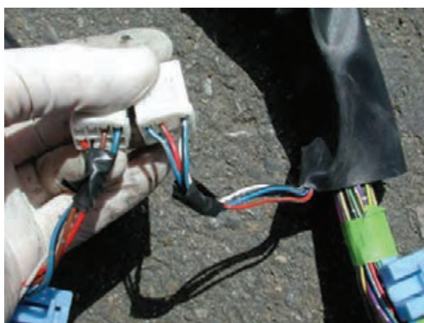
شکل ۳-۲۳- مقایسه و تطبیق سوکت‌های کلاف سیم‌کشی
