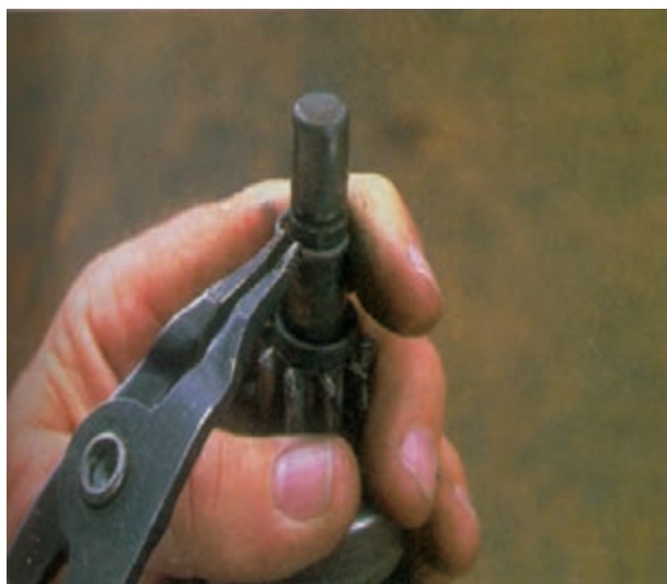
شکل ۸-۶۱ – درآوردن خار رینگ‌ی
