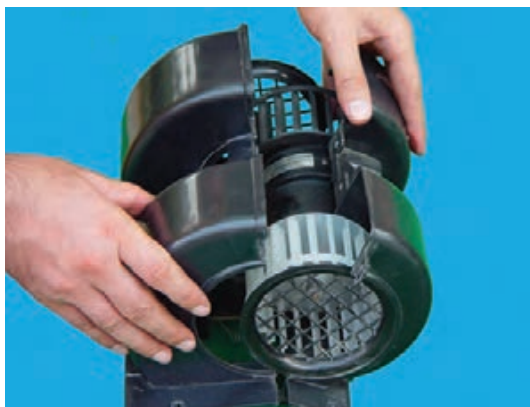
شکل ۴-۴۰ – جدا کردن محفظه‌ی نگه‌دارنده‌ی موتور
