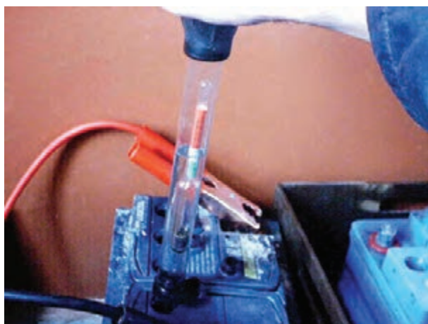
شکل ۱-۵۳- کنترل غلظت الکترولیت
