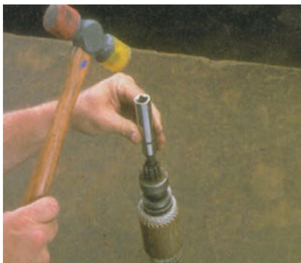
شکل ۸-۵۹ – ضربه زدن با چکش روی خار
