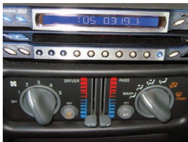
شکل ۵-۲۳ سوئیچ راه‌انداز فن کولر
