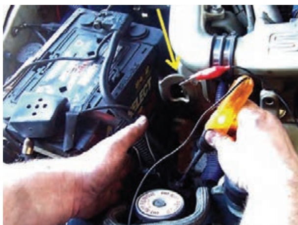
شکل ۴۳-۵ نحوه ی آزمایش سالم بودن سیم کشی
