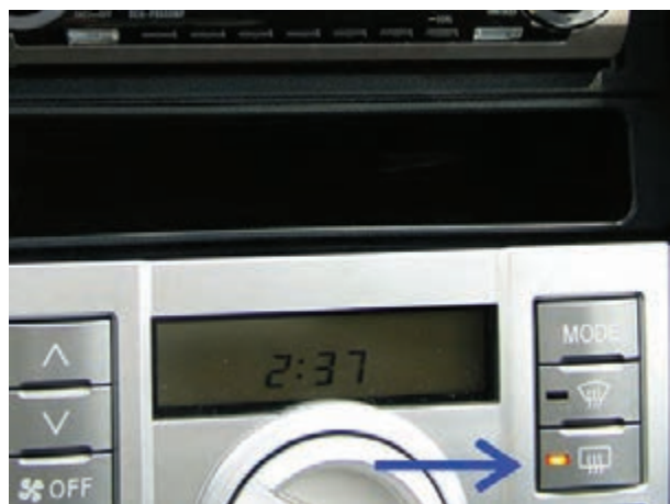
شکل ۳-۱۷- سوئیچ شیشه گرم‌کن در حالت (on)
