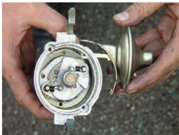
شکل ۳۱-۱۰ جدا کردن مجموعه‌ی آوانس خلئی
