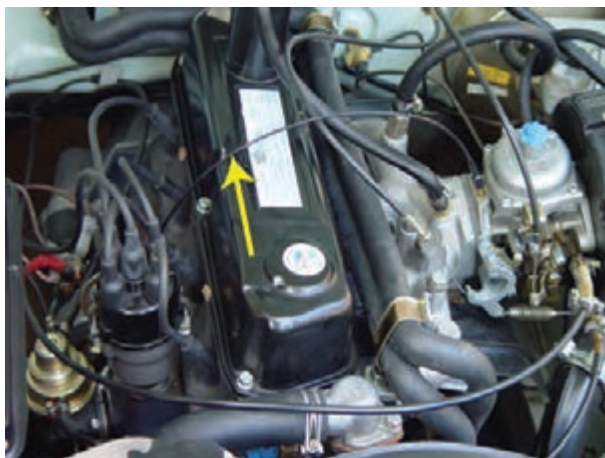
شکل ۲۸- ۱۰- لوله‌ی رابط آوانس خلثی به کاربراتور
