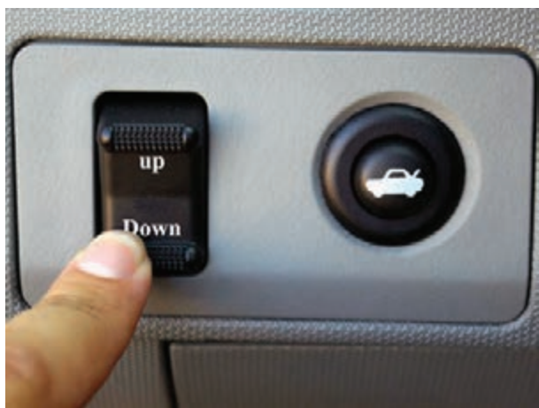
شکل ۵-۱۲ - سوئیچ آنتن الکتریکی
