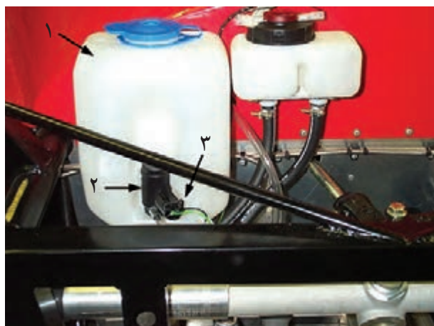
شکل ۷-۲- مخزن و پمپ آب شیشه‌شوی
