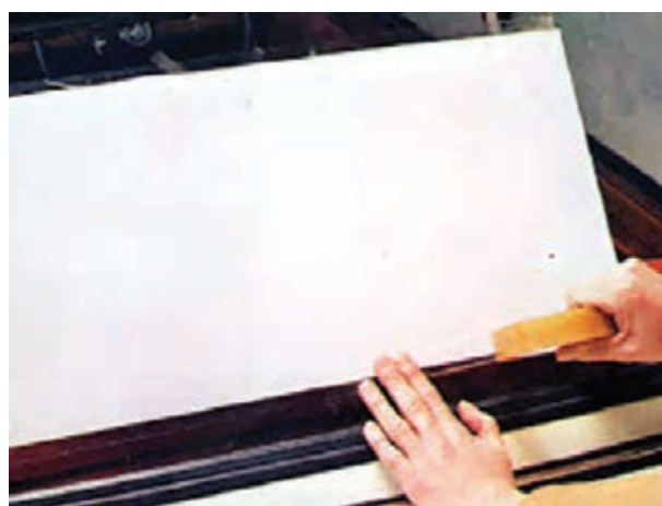
شکل ۳-۷- صفحه‌ی راهنمای نصب المنت حرارتی
