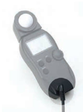
عکس ۲۵۸- اتصال سیم سینکرون به نورسنج
