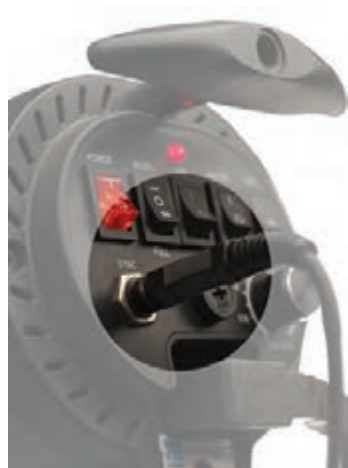
عکس ۲۵۹- اتصال سیم سینکرون به فلاش
