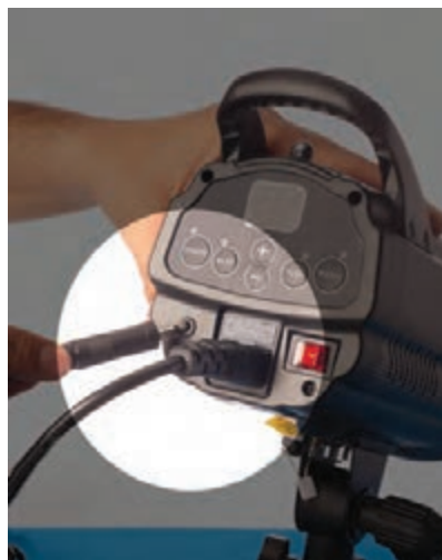
عکس ۲۱۰- اتصال سیم سینکرون تریگر به فلاش
