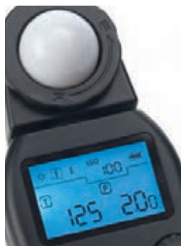
عکس ۲۵۵ سنجش نور فلاش بدون دخالته سیم سینکرون
