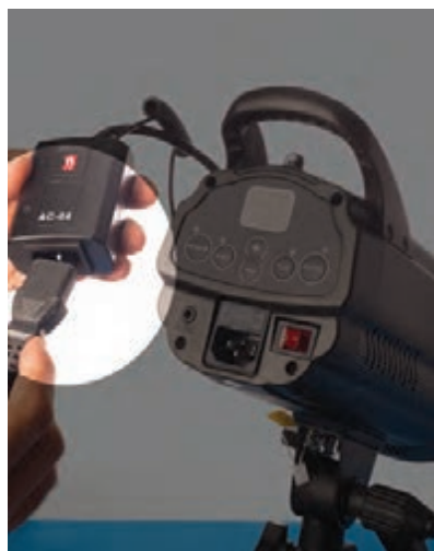
عکس ۲۰۸- اتصال گیرنده تریگر به برق در مدل های برقی
