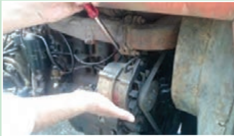
۳- به کمک اهرم، موقعیت مولد برق را تغییر دهید تا به کشش مناسب برسید. سپس پیچ های بازوی تنظیم را سفت کنید.
