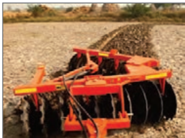
شکل ۱۴- تغییر زاویه استقرار ردیف بشقاب ها روی شاسی
