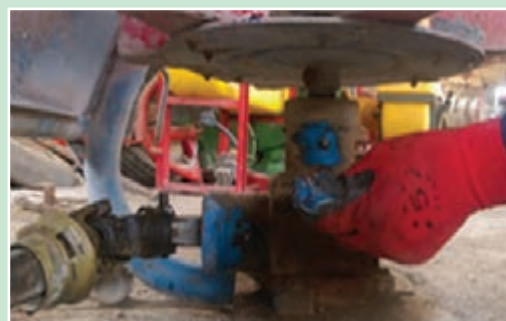
شکل ۳۳- تمیز کردن گریس خورها و مکان آنها
