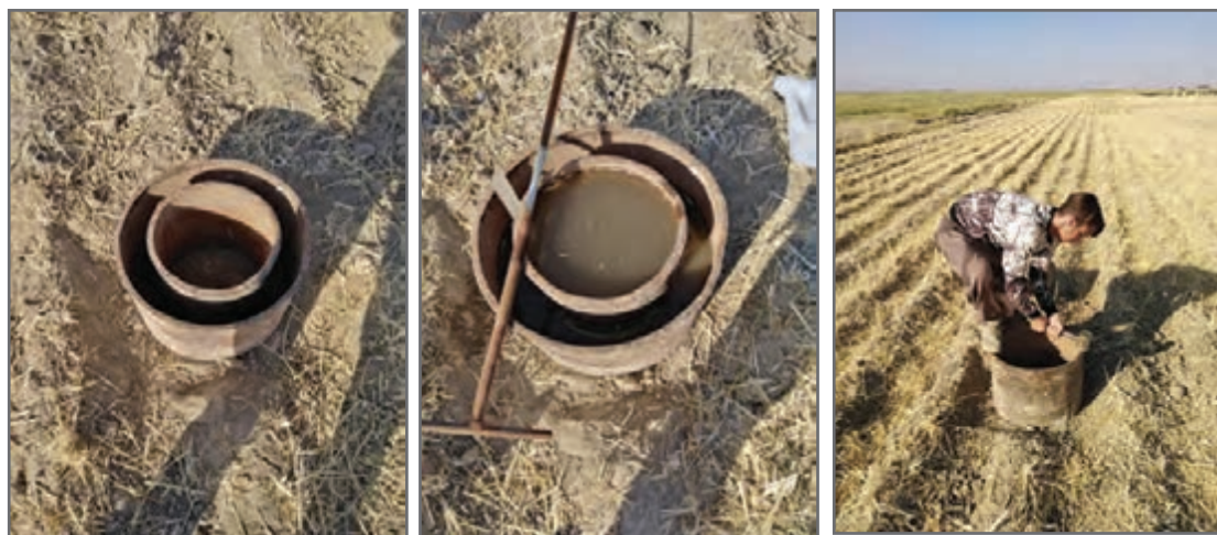
شکل ۲۹- نحوه کارگذاری استوانه مضاعف در مزرعه
