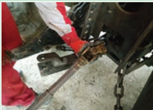
شکل ۳۰- اتصال گاردان به شافت P.T.O تراکتور
