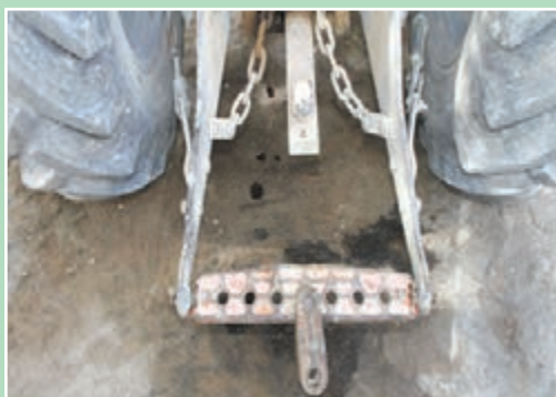
شکل ۲۹- مالبند بلند برای اتصال ماشین هموارکننده نیمه سوار
