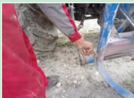
شکل ۲۸- اتصال کودپاش به بازوهای کناری تراکتور
