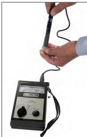
شکل ۴۱- اندازه‌گیری شوری عصاره خاک توسط دستگاه EC متر
