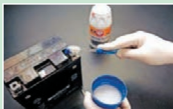
شکل ۱۷- شست و شوی قطب ها با جوش شیرین و آب گرم
