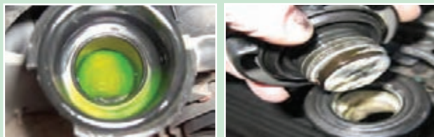
شکل ۱۰- بازدید آب رادیاتور
