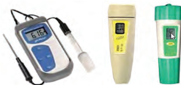
شکل ۳۴- دستگاه های اندازه گیری اسیدبته
