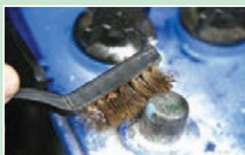
شکل ۱۶- تمیز کردن قطب ها با برس سیمی
