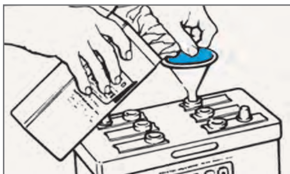
شکل ۲۱- اضافه کردن آب مقطر به سلول‌ها در صورت نیاز
