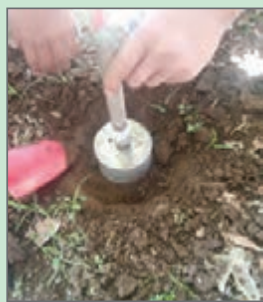
شکل ۲۴- نمونه برداری با کوبه و سیلندر
