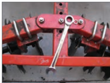
شکل ۱۴- تغییر زاویه استقرار ردیف بشقاب ها روی شاسی
