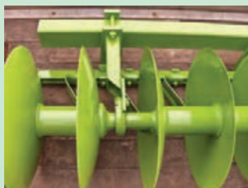
شکل ۱۱- اجزای محور دیسک
