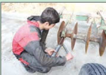
شکل ۱۲- گریس کاری دیسک
