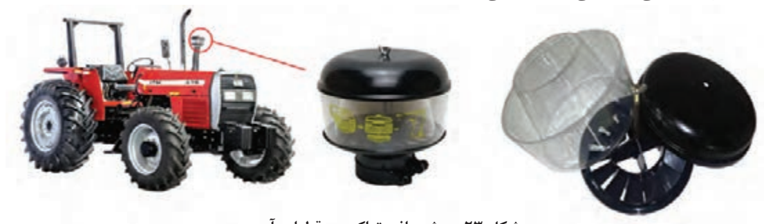
شکل ۲۳- پیش صافی تراکتور و قطعات آن
