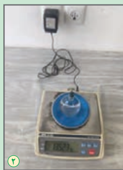
شکل ۲۶- وزن مخصوص حقیقی خاک به روش پیکنومتر
