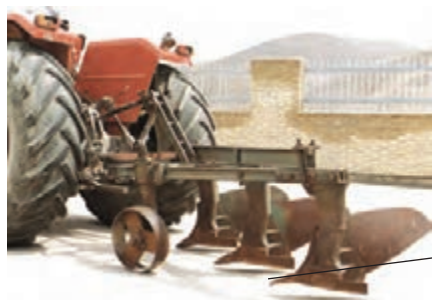
شکل ۶۵- تنظیم تراز عرضی گاواهن
