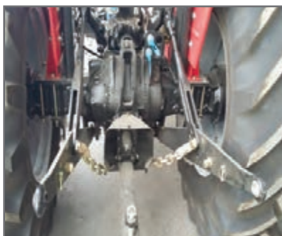
شکل ۶۶- زنجیر تنظیم تعادل یا نوسان گیر
