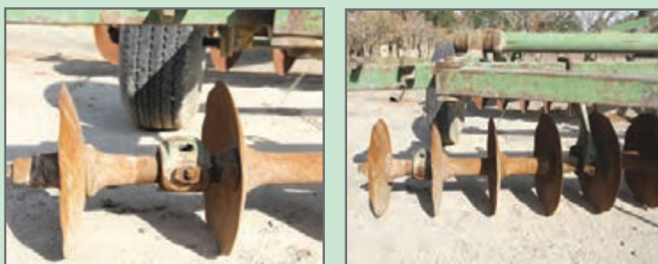
شکل ۱۰- یاتاقان خراب محور بشقاب
