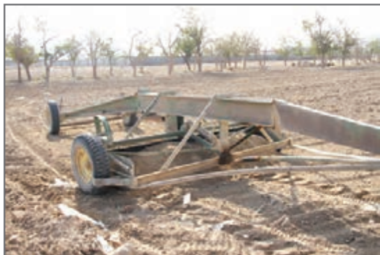
شکل ۲۲- انواع زمین صاف کن (لولر) نیمه سوار و کششی
