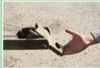
شکل ۲۶- شکستگی نقطه اتصال صاف‌کننده
