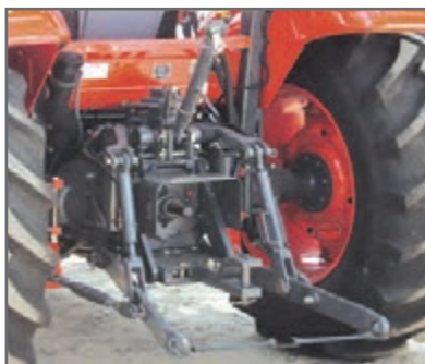
شکل ۶۶- زنجیر تنظیم تعادل یا نوسان گیر
