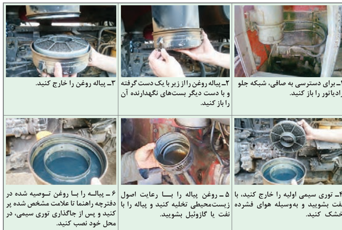
شکل ۲۸- مراحل سرویس صافی روغنی
