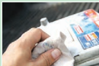
شکل ۱۸- پاک کردن قطب ها با دستمال نرم و خشک
