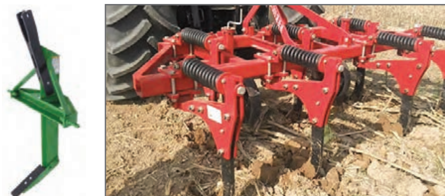
شکل ۴۶- گاوآهن‌های شکافنده [گاوآهن قلمی «چیزل» (سمت راست) و زیرشکن (سمت چپ)]
