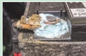
شکل ۱۵- سولفاته شدن قطب های باتری
