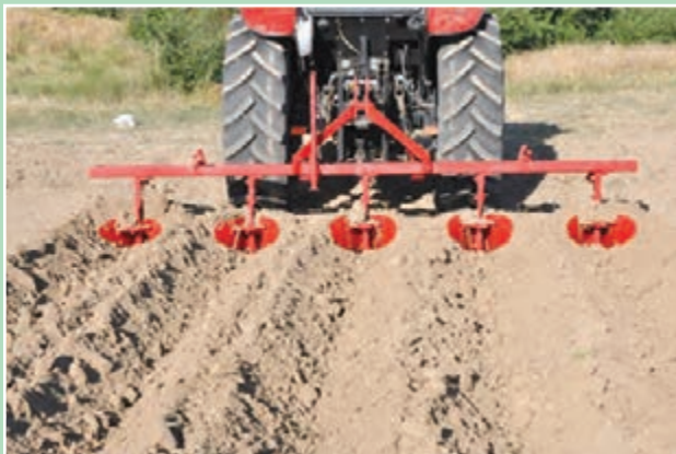
شکل ۴۵- شیارکش در حال ایجاد شیار
