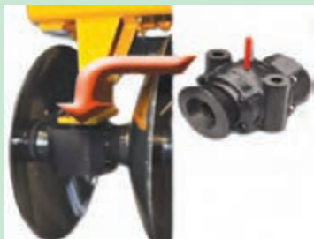
شکل ۱۱- اجزای محور دیسک
