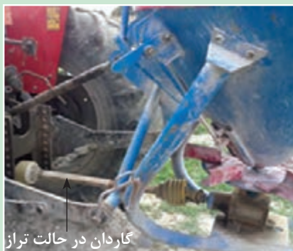
شکل ۳۴- نمایی از موازی بودن گاردان با سطح افق
