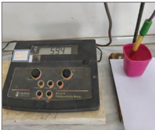
شکل ۴۳- تنظیم دستگاه هدایت سنج با محلول استاندارد
