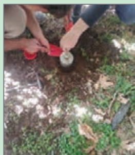
شکل ۲۴- نمونه برداری با کوبه و سیلندر
