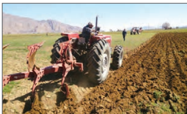
شکل ۶۹- اجرای شخم با گاوآهن برگردان دار دوطرفه
