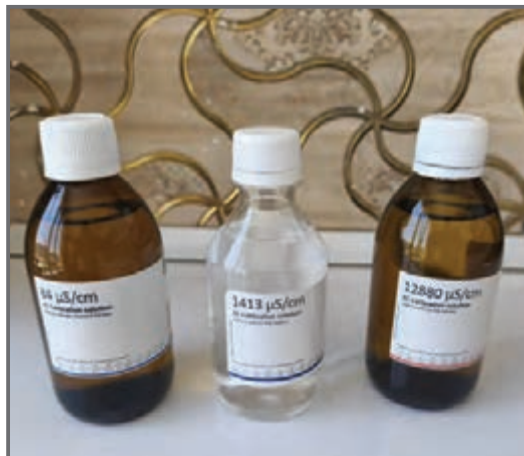
شکل ۴۲- محلول های استاندارد دستگاه هدایت سنج
