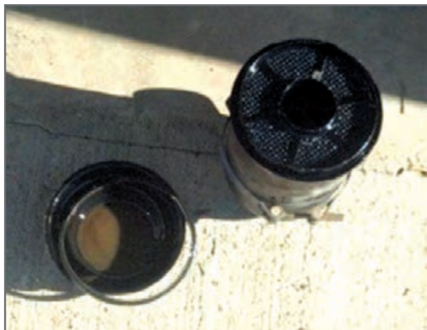
شکل ۲۹- توری سیمی ثانویه و پیاله روغن
