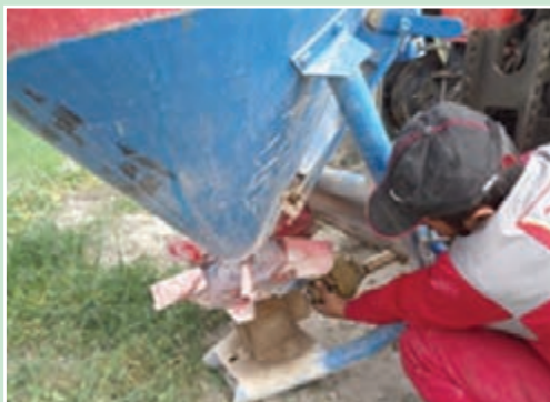
شکل ۲۹- اتصال گاردان به کودپاش
