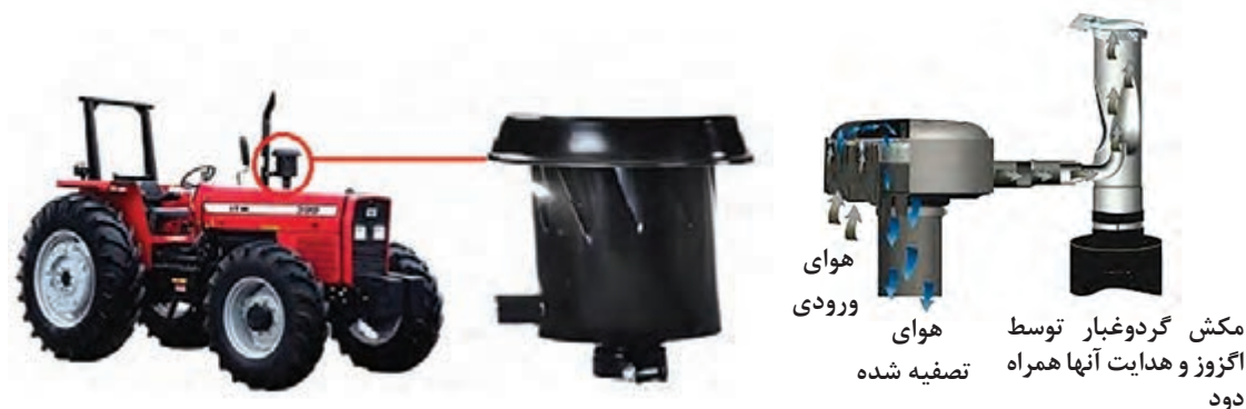
شکل ۲۶- پیش‌صافی بدون نیاز به مراقبت
