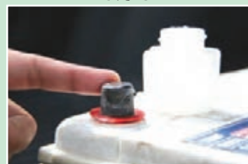
شکل ۱۹- مالیدن گریس به قطب ها
