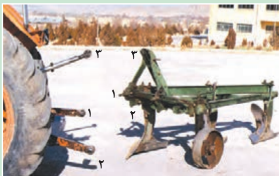
شکل ۶۴- اتصال گاوآهن به تراکتور
