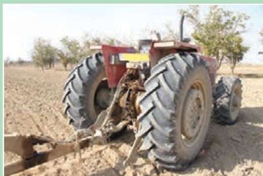
شکل ۳۰- نقطه اتصال در صاف کننده کششی
