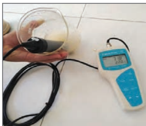
شکل ۳۵- اندازه گیری pH خاک به روش الکتریکی
