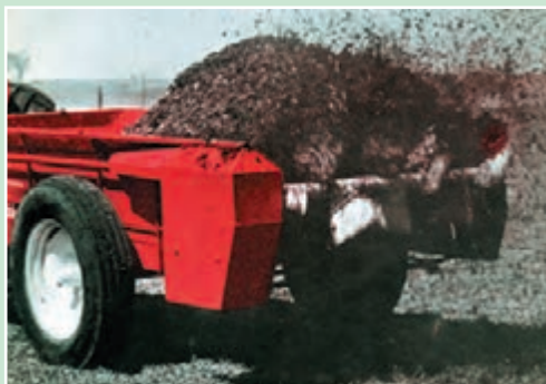
شکل ۲۵- پخش کود دامی توسط کودپاش مکانیزه (جامدپاش)
