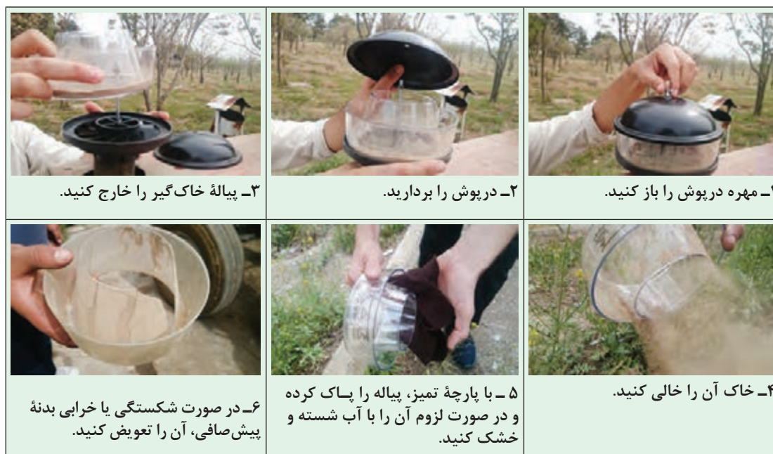
شکل ۲۵- تمیز کردن پیش‌صافی
