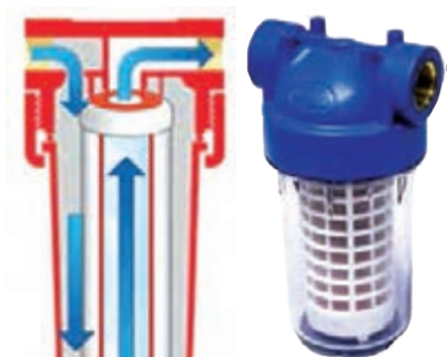
شکل ۱۸- مسیر جریان آب در ضد رسوب های پلی فسفات
