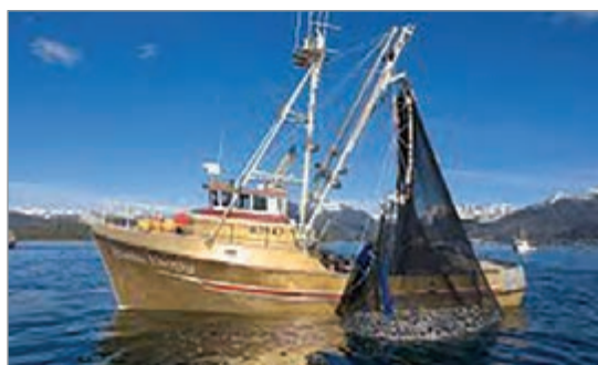
شکل ۶۳- خارج نمودن کامل تور گردان پباله‌ای از دریا و انتقال آن بر روی عرشه توسط کشتی پورس سینر
