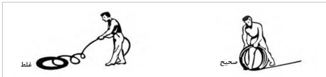
شکل ۱۸- اصول باز کردن حلقه طناب سیمی بدون قرقه
