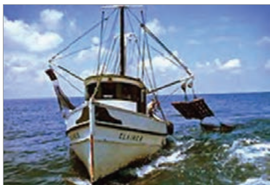
شکل ۵۲- کشتی صیادی ترال‌ردو بازویی در حین عملیات تور اندازی و موقعیت تورها در حین صید
