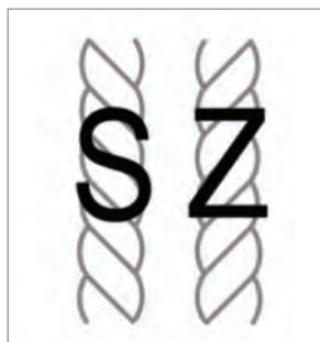
شکل ۲- جهت تاب در نخ‌های ماهیگیری و انواع طناب‌ها
