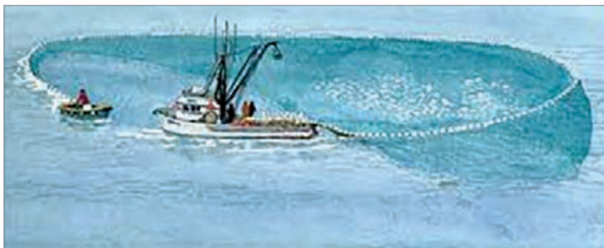
شکل ۶۴- نگهداری سر تور توسط قایق کمکی (اسکیف) در عملیات تور ریزی به روش پورس سینر
