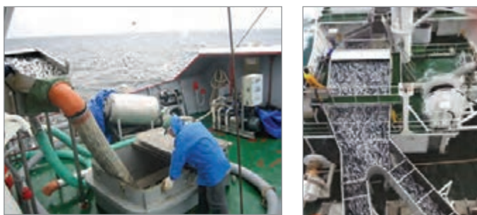
شکل ۱۵- جابه‌جایی ماهیان ریز با پمپ‌های مکند و نوار نقاله در شناورهای مجهز
