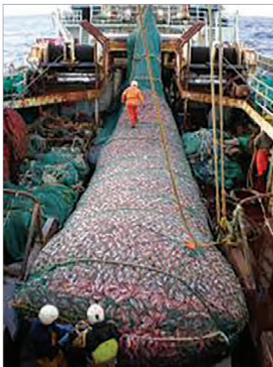
شکل ۵۱- خاتمه عملیات تورکشی و استقرار تور ترال بر روی عرشه در یک کشتی ترالر پاشنه کش
