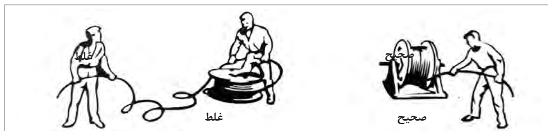
شکل ۱۹- اصول باز کردن حلقه طناب سیمی با قرقه
