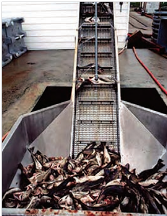
شکل ۱۶- کاربرد تسمه نقاله حمل ماهی در داخل شناور
