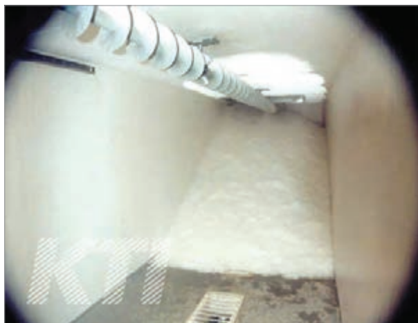
شکل ۱۸- یک نمونه دستگاه یخ ساز پودری در داخل شناور
