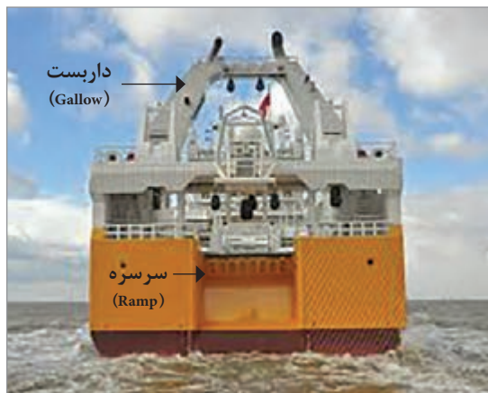
شکل ۵۰- تصویر یک کشتی ترالر پاشنه کش و موقعیت سرسره و داربست آن از سمت پاشنه
