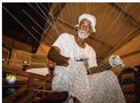
شکل ۷- ساخت قفس سیمی (گرگور) به دست گرگورباف‌های محلی در جنوب کشور
