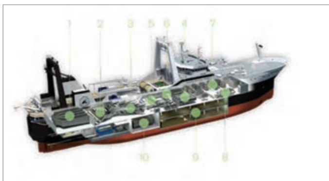
شکل ۳۰- یک شناور کامل صیادی مجهز به تأسیسات فراوری ماهی
