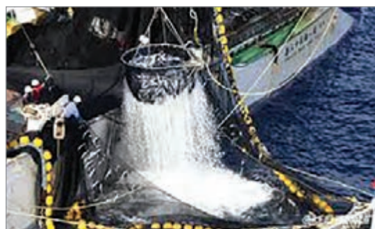
شکل ۶۲- تخلیه صید به وسیله تور ملاقه‌ای (عملیات بریلینگ) به منظور سبک کردن تور پیش از بالا کشیدن کامل آن
