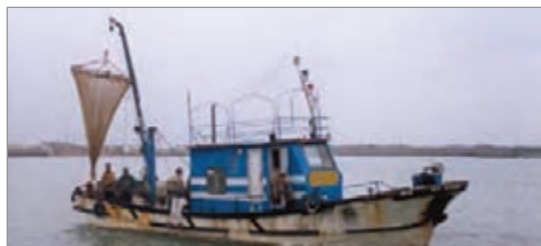
شکل ۴۱- شناورهای ماهیگیری مجهز به تور قیفی ویژه صید ماهی کیلکا در دریای خزر
