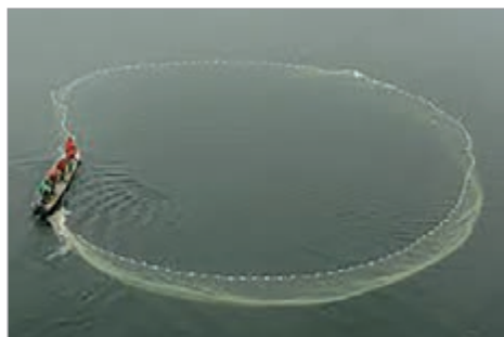
شکل ۵۵ - استقرار تور گردان پیاله‌ای به دور یک گله ماهی شناسایی شده توسط کشتی پورس سینر
