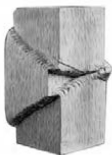
شکل ۲۶- شکست چوب در اثر نیروهای فشاری
