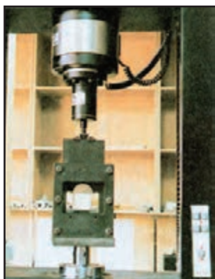
شکل ۲۸- طرز قرار گرفتن نمونه چوب در دستگاه آزمایش
