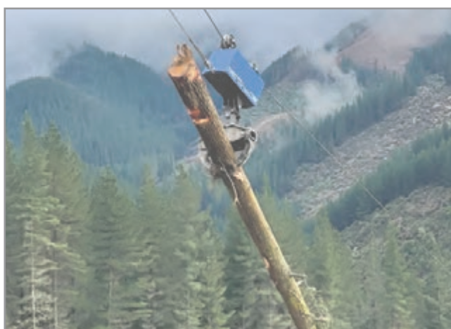
شکل ۳۵- سیستم کابلی حمل گرده بینه
