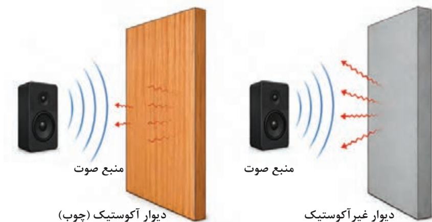
شکل ۱۴- مقایسه رفتار امواج صوتی در دیوار آکوستیک و دیوار غیر آکوستیک
