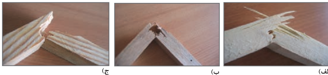
شکل ۲۱- نوع شکست چوب زبان گنجشک در اثر ضربه
