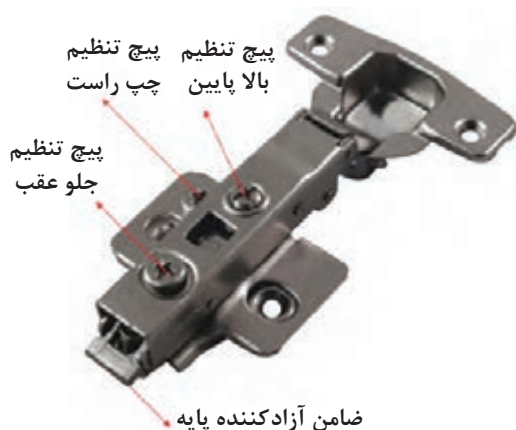
شکل ۲۲- پیچ‌های تنظیم لولای کابینت
