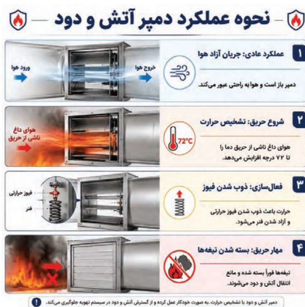
شکل ۲۸- کارکرد ترکیبی دمپر دود با آتش (فیوزی)
