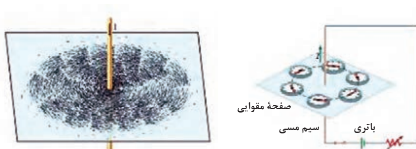
شکل ۱- میدان مغناطیسی حاصل از جریان الکتریکی
