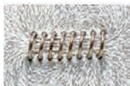
شکل ۴- میدان مغناطیسی اطراف سیم پیچ
