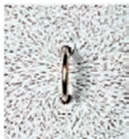
شکل ۳- میدان مغناطیسی اطراف حلقه حامل جریان
