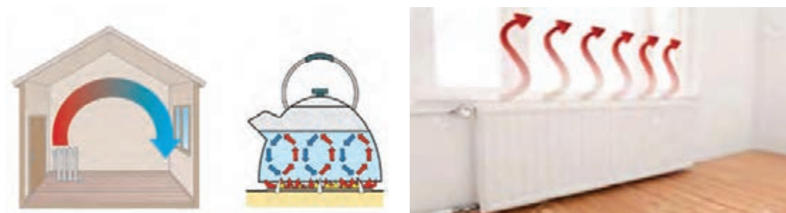
شکل ۲۲- انتقال گرما به روش وزش (همرفت، جابه جایی)
