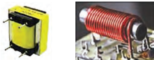
شکل ۵ - سیم پیچ با هسته آهنی
