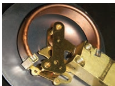
شکل ۳۲- قسمت داخلی فشارسنج بوردون
