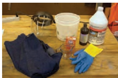
شکل ۲۱- استفاده از دستکش، ماسک و پیش‌بند موقع اسید کاری
