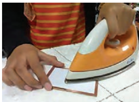
شکل ۲۵- انتقال طرح مدار چاپی به روی فیبر با اتو
