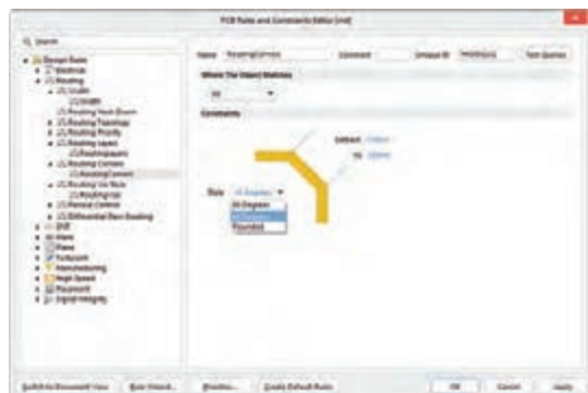
شکل ۵۲- تعیین زاویه چرخش مسیر مسی
