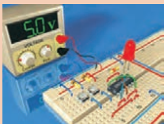
شکل ۱۳- بستن مدار روی بردبرد و آزمایش آن
