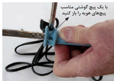
شکل ۱۱۲- چگونگی باز کردن هویه قلمی و اجزای آن
