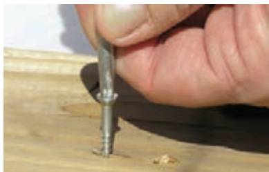
شکل ۸۰- انتخاب آچار مناسب مانع خرابی گل پیچ می‌شود
