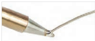
شکل ۳۵- اضافه کردن لحیم به نوک هویه
