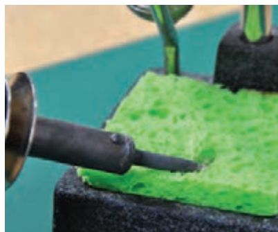
شکل ۳۶- تمیز کردن نوک هویه پس از قلع اندود شدن
