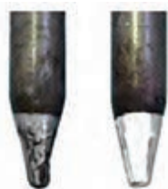
شکل ۳۲- نوک اکسید شده و قلع اندود شده
