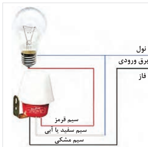
شکل ۱۷۸- نحوه سیم‌کشی فتوسل
