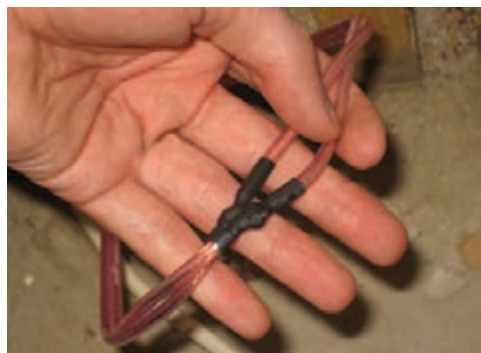
شکل ۵۷- اتصال سه تایی با روکش وارنیش حرارتی
