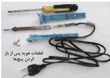
شکل ۱۱۲- چگونگی باز کردن هویه قلمی و اجزای آن
