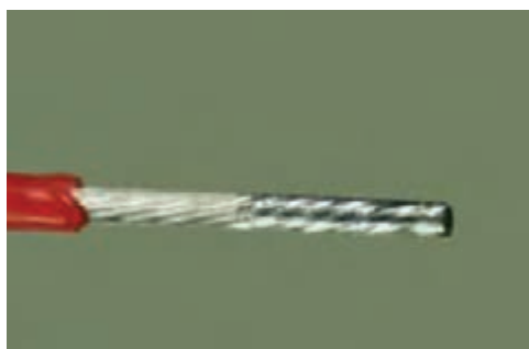
هـ) فقط قسمتی از سیم به طور صحیح قلع اندود شده است
