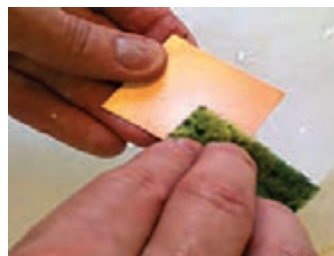
پ) شست و شو و تمیز کردن فیبر
