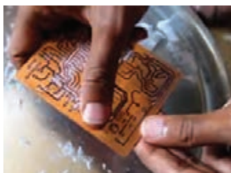
شکل ۲۰- جدا کردن کاغذ از سطح روی فیبر
