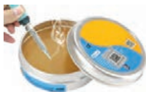
شکل ۳۳- فروبردن نوک هویه در روغن لحیم
