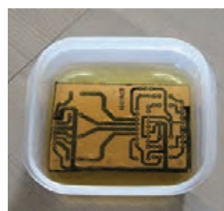
شکل ۲۳- اندازه سطح محلول اسید و آب ۲ میلی‌متر بالاتر از فیبر
