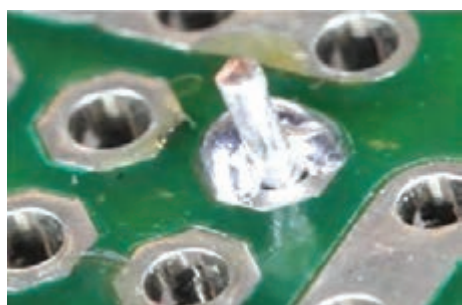
شکل ۱۰۸- جاری نشدن کافی لحیم
