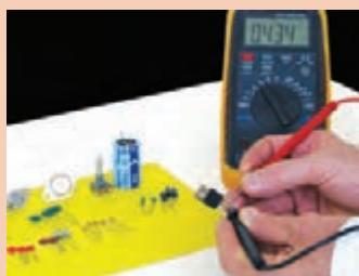
شکل ۱۲- اطمینان از سالم بودن قطعات
