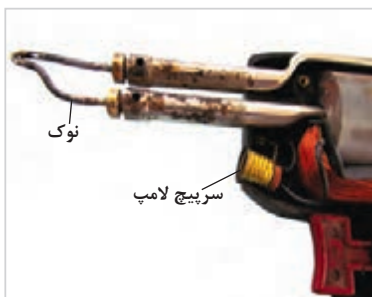
شکل ۱۱۴- چگونگی باز کردن هویه هفت تیری و اجزای آن
