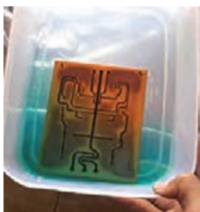
شکل ۲۵- تکان دادن محلول برای خورده شدن مس اضافی فیبر
