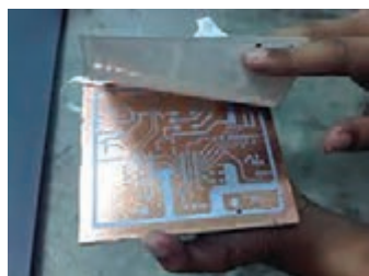
شکل ۲۰- جدا کردن کاغذ از سطح روی فیبر
