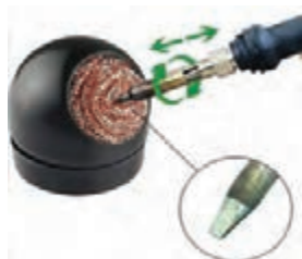
شکل ۳۴- تمیز کردن نوک هویه با اسفنج مخصوص
