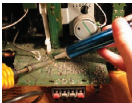
شکل ۶۶- مراحل ذوب شدن و مکش قلع
