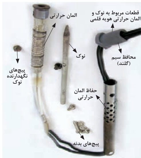
شکل ۱۱۳- مراقبت از اجزاء داخلی هویه قلمی
