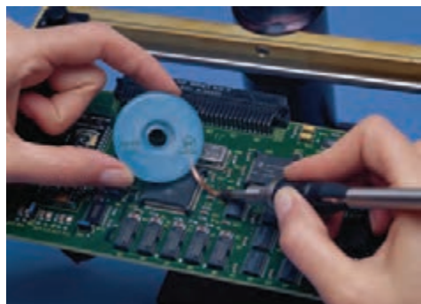
شکل ۶۳- برداشتن قطعات کوچک با فتیله لحیم
