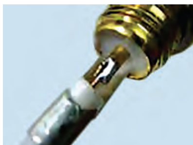
شکل ۹۲- اتصال کابل کوآکسیال به فیش آنتن
