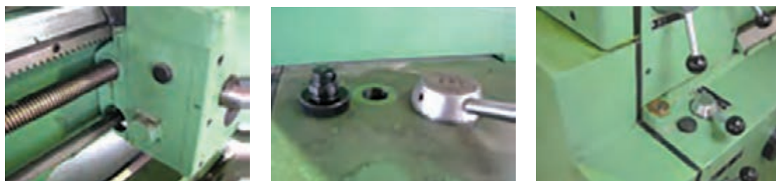
شکل ۶۵- ورودی روغن جعبه‌دنده اصلی - جعبه‌دنده پیشروی - قوطی سوپرت
