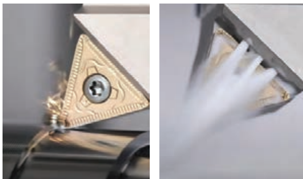
شکل ۱۰- رنده با الماس اینسرتی و کانال پاشش مایع خنک کاری (سمت راست در حال پاشش و سمت چپ بدون پاشش)
