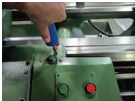
شکل ۴۲- روغن کاری با پمپ فشاری
