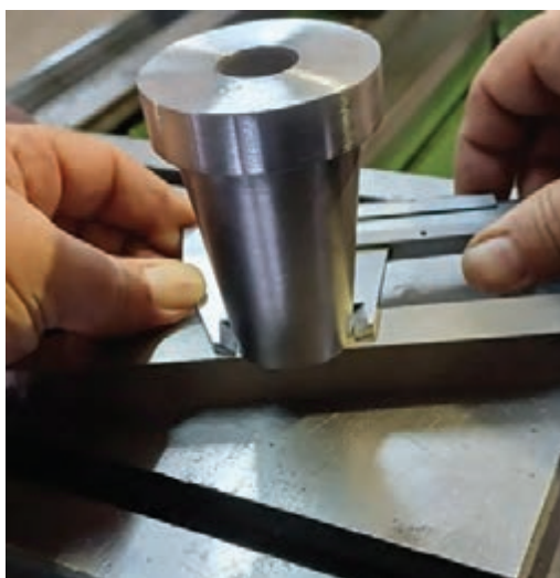
شکل ۱۴- استفاده از سطح کمکی برای اندازه‌گیری قطر کوچک مخروط
