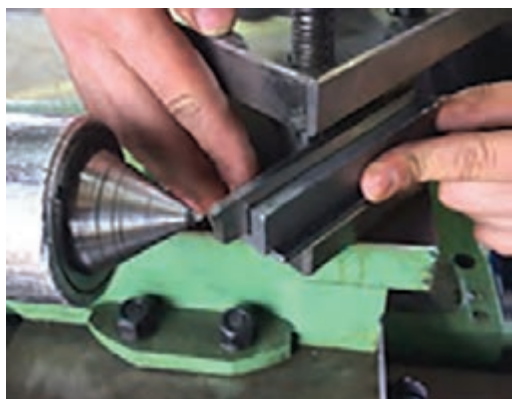
شکل ۱۰- نحوه بستن رنده شیار در قلم‌گیر
