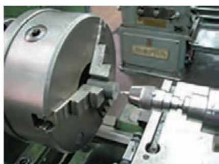
شکل ۲۳- تنظیمات مته مرغک جهت مماس نمودن مته مرغک
