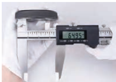
شکل ۳۷- اندازه‌گیری با استفاده از شاخک‌های داخل سنج کولیس دیجیتالی
