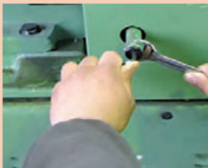
شکل ۷۰- باز کردن پیچ تخلیه روغن
