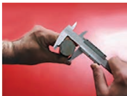
شکل ۱۹- اندازه‌گیری قطر قطعه‌کار به کمک کولیس
