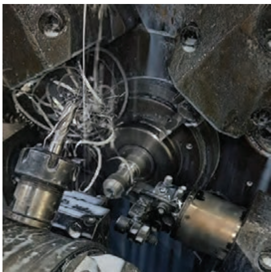
شکل ۱۳- عملیات سری تراشی به همراه برش کاری
