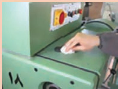
شکل ۶۶- پاک کردن اطراف درپوش روغن
