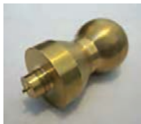
شکل ۱۷- قطعه آلیاژی از مس و روی (برنج)، برش کاری شده با دستگاه تراش
