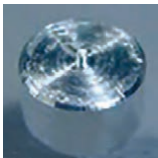
شکل ۲۰- زائده ایجاد شده در مرکز قطعه
