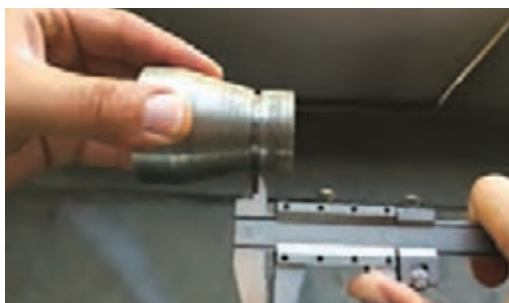
شکل ۹- اندازه گیری عرض شیار
