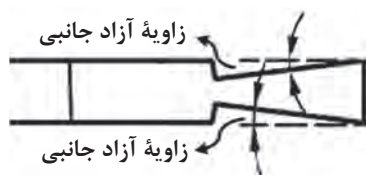
شکل ۷- زاویه آزاد جانبی (بغل)
