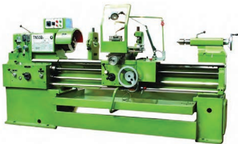
شکل ۱۶- جعبه دنده پیشروی، میله کشش، میله پیچ بری، جدول پیشروی
