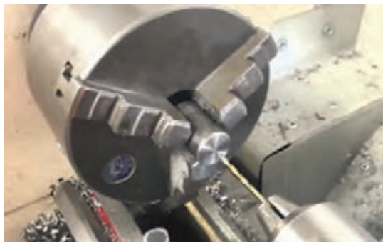
شکل ۳- شمایی از مته و قطعه کار بسته شده به سه نظام مرغک و دستگاه تراش
