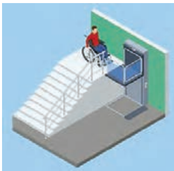
شکل ۳۷- بالابر برای تردد افراد دارای مشکلات حرکتی در بالا رفتن از پله
