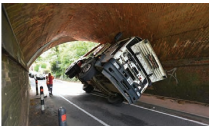
شکل ۵- برخورد کامیون با تونل به دلیل افزایش ارتفاع بار
