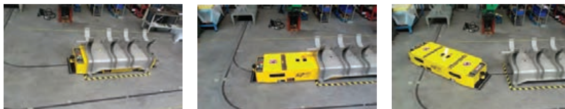
شکل ۲۹- مراحل حرکت ماشین اتوماتیک بر روی ریل
