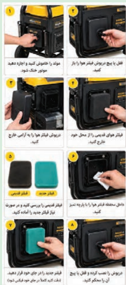
شکل ۲۸- مراحل تعویض فیلتر هوا
