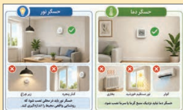
شکل ۱۲- تأثیر محل نصب بر عملکرد حسگرها
