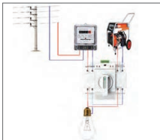
الف) برق شهری قطع و مولد خاموش است.
