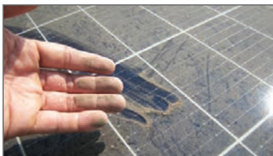
شکل ۲۱- تأثیر آلودگی روی پنل‌ها
