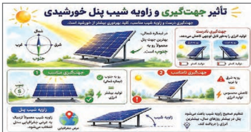
شکل ۱۵- تأثیر جهت و زاویه شیب پنل خورشیدی
