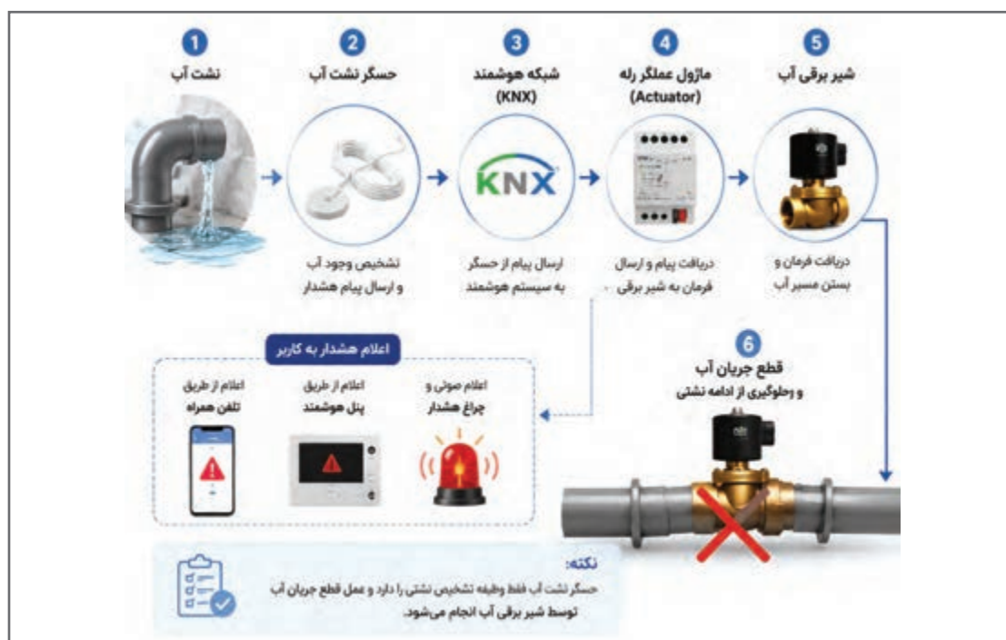
شکل ۱۹- مسیر عملکرد قطع آب هنگام نشتی
