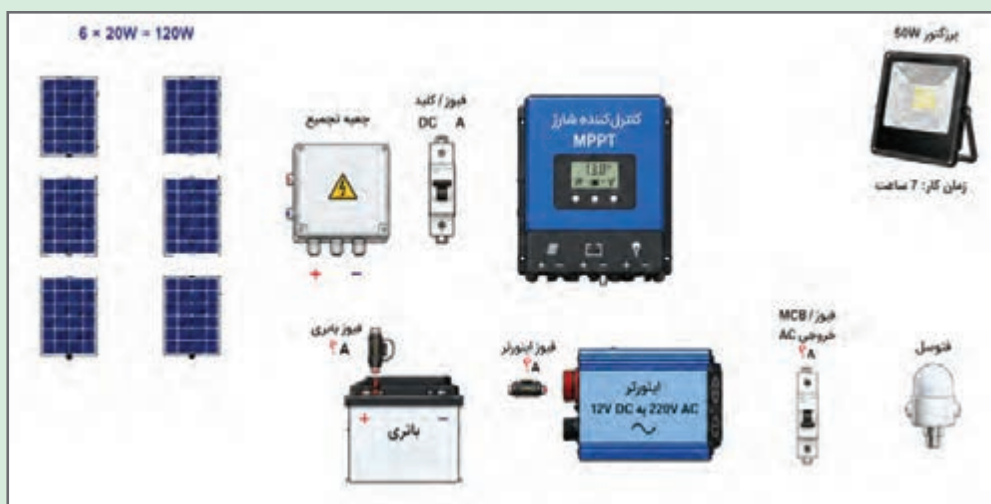
شکل ۳۰- نقشه خام سیستم مستقل از شبکه
