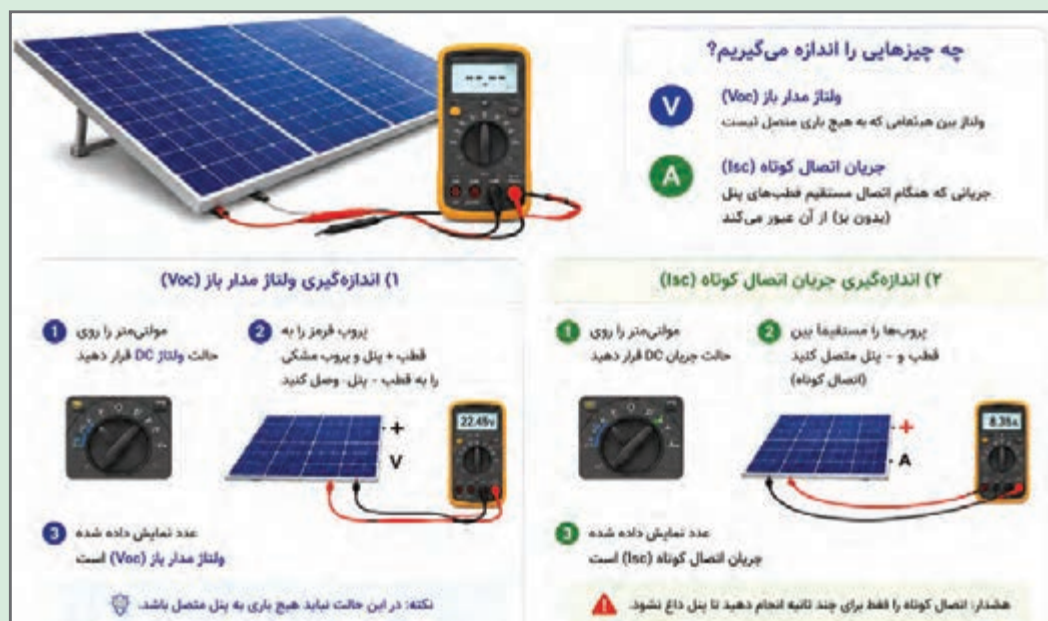
شکل ۱۳- اندازه‌گیری‌های ولتاژ و جریان پنل
