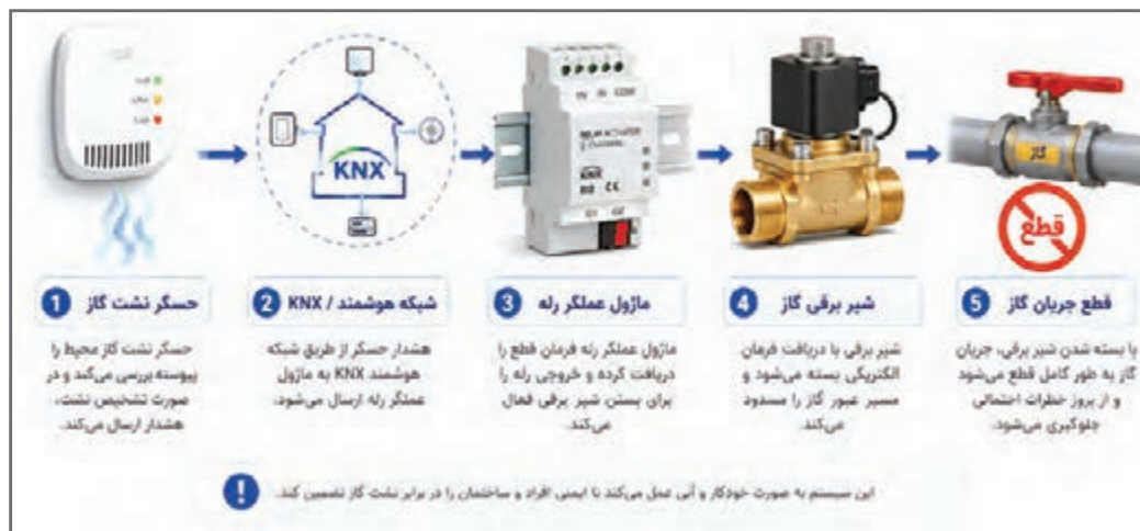
شکل ۱۶- مسیر عملکردی حسگر گاز
