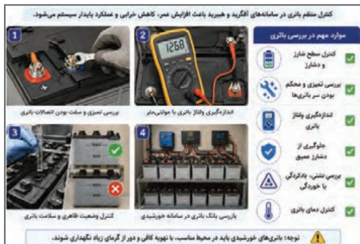
شکل ۴۴- بررسی و کنترل باتری
