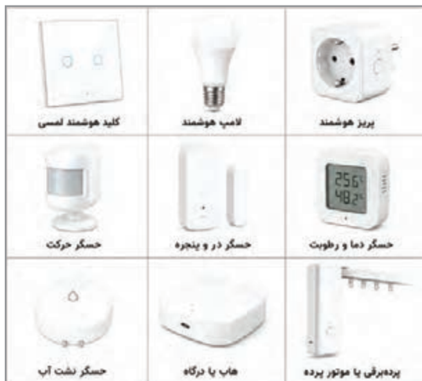
شکل ۴۱- تعدادی از تجهیزات Zigbee
