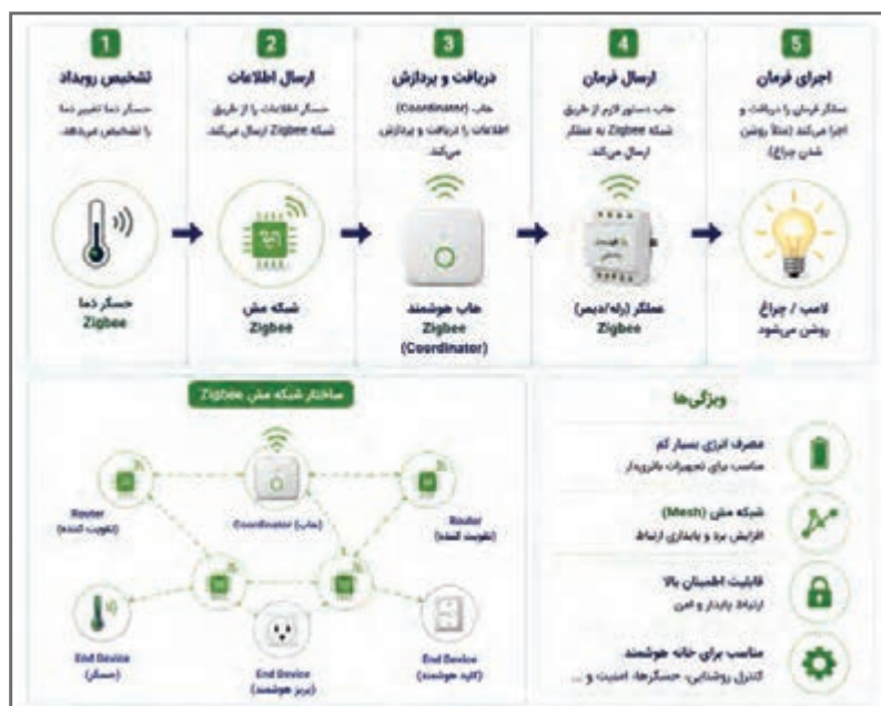
شکل ۳۹- مسیر عملکردی پروتکل Zigbee
