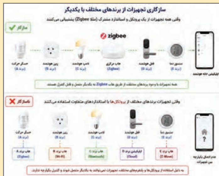
شکل ۴۰- سازگاری و عدم سازگاری تجهیزات مختلف در پروتکل‌های متفاوت
