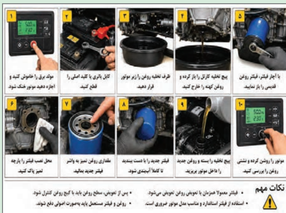
شکل ۳۱- مراحل تعویض فیلتر روغن
