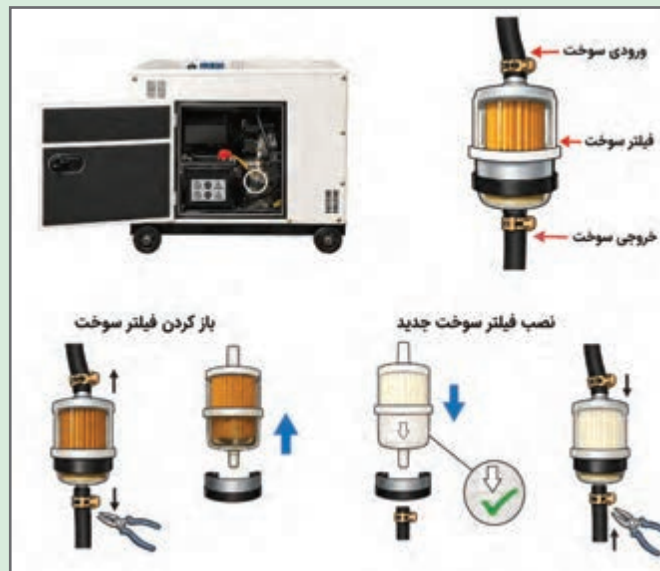
شکل ۲۹- مراحل تعویض فیلتر سوخت
