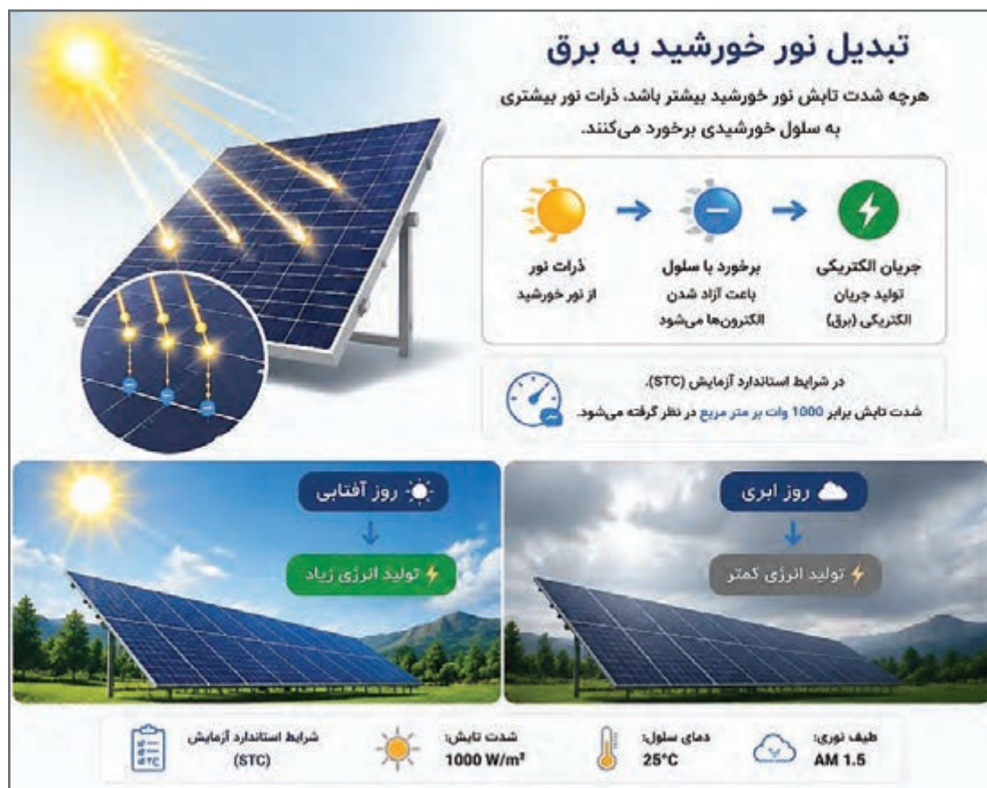
شکل ۱۰- فرایند تبدیل نور خورشید به انرژی الکتریکی
