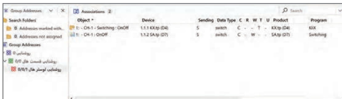
شکل ۴۴- تنظیم کانال تجهیزات و فضای روشنایی موردنظر
