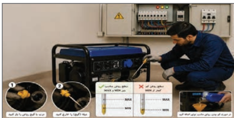
شکل ۸ - چک کردن روغن موتور و بررسی سطح روغن
