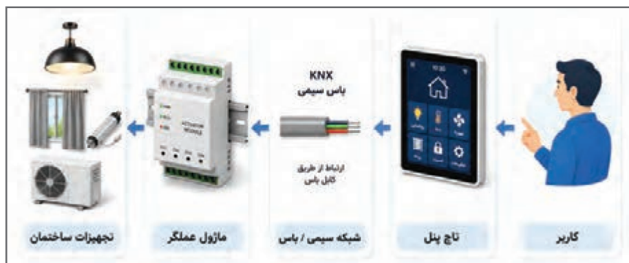
شکل ۵- ارتباط بین تاج پنل و تجهیزات
