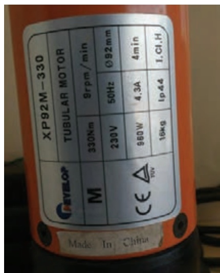
شکل ۲۸- قطر موتور درون نصب برابر ۹۲ میلی متر است.
