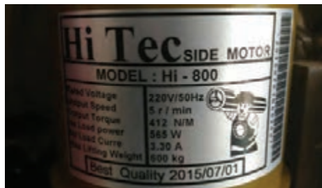
شکل ۲۷- موتور در کرکره‌ای از نوع سایید با ولتاژ
