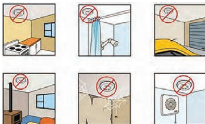
شکل ۵۴- محل‌های نامناسب نصب دتکتور
