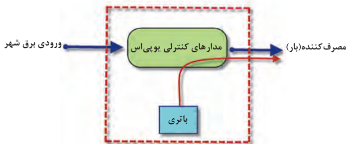
شکل ۲۷- مدار کنترلی یو پی اس
