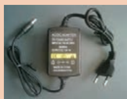
تغذیه یک یا چند دوربین (منبع تغذیه ۱۲V، ۱A)
