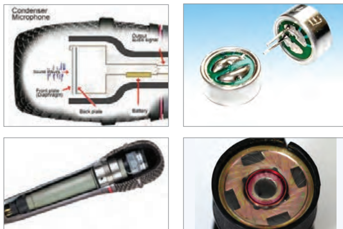
شکل ۱۰۴- میکروفون خازنی و دینامیکی
