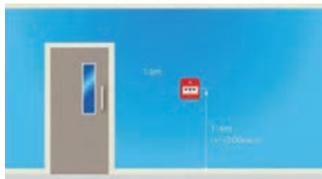
شکل ۲۱- محل و ارتفاع نصب شستہ
