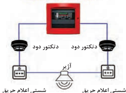
سیستم اعلام حریق آدرس پذیر
