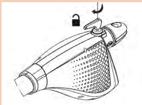
شکل ۱۲- وضعیت خلاص بازو در حالت قطع برق
