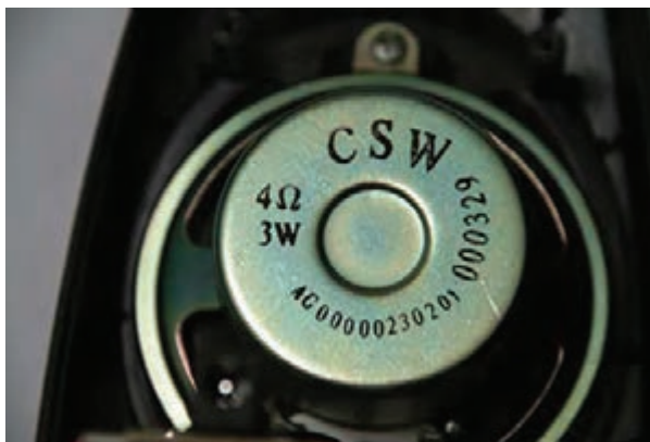
شکل ۸۶- توان بلندگو و امپدانس
