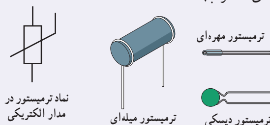
(الف) طرحی از چند ترمیستور و نماد آن در مدارهای الکتریکی
