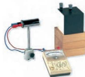
شکل ۴-۳۴ درون مکعب لسلی، آب داغ می‌ریزند. تابش گرمایی از چهار وجه مکعب که رنگ‌های متفاوتی دارند، با هم فرق دارد.
