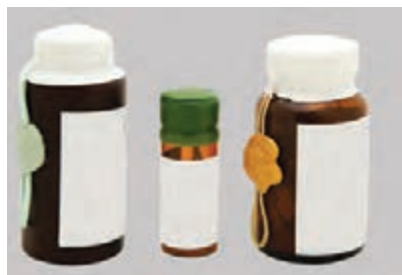
شکل ۵۵- نگهداری زهر مایع و خشک در شیشه تیره
