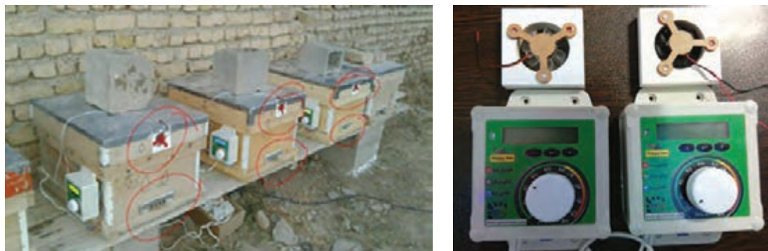
شکل ۲۷- کندوهای مجهز به سیستم کنترل کننده دما و رطوبت
