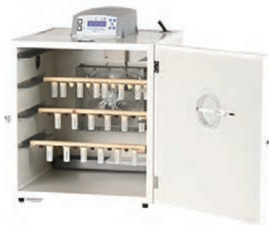
شکل ۱۱- انکوباتور مخصوص نگهداری سلول‌های کامل شده ملکه
