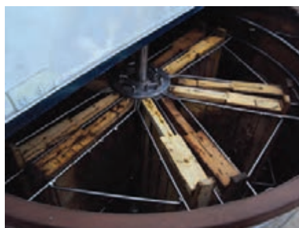
شکل ۱۲- دستگاه اکستراکتور شعاعی و تماسی
