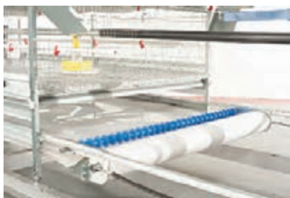
شکل ۱۶- جمع‌آوری کود با استفاده از نوار نقاله
