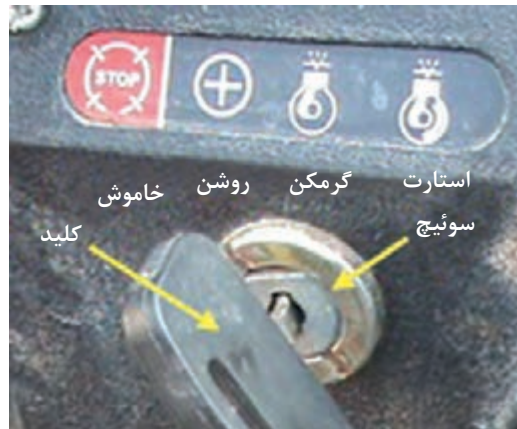
شکل ۷۰- وضعیت های مختلف سوئیچ استارت
