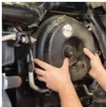
۲) بست یا مهره نگهدارنده درپوش صافی را باز کرده و درپوش را بردارید.
