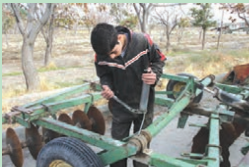
شکل ۲۰- گریس کاری دیسک
