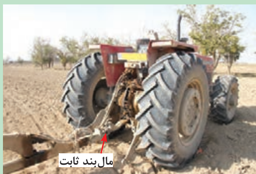
شکل ۴۹- نقطهٔ اتصال در صاف کننده کششی
