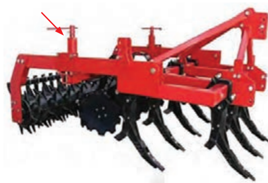
شکل ۳۰- تنظیم دامنه حرکت غلتک در جهت عمودی با استفاده از پیچ تنظیم
