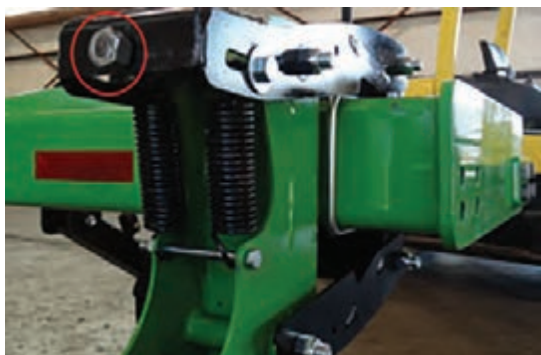
شکل ۶۴- پیچ تنظیم فشار فنر
