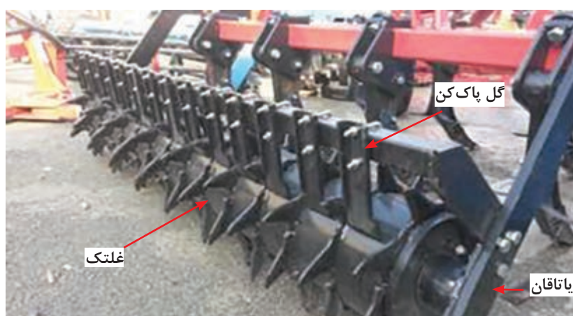
شکل ۲۶- غلتک خاک‌ورز مرکب و ضامم آن
