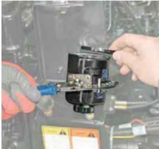
شکل ۲۵- فیلتر گازوئیل تراکتور ITM800 و نحوه باز کردن آن
