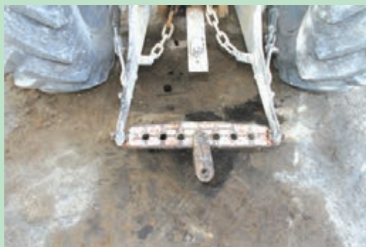
شکل ۲۸- مال بند بلند و اتصال سه نقطه
