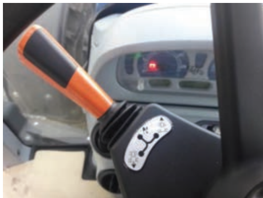
شکل ۷۵- اهرم تعیین وضعیت حرکت تراکتور نیوهلند T6090
