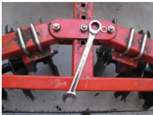
شکل ۲۷- تغییر زاویه استقرار ردیف بشقاب‌ها روی شاسی
