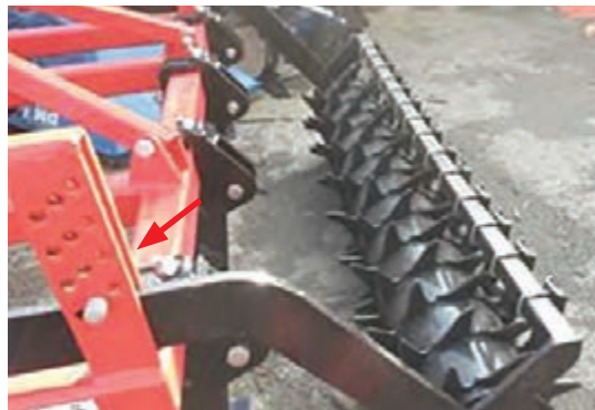
شکل ۲۹- تنظیم دامنه حرکت غلتک در جهت عمودی با استفاده از پین
