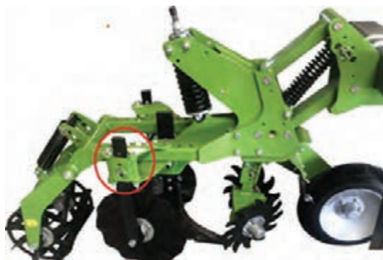
شکل ۶۷- تنظیم ارتفاع بشقاب‌ها
