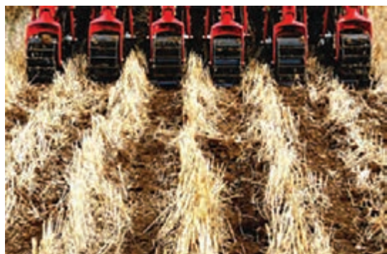
شکل ۳۳- اجرای عملیات خاک‌ورزی نواری
