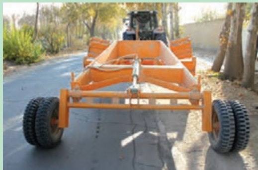
شکل ۵۱- تنظیم وضعیت چرخ‌ها به روش مکانیکی
