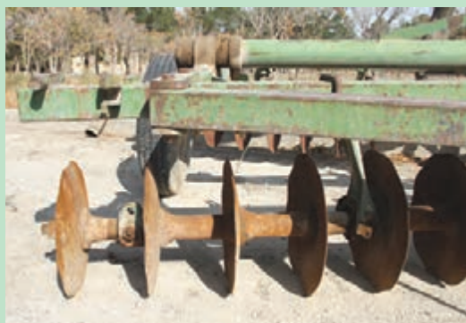
شکل ۱۸- یاتاقان خراب بشقاب
