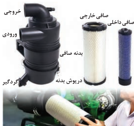
شکل ۱۹- صافی خشک و اجزای آن
