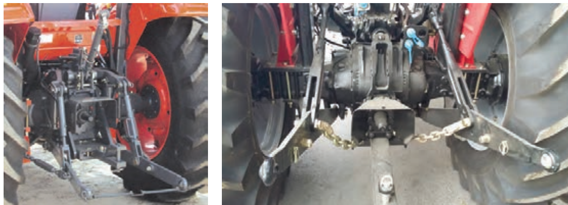
شکل ۴۷- زنجیر تنظیم تعادل یا نوسان‌گیر
