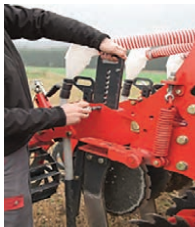
شکل ۶۶- تنظیم ساق زیر شکن با حرکت در جهت عمودی
