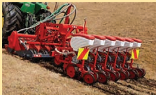
شکل ۳۸- خاک‌ورزی نواری به همراه کارنده ردیفی
