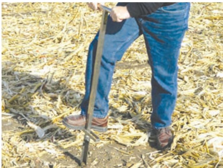
شکل ۹- برداشت نمونه خاک با اُگر
