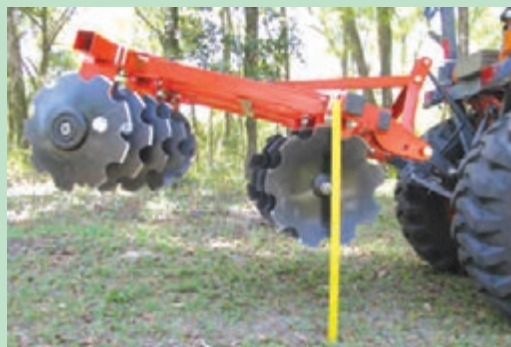
شکل ۲۸- مال بند بلند و اتصال سه نقطه
