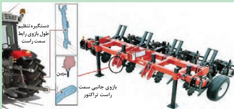
شکل ۵۲- اتصال بازوی جانبی سمت راست تراکتور به نقاط اتصال سمت راست ماشین
