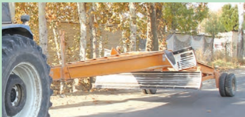
شکل ۵۲- زمین‌صاف‌کن در وضعیت جابه‌جایی
