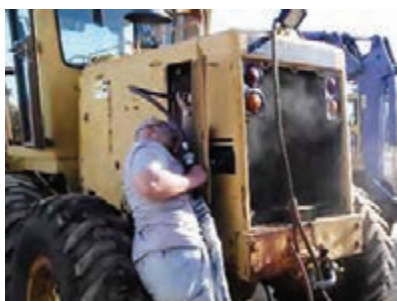
شکل ۳۵- تمیز کردن پره‌های رادیاتور
