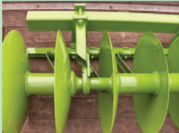
شکل ۱۹- اجزای محور دیسک
