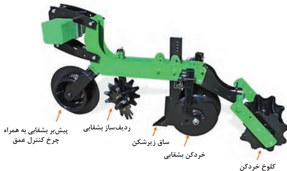
شکل ۳۵- یک واحد ماشین خاک‌ورزی نواری با پیش‌بر شیاری
