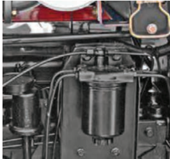
شکل ۲۵- فیلتر گازوئیل تراکتور ITM800 و نحوه باز کردن آن
