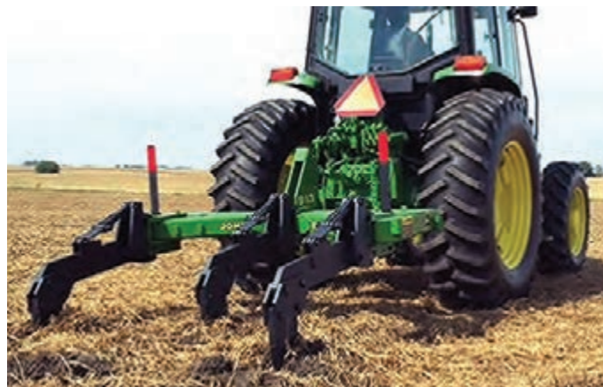
شکل ۳۲- استفاده از ریپر برای شکستن لایه‌های سخت خاک
