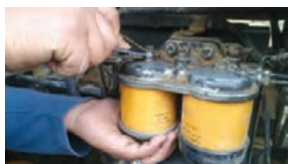
۲- یک دست را زیر فیلتر گرفته و با دست دیگر پیچ فیلتر را باز کنید.
