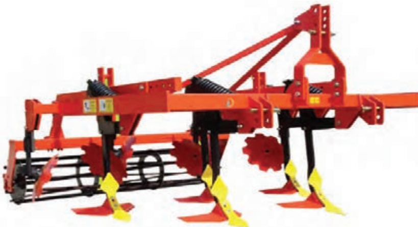
شکل ۱۹- خاک‌ورز مرکب با کلوخ خردکن دیسکی و غلتک قفسی
