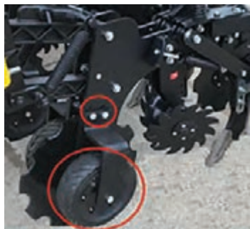
ج) تنظیم پیش‌بر با چرخ‌های تنظیم عمق اختصاصی
