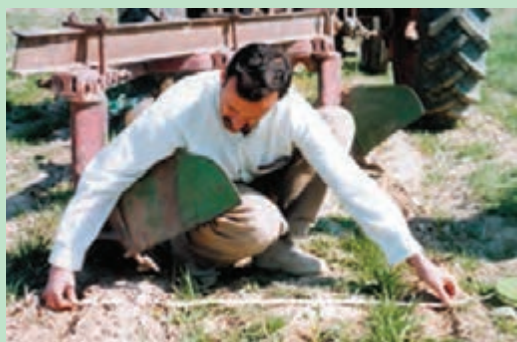
شکل ۵۲- اندازه‌گیری عرض کار گاواهن برگردان دار
