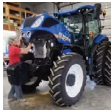
۱) شبکه‌های جلو یا بغل را برای دسترسی به صافی باز کنید.
