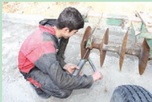
شکل ۲۰- گریس کاری دیسک
