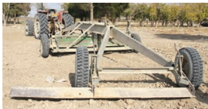
شکل ۴۱- صفحه متحرک در انتهای لولر برای تکمیل تسطیح
