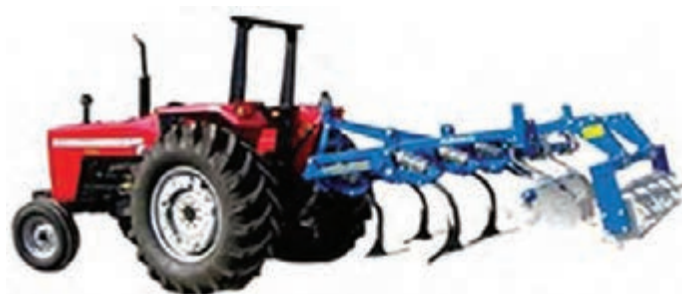
شکل ۲۸- اتصال خاک‌ورز مرکب سوار به تراکتور
