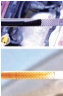
شکل ۳۸- کنترل سطح و رنگ روغن
