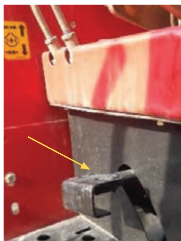
شکل ۵۲- پدال قفل دیفرانسیل
