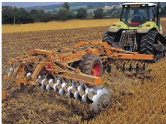
شکل ۱۶- اجرای کم خاک ورزی تمام سطح به وسیله دیسک
