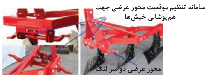
شکل ۴۸- تنظیم هم‌پوشانی (عرض کار) در گاوآهن
