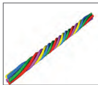
نحوه تابیدن الیاف به دور یکدیگر
