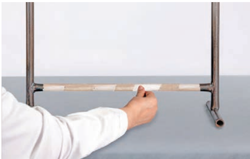
چسباندن کاغذ بی خط بر سطح زیردار شکل ۱۶ ◀
