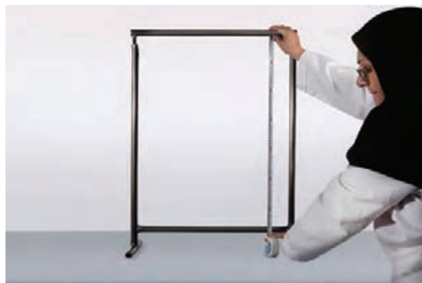
▲ شکل ۹ اندازه‌گیری فاصله داخلی سمت راست دار
