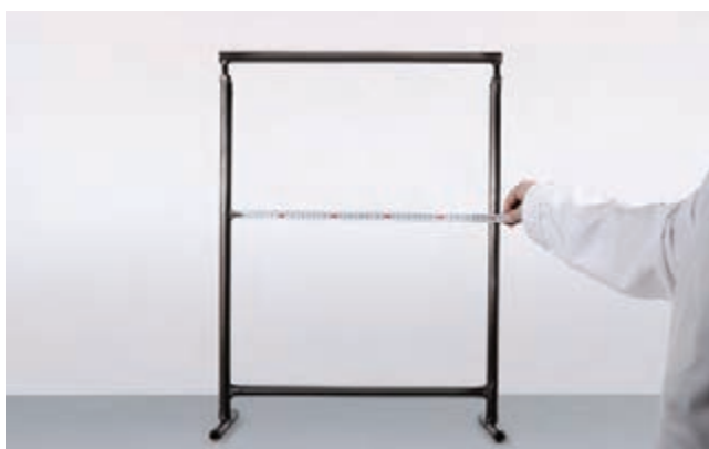
▲ شکل ۷ اندازه‌گیری فاصله نقاط میانی راست‌روها
