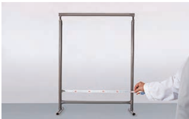
▲ شکل ۶ اندازه‌گیری فاصله دو سر پایینی راست‌روها
