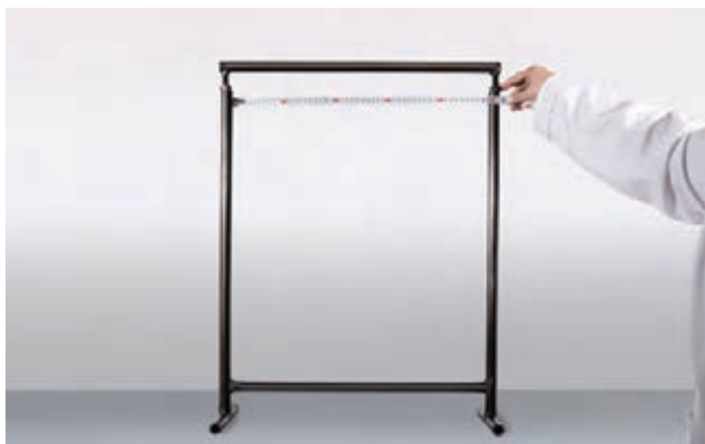
▲ شکل ۵ اندازه‌گیری فاصله دو سر بالای راست‌روها
