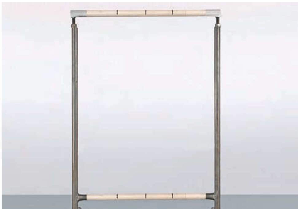
▲ شکل ۲۱ علامت گذاری فاصله های ده سانتی متری روی سر دار و زیر دار
