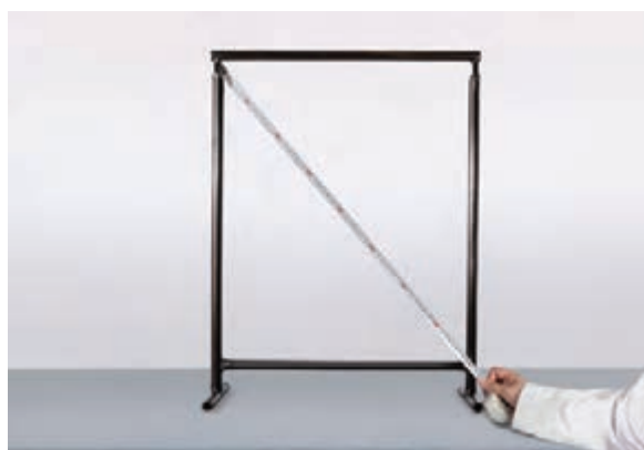
▲ شکل ۱۲ اندازه‌گیری قطرها
