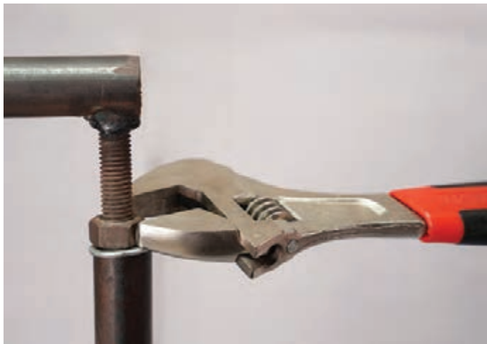
▲ شکل ۲۴ سفت کردن مجدد پیچ‌های سردار
