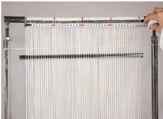
▲ شکل ۲۵ قراردادن دوباره هاف در محل خود
