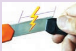
شکل ۶۱- خطر در شکستن تیغه و پرتاب شدن قطعات آن به طرف صورت انسان
