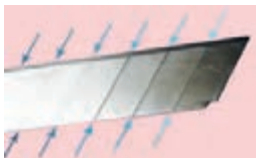
شکل ۵۶- شیارهای روی تیغه کاتر
