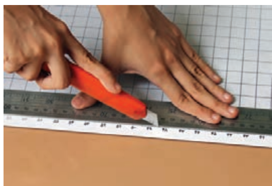
شکل ۸۸- روش برش لبه اضافی کاغذ با کاتر
