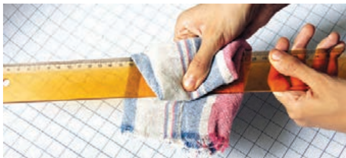
شکل ۶۲- تمیز کردن سطح خط‌کش با پارچه مرطوب
