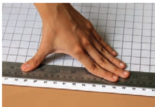
شکل ۸۷- روش مهار کردن خط کش فلزی با دست
