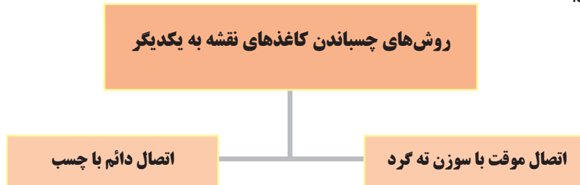
شکل ۷۹- نمودار روش‌های اتصال کاغذهای شطرنجی نقشه فرش به یکدیگر
