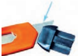
شکل ۵۸- روش شکستن تیغه کاتر با قطعه انتهایی دسته آن
