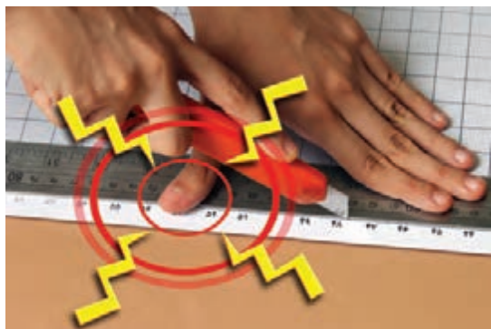
شکل ۹۰- روش خطرناک در نگه داشتن خط‌کش
