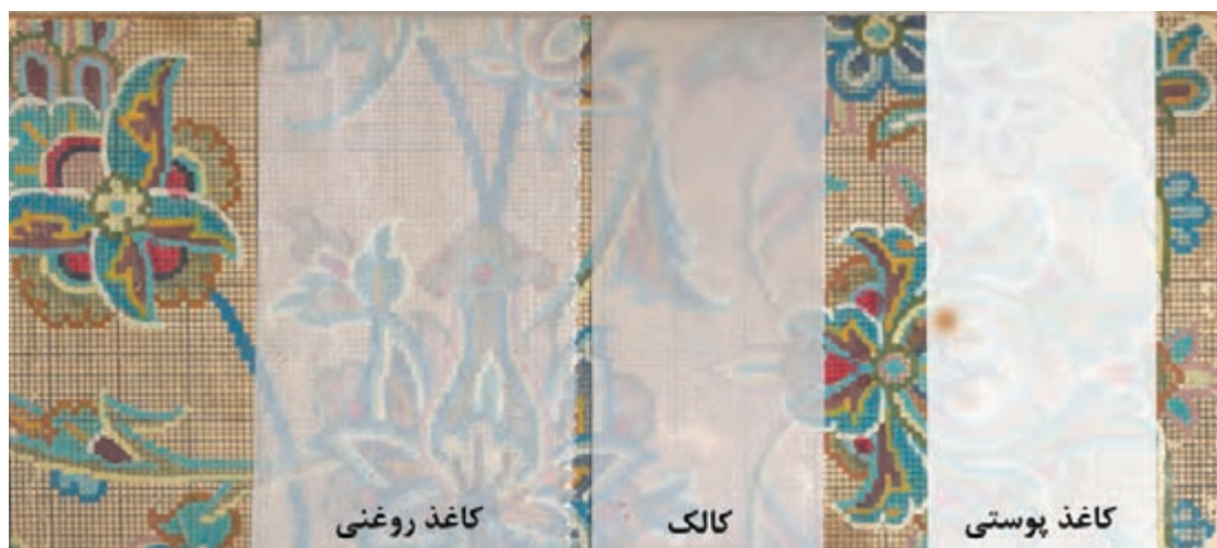
شکل ۹۸- مقایسه میزان شفافیت کاغذهای پوستی، کالک و روغنی نسبت به یکدیگر
