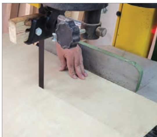
شکل ۳۶- برش تخته و ورق سه‌لایه طبق نقشه
