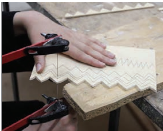
شکل ۲۰- برش خطوط زاویه دار کند
