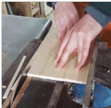
شکل ۱۸- برش و اندازه کردن صفحه
