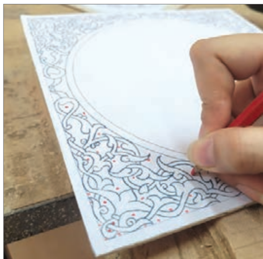
شکل ۴۷- مشخص کردن محل سوراخ کاری طرح
