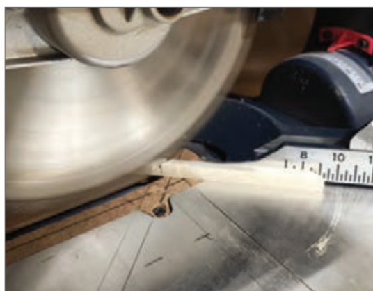
شکل ۱۳- برش فارسی زهوار با دستگاه فارسی بر
