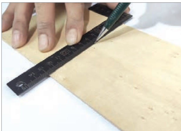
شکل ۱۷- انتقال اندازه‌ها روی ورق سه‌لایه و برش صفحات
