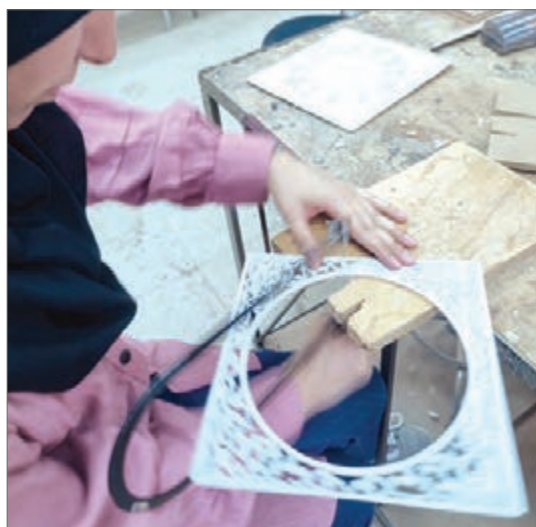
شکل ۵۰- برش نقوش منحنی کنترل و حرکت قطعه
