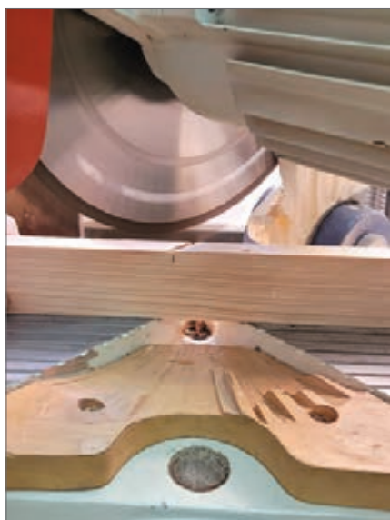
شکل ۳۴- برش زاویه فارسی چپ و راست قطعات
