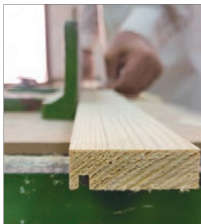
شکل ۳۰- ایجاد شیار شیشه
