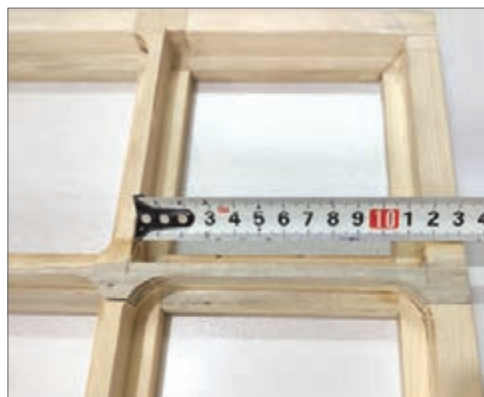
شکل ۱۲- اندازه‌گیری طول نهایی زهوار از روی دوراهه کلاف
