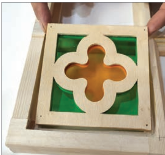
شکل ۲۵- قرار دادن صفحه پارچه‌بری در دوراهه قاب
