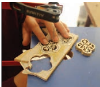
شکل ۵۷- دوربری قطعه زیور
