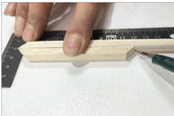
شکل ۱۲- اندازه‌گیری طول نهایی زهوار از روی دوراهه کلاف
