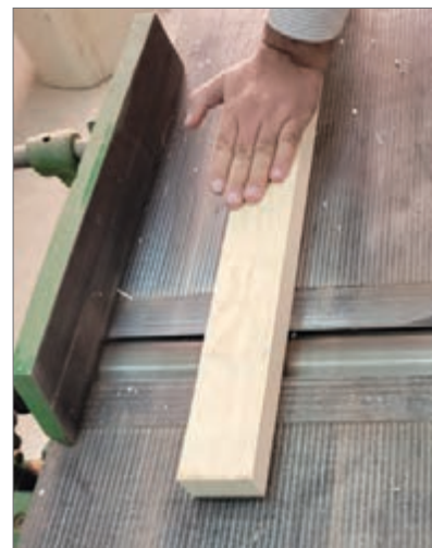
شکل ۲۳- اجرای کف رند بر سطح چوب
