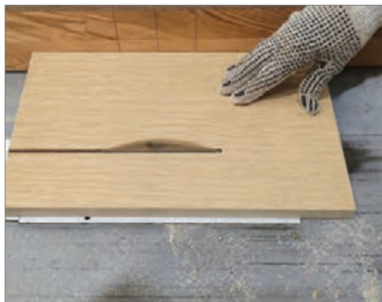
شکل ۱۵- برش صفحه نگهدارنده
