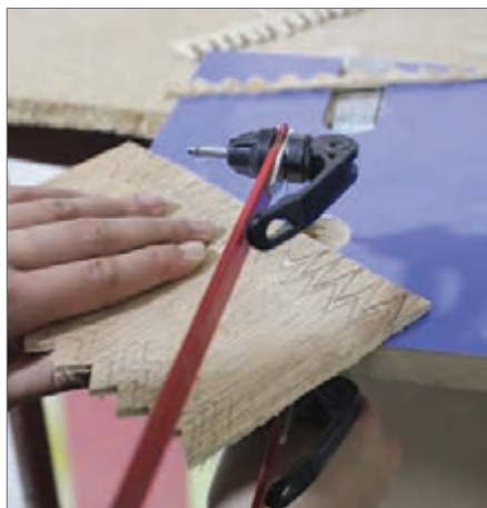
شکل ۲۱- برش خطوط زاویه دار تند
