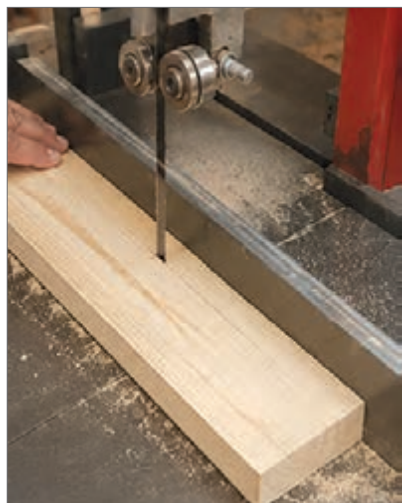
شکل ۲۴- برش اولیه قطعه از الوار با اره فلکه
