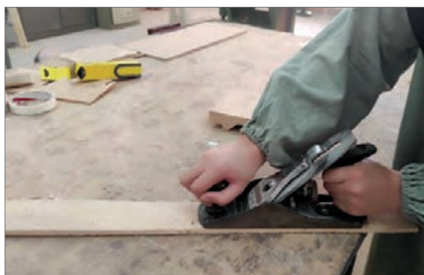
شکل ۴۸- رنده کردن سطح چوب با رنده دستی
