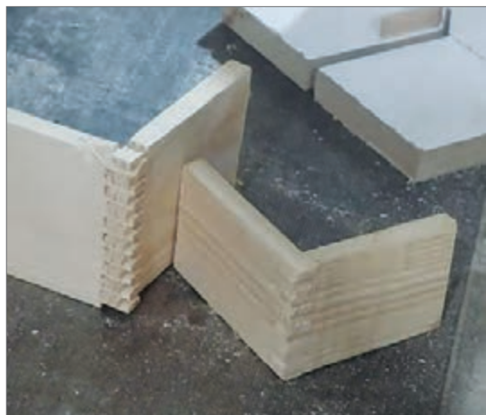
شکل ۲۲- نمونه صحیح برش اتصال
