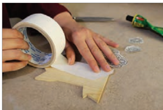
شکل ۵۰- پوشاندن سطح چوب با چسب کاغذی
