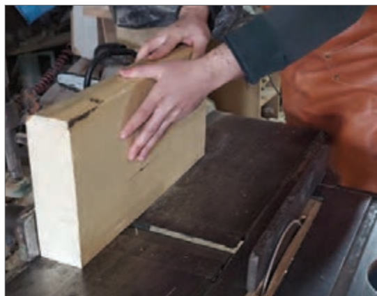
شکل ۶- رنده کردن کنار یا نر کار
