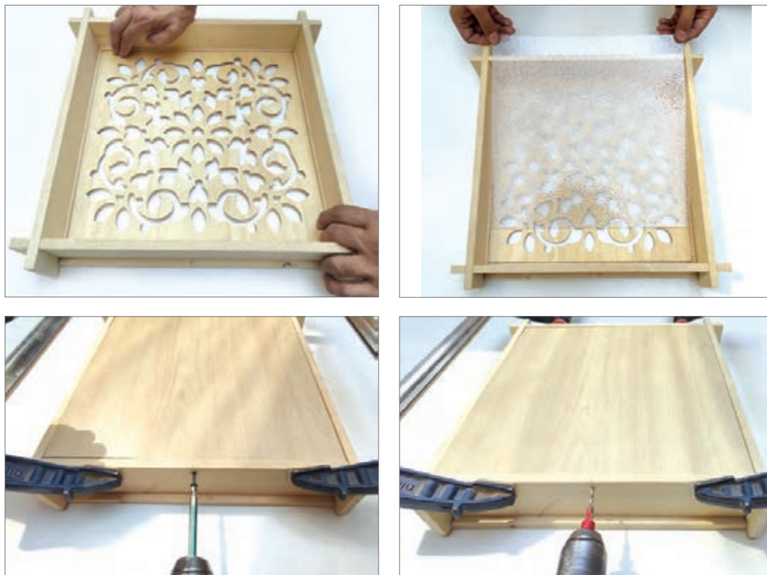
شکل ۱۸- مراحل نصب صفحات
