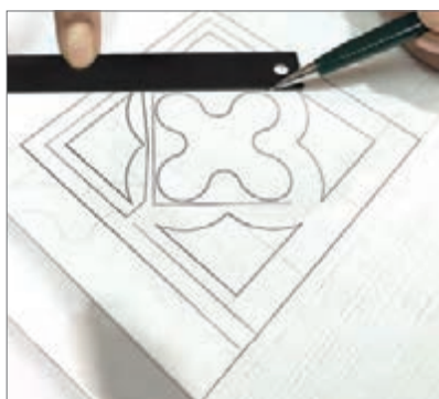
شکل ۲۲- استخراج الگوی برش شیشه از روی طرح پارچه‌بری
