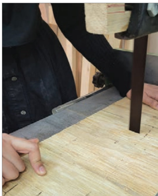
شکل ۳۷- برش تخته سه لایی با اره فلکه
