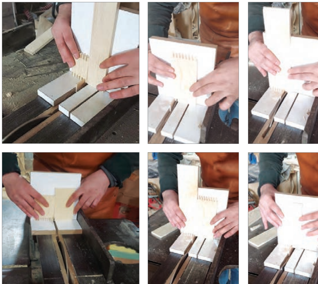
شکل ۲۳- برش و ساخت اتصالات انگشتی
