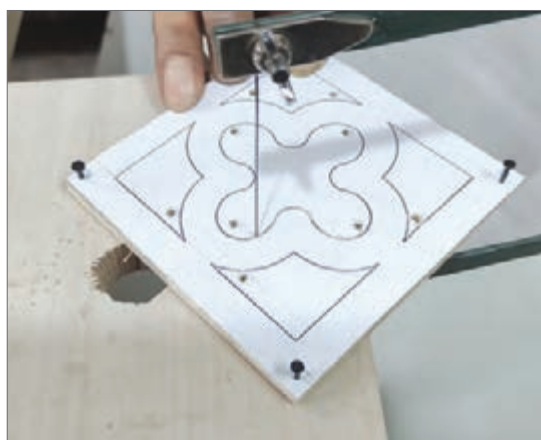
شکل ۲۰- محل صحیح سوراخ کاری و اجرای هم‌زمان برش روی صفحات دولایه پارچه‌بری
