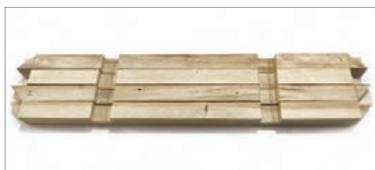
شکل ۵- مراحل ساخت اتصال فارسی نیم ونیم کلاف اصلی
