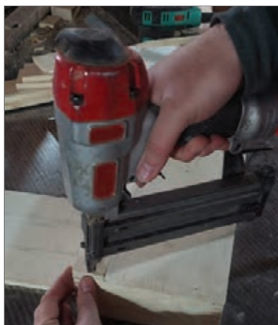
شکل ۲۵- استفاده از میخکوب
