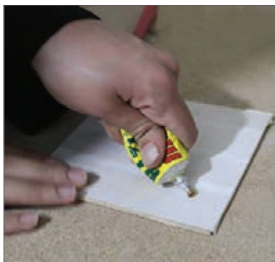
شکل ۲۷- آغشته کردن سطح چوب با چسب
