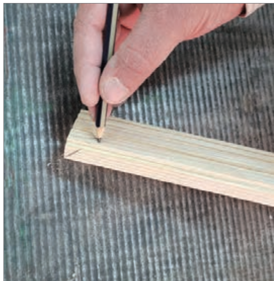
شکل ۲۹- مشخص کردن سطوح برش
