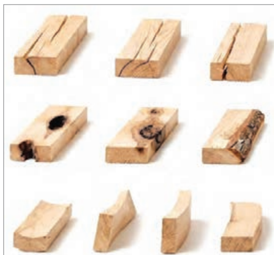
شکل ۴- برخی آسیب‌های ظاهری چوب
