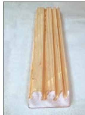
شکل ۵۲- آماده‌سازی قطعات بدنه ساعت جهت سرهم کردن
