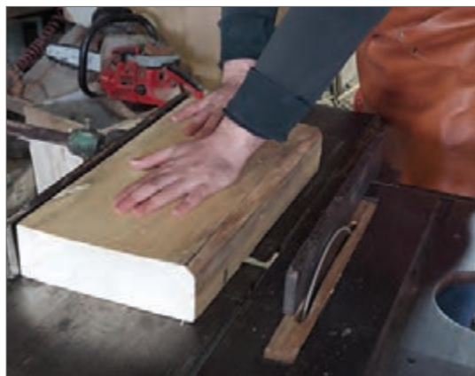
شکل ۵- رنده کردن سطح روی کار
