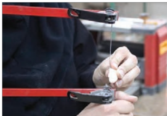
شکل ۴۰- مراحل کار برش و استفاده از پارافین خشک
