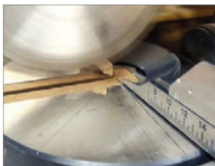
شکل ۲۵- برش کاری و دوراهه ستون‌ها و قاب‌ها
