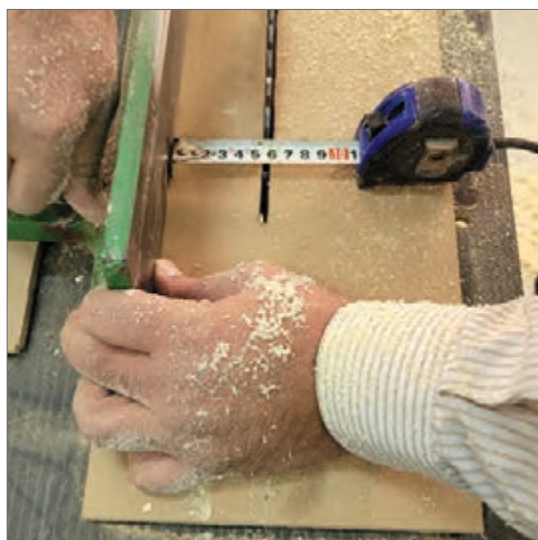
شکل ۲۷- تنظیم گونیا با اندازه ۵ سانتی متر
