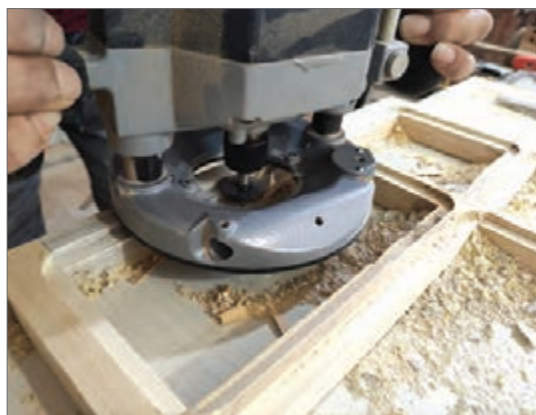
شکل ۱۰- اجرای دوراهه با اورفرز روی کلاف پنجره
