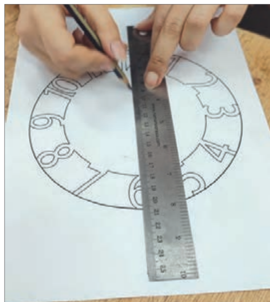
شکل ۴۳- علامت‌گذاری و مرکز‌یابی طرح
