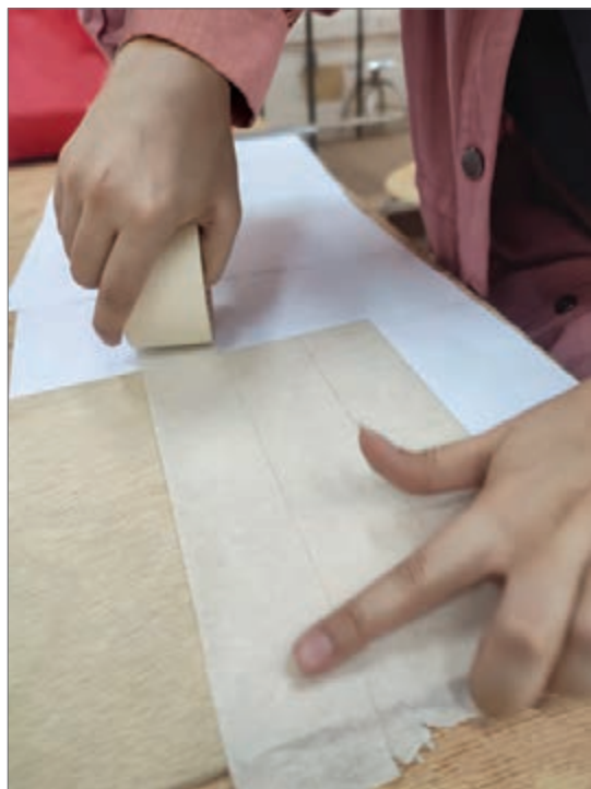
شکل ۴۰- پوشش دهی سطح صفحات با چسب کاغذی
