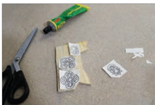
شکل ۵۳- جایابی و چسباندن طرح بر سطح کار
