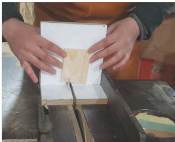
شکل ۲۰- برش آزمایشی با جیگ
