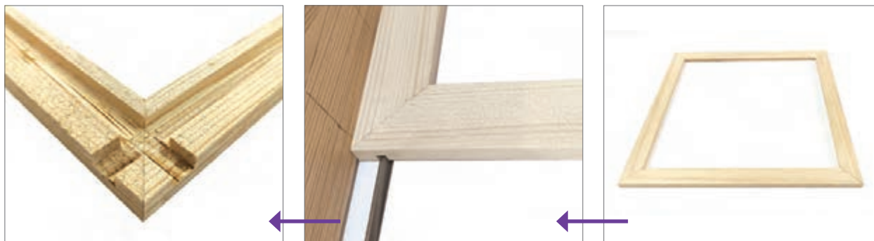
شكل ۶- مراحل شیارزنی قاب بیرونی كلاف
