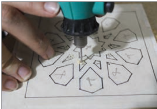
شکل ۳۵- روش سوراخ کردن فضای منفی
