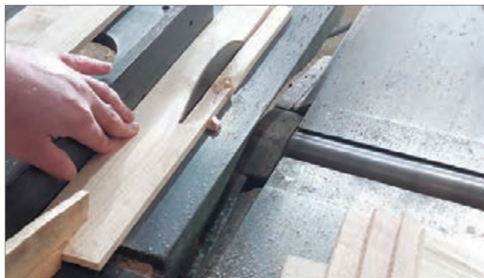
شکل ۱۱- برش طولی و تنظیم بر اساس پهنای قطعات
