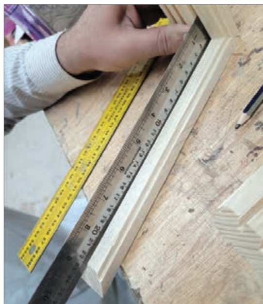
شکل ۳۶- نحوه استخراج اندازه صفحات داخلی ساعت
