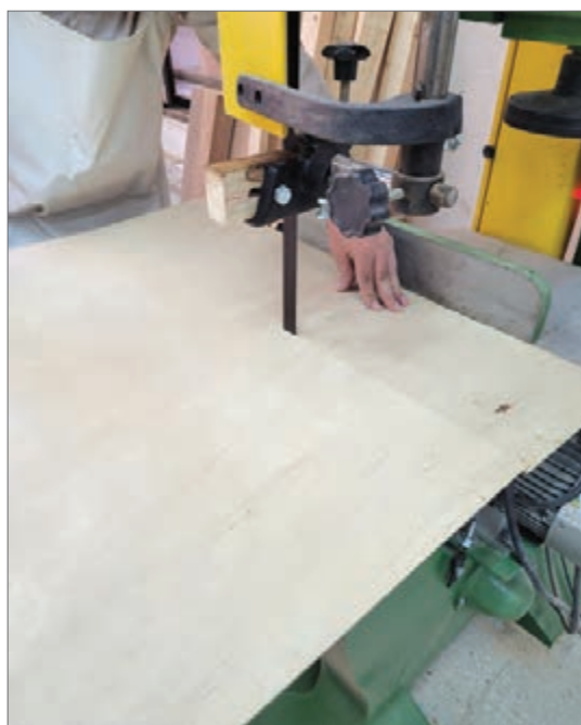
شکل ۳۷- برش تخته سه لایی با اره فلکه
