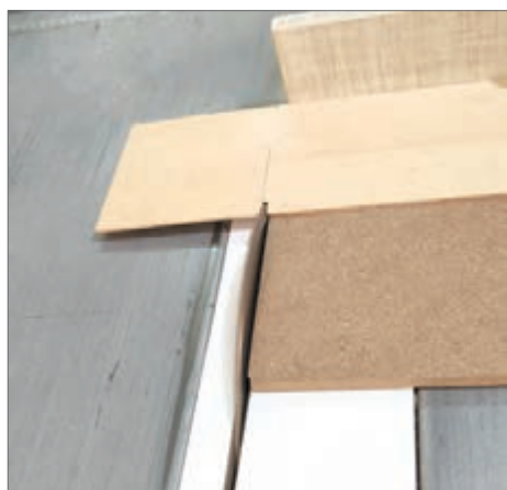
شکل ۱۷- انتقال اندازه‌ها روی ورق سه‌لایه و برش صفحات
