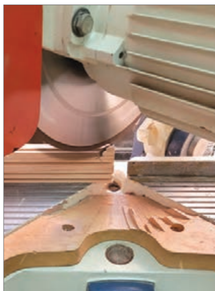
شکل ۳۴- برش زاویه فارسی چپ و راست قطعات
