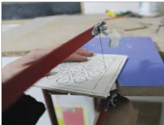
شکل ۳۶- دوربری کلی طرح
