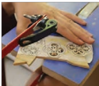
شکل ۵۶- برش کاری سوراخ‌های داخلی
