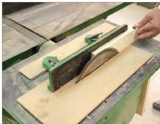
شکل ۲۶- برش طولی قطعه به جای گندگی کردن
