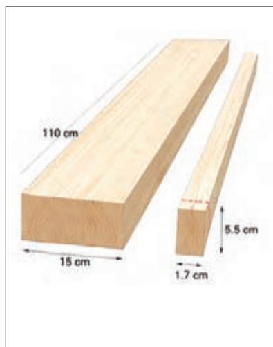
شکل ۲۴- برش اولیه قطعه از الوار با اره فلکه
