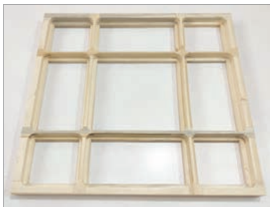
شکل ۱۰- اجرای دوراهه با اورفرز روی کلاف پنجره
