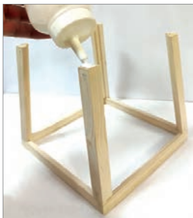
شکل ۲۸- مراحل سرهم کردن کلاف
