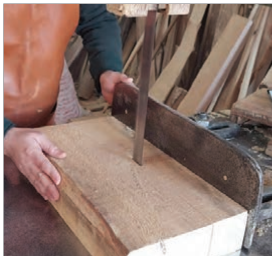
شکل ۸- برش طولی الوار
