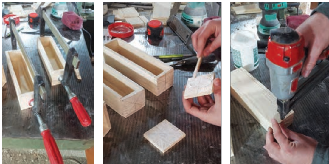
شکل ۲۸- مراحل سرهم کردن و چسباندن قطعات کشوها
