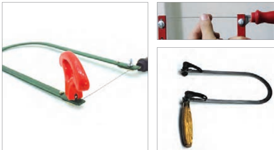
شکل ۱۱- شیوه قرارگیری و بستن تیغه اره و نمونه کمان اره با پیچ اهرمی و مشتی
