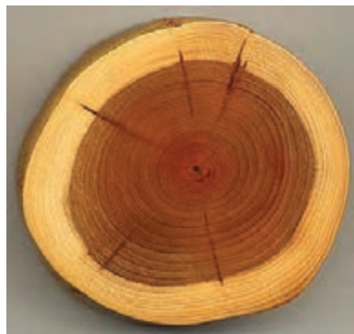
شکل ۵۵- دواير ساليانه و تمايز چوب درون و برون در گرده بينه عناب
