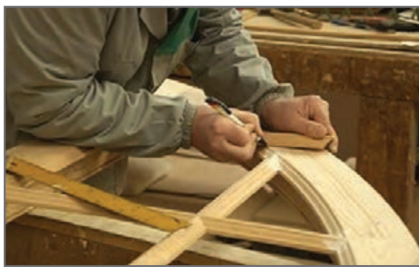
شکل ۱۷- نمونه ساخت پنجره چوبی - درودگری
