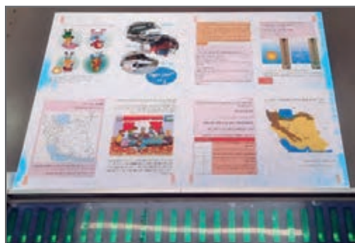
شکل ۱۰- سیاه کردن نمونه چاپ
