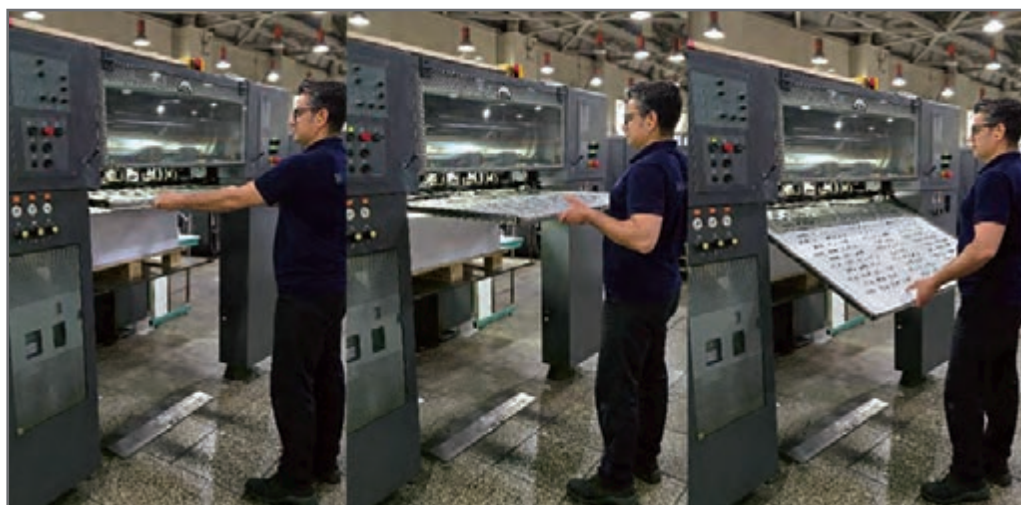
شکل ۲۳- مراحل سینی زدن
