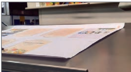
شکل ۹- لول شدگی در لبه‌های کاغذ
