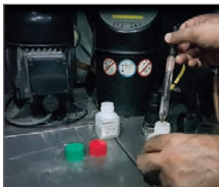
شکل ۲۱- فرایند کالیبره کردن PH سنج
