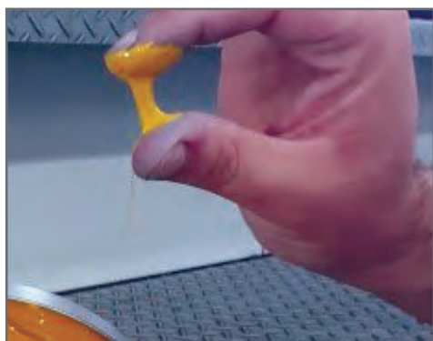
شکل ۱۲- تست کشش مرکب
