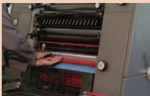
قرار دادن ته کار پلیت در گیره
