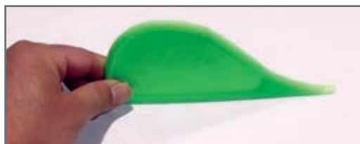
شکل ۳- ابزار رول باز کن
