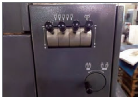
شکل ۵۳- دستگیره‌های تنظیم دمنده
