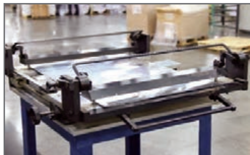
شکل ۶۴- قرار گرفتن پانچ پلیت بر روی پین
