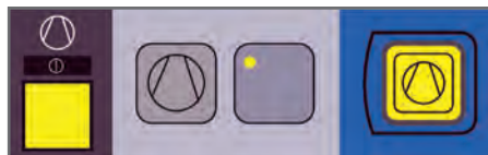
شکل ۱۰- کلید روشن، خاموش پمپ آپارات
