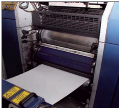
شکل ۶۹- سیلندر آماده بستن پلتهای
