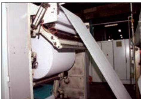
شکل ۲۰- سیستم عملکرد تغذیه بدون توقف (Splicer)
