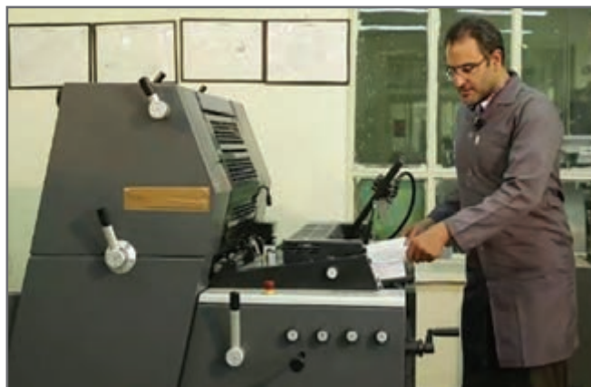
شکل ۱۱- بارگذاری سطح چاپ شونده در واحد تغذیه
