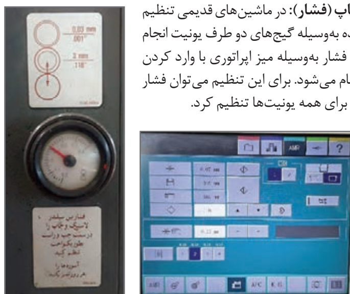
شکل ۸۱- منوی تنظیم فشار و گیج تنظیم فشار
