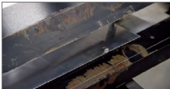
شکل ۶۵- قرار گرفتن پین در داخل پانچ
