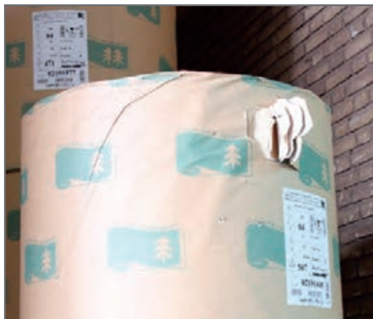
شکل ۶- خراش و پارگی روی بدنه رول
