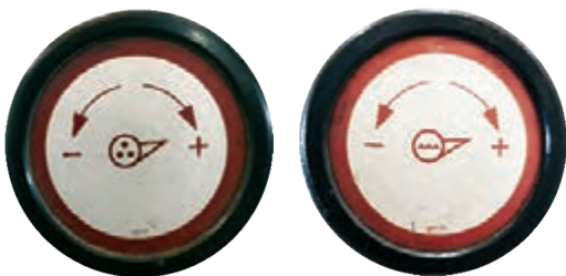
شکل ۵۶- دستگیره های تنظیم سرعت چرخش نورد منشأ
