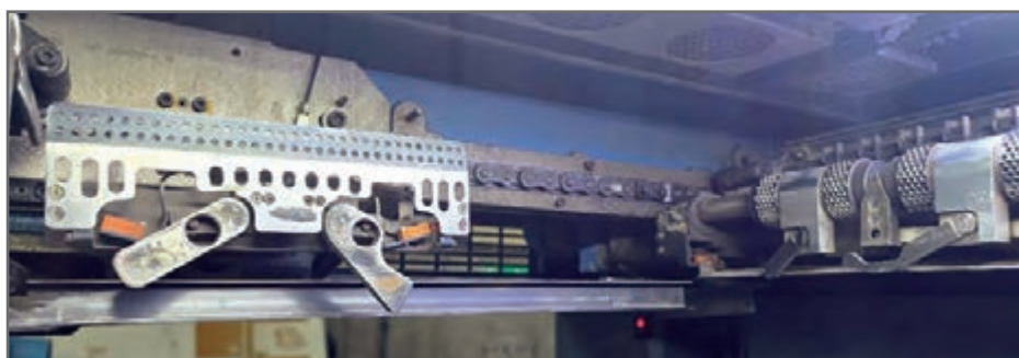
شکل ۵۱- دسته کن و مکنده قرقره ای واحد تحویل
