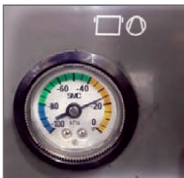
شکل ۳۳- گيج مکش صفحه متحرک نشان
