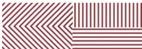
شکل ۴۴- تارگت‌های تشخیص کشش و لغزش
