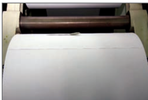
شکل ۱۲- لبه گونیا شده رول
