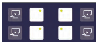
شکل ۱۷- کلید حرکت موضعی کلگی آپارات
