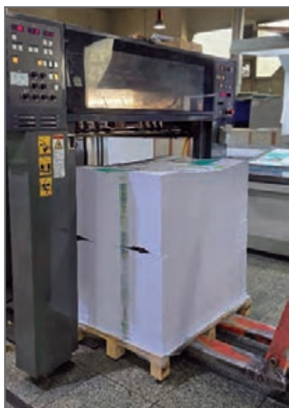
شکل ۲۷- خارج کردن پالت از واحد تحویل
