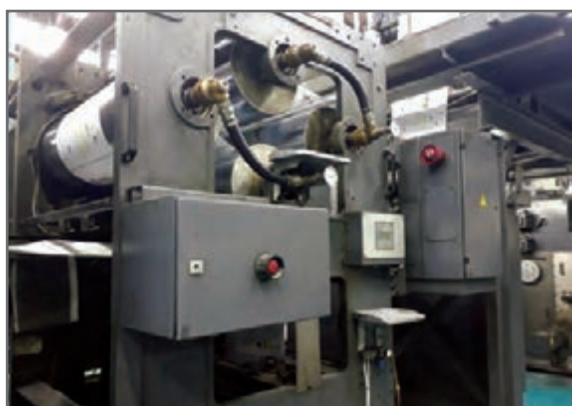
شکل ۳۰- بخش خنک کننده دستگاه افست رول هیت ست (Heat Set)
