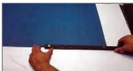
شکل ۷۵- نصب گیره لاستیک
