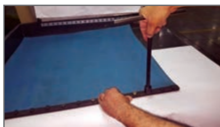
شکل ۷۶- نصب گیره لاستیک
