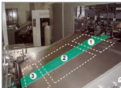
شکل ۴۴- تسمه مکنده سینی انتقال
