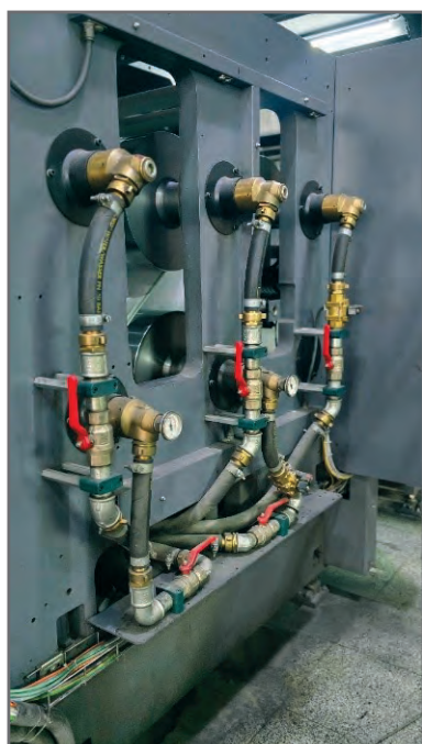
شکل ۸۲- چیلر خنک کننده خشک کن
