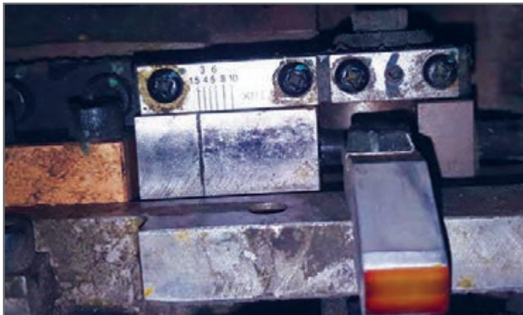
شکل ۸۵- تنظیمات زیر پنجه ترانسفر
