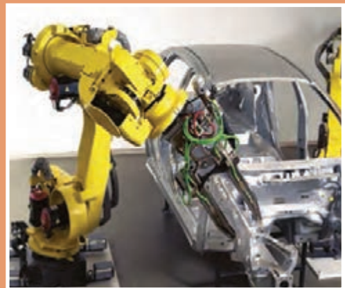
اجرای نقطه جوش
