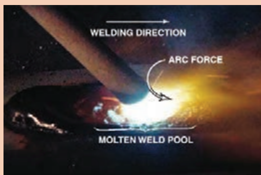
الف) جوشکاری با زاویه پیشران
