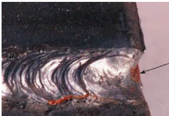
شکل ۴۶- به ریشه جوش نگاه کنید تا مطمئن شوید که ذوب کامل اتفاق افتاده است.
