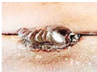
شکل ۶۱- اندازه فاصله ریشه باید یکنواخت باشد تا جوش نهایی کیفیت لازم را داشته باشد.
