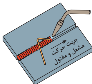
شکل ۲۷- جهت حرکت مشعل و سیم جوش و زوایای جوشکاری
