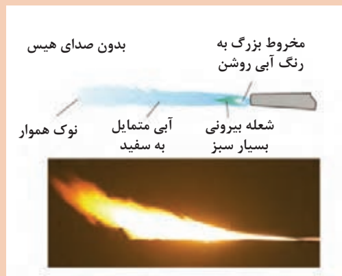
تنظیم شعله احیا (کربن ده)
