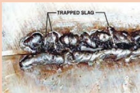
عیب ایجاد شده در اثر حرکت سریع الکتروده در عرض جوش
