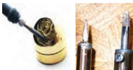
شکل ۱۸- کنترل تمیزی نوک هویه
