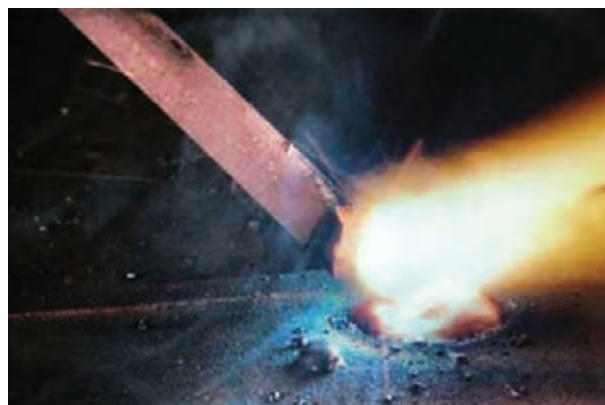
برقراری قوس با الکتروودی که روکش آن کنده شده (عدم برقرار قوس پایدار)
