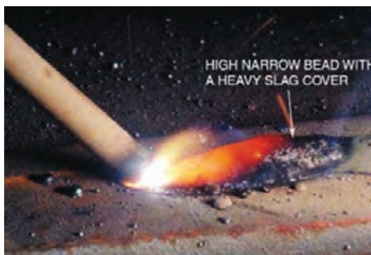
شکل ۴۴- جوشکاری با طول قوس بسیار کم
