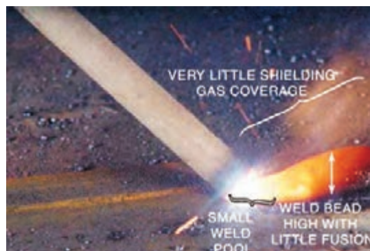
شکل ۴۰- جوشکاری با طول قوس کوتاه
