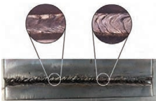
شکل ۴۷- الگوی حرکتی در اتصال لب روی هم
