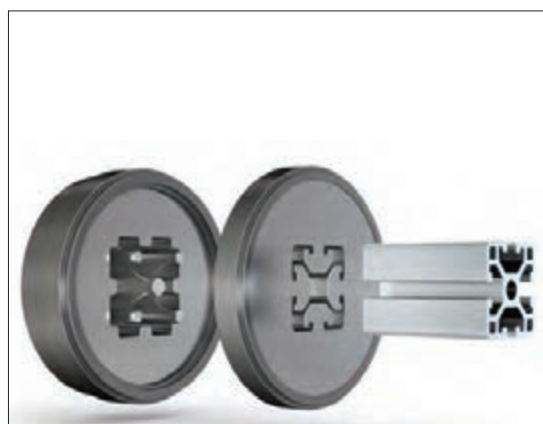
شکل ۳۱- اکستروژن پروفیل‌های آلومینیومی
