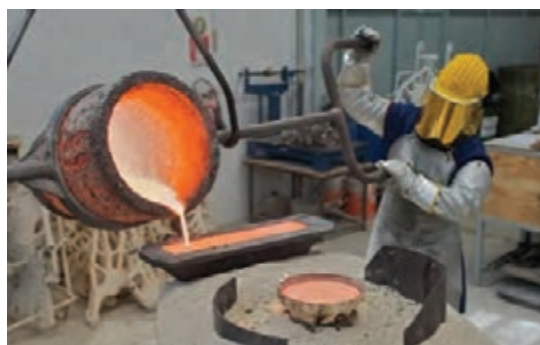
شکل ۲۶- ذوب ریزی درون قالب ریخته‌گری
