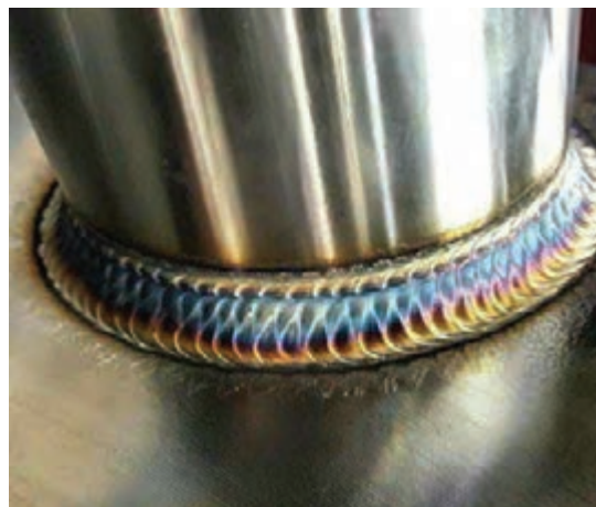
شکل ۲۷- جوشکاری محفظه خلأ
