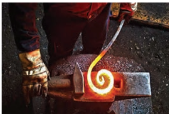
شکل ۲۹- فرایند فورجینگ قطعه فولادی
