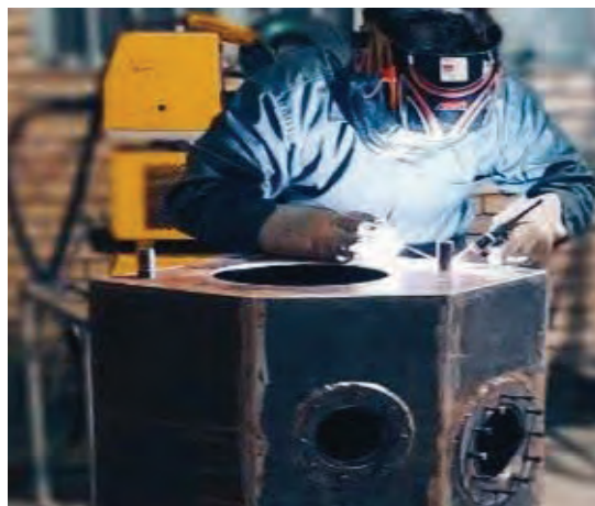
شکل ۲۷- جوشکاری محفظه خلأ
