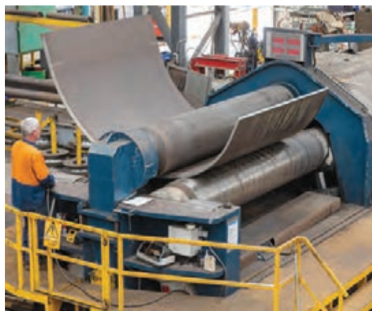
شکل ۳۰- فرایند نوردکاری، ورق فولادی
