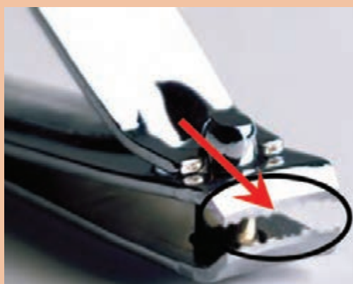
شکل ۱۹- لبه‌های برنده خراب شده در ناخن‌گیر و دم‌باریک
