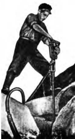
شکل ۴-۱۳- وضعیت ناپایدار کارگر کوه‌بُر روی گرانیت (۶)
