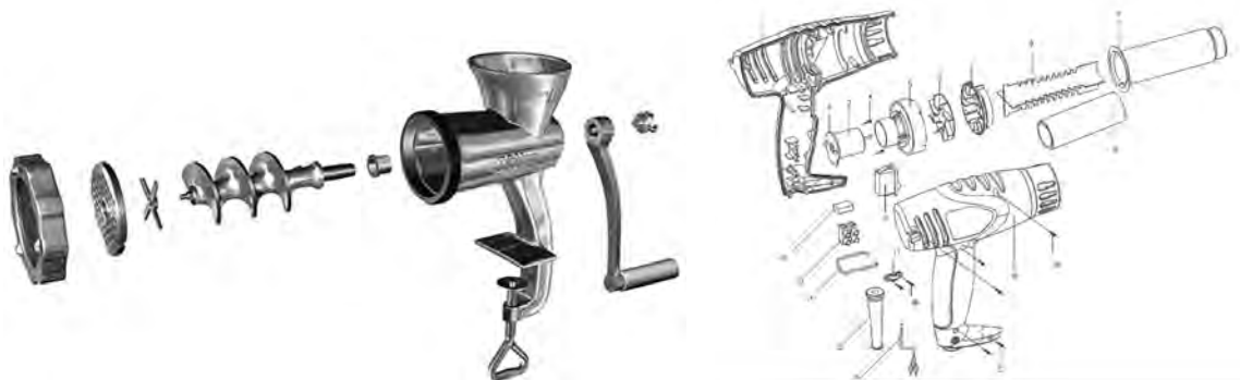
شکل ۶۷- تصویر سه بعدی انفجاری چرخ‌گوشت دستی
