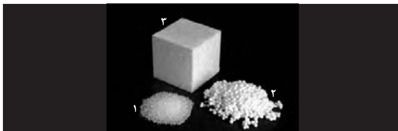
شکل ۱- فرم های مختلف یونولیت؛ ۱- گرانول های قبل از انبساط، ۲- دانه های بعد از انبساط و ۳- شکل نهایی
