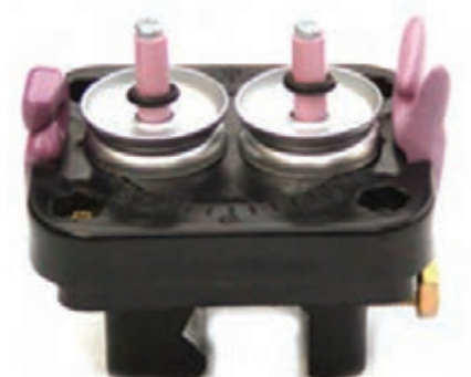
شکل ۲۲- دستگاه کشیدگی نخ با صفحه و فنر
