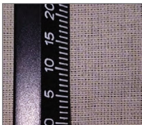
شکل ۲- شمارش تاروپود به کمک پودشمار
