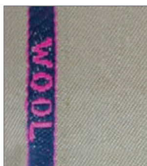
شکل ۹- روی پارچه با طرح سرژه ۲ و ۱ صعودی
