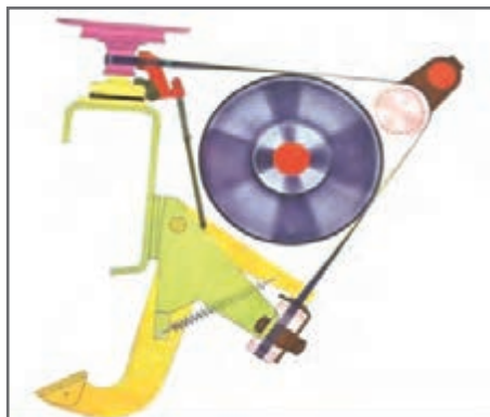
شکل ۱۵- تجهیزات ترمز گرفتن دوک
