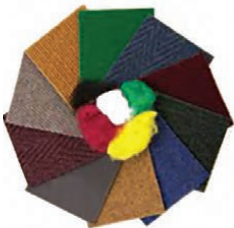
شکل ۶- نمونه‌ای از منسوجات بی‌بافت تهیه شده از طریق روش سوزن زنی
