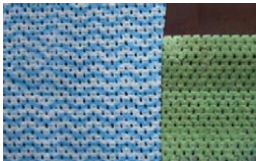
منسوج تهیه شده از طریق فشار آب
