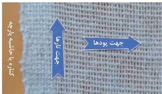
شکل ۱- تعیین جهت تاروپود با پارچه کناره‌دار
