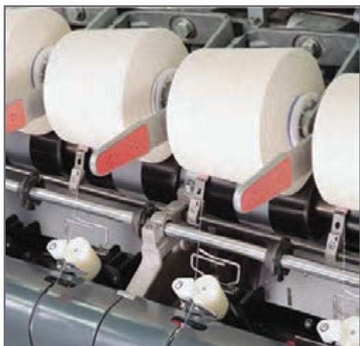
شکل ۱۳- راهنمای متحرک پیچش نخ (تراورس)
