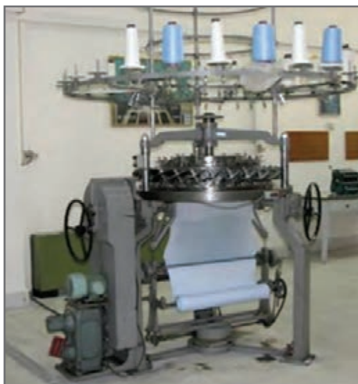
شکل ۳- دستگاه بافندگی با ساختار حلقوی پودی و انواع سوزن‌ها
