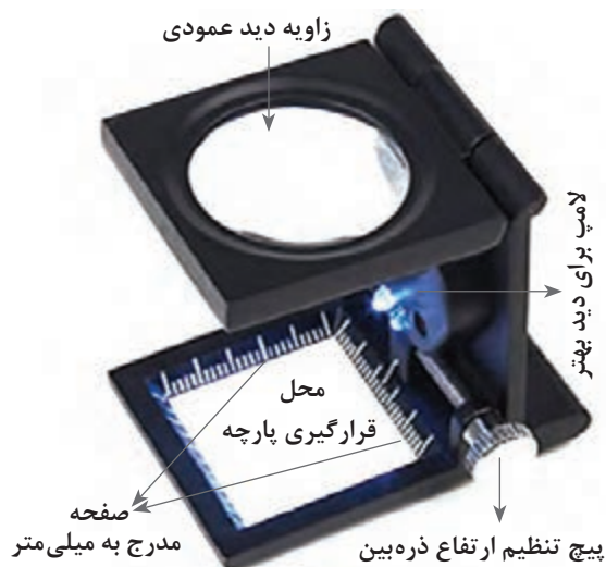
شکل ۱۴- نحوه استفاده از پود شمار
