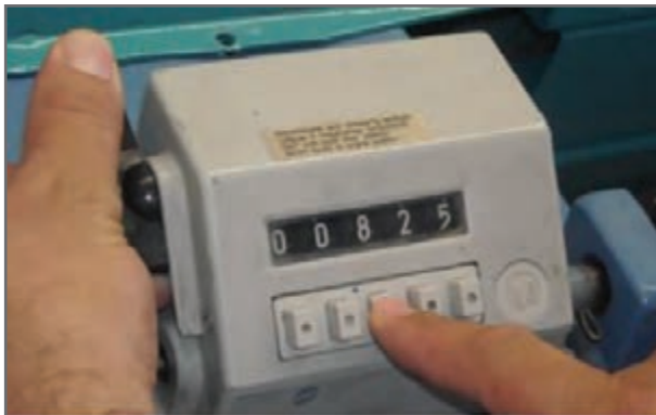
شکل ۱۸ نمونه یک دستگاه مترآژ روی دستگاه چله پیچ
