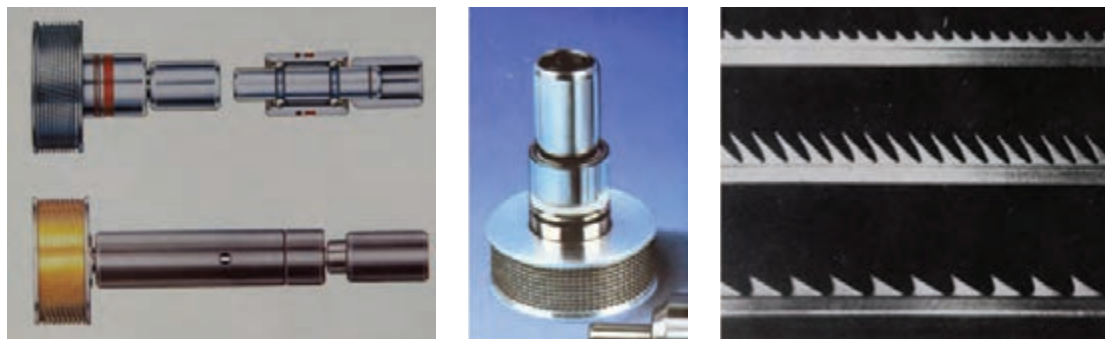
شکل ۱۰- نمایشی از زننده و انواع خارهای آن
