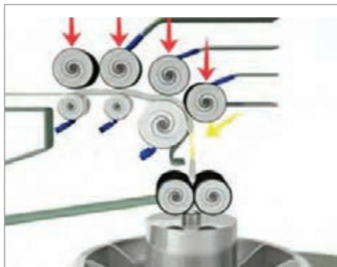
شکل ۸- چگونگی قرار گرفتن غلتک‌های کشش و غلتک کالندر
