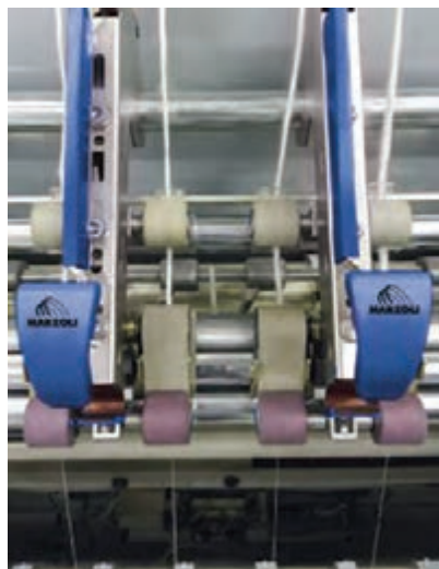
شکل ۸- تصویر واقعی سیستم کششی در رینگ
