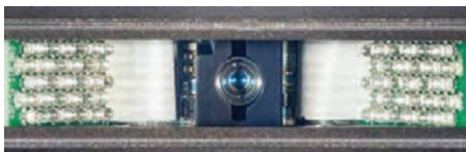
شکل ۴۳- دوربین و فلش آن و سیستم کنترل نپ
