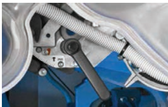
شکل ۸- تنظیم چاقوی تمیزکننده و روش تنظیم چاقویی با چرخاندن دستگیره
