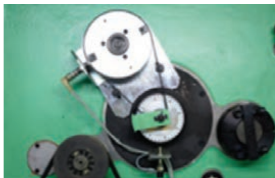
الف) چرخ مدرج انتقال نیرو به اجزای شانه
