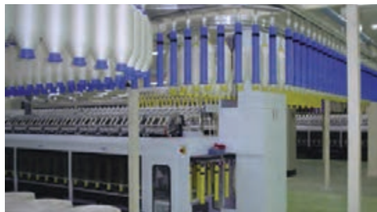
شکل ۵۱- انتقال اتوماتیک بوبین‌ها
