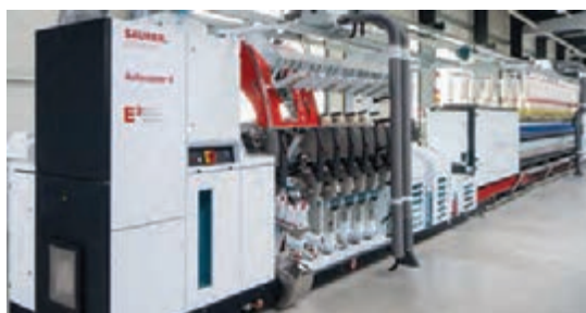
شکل ۳۵- تمیزکننده سیار با دمنده‌ها و مکندehای روی آن
