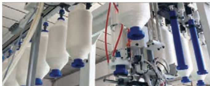
شکل ۳۲- انتقال اتوماتیک بوبین‌های نیمچه نخ از فلایر به رینگ و جمع‌آوری ماسوره‌ها
