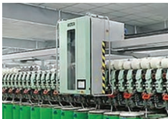
شکل ۷- پیوند اتوماتیک نخ در ماشین اوپن‌اند
