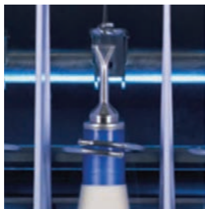
شکل ۲۱- راهنما و حلقه کنترل بالون و صفحه جداکننده و ماسوره نخ
