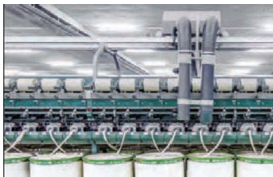
شکل ۱۶- تمیزکننده سیار روی ماشین چرخانه
