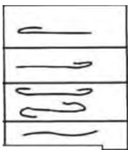
شکل ۴۰- الیاف سرعصایی در تار عنکبوتی روی دافر
