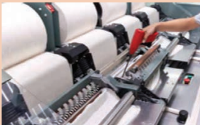
شکل ۴۳- روش پرزگیری با تفنگی پرزگیر
