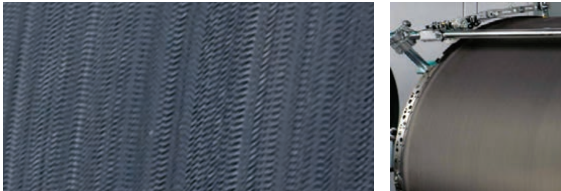
شکل ۱۹- سطح سیلندر اصلی پوشش داده شده با نوار متالیک
