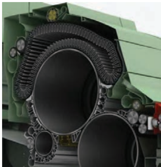
شکل ۲۶- شکل کلاهک و موقعیت نصب آن روی سیلندر اصلی
