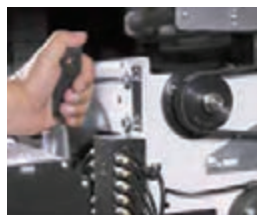
شکل ۹- تنظیم فاصله نواحی کشش بین غلتک‌ها
