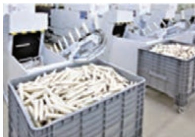
شکل ۳۲- انتقال اتوماتیک بوبین‌های نیمچه نخ از فلایر به رینگ و جمع‌آوری ماسوره‌ها
