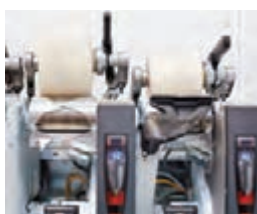
شکل ۴۸- فشار بدون وزنه (مکانیکی) فشار به وسیله وزنه
