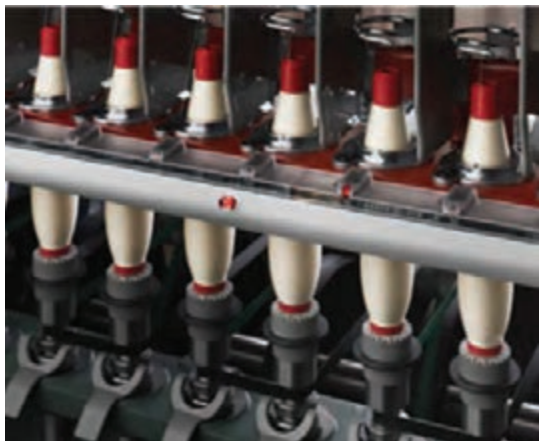
شکل ۲- فاصله دو دوک متوالی در دستگاه رینگ
