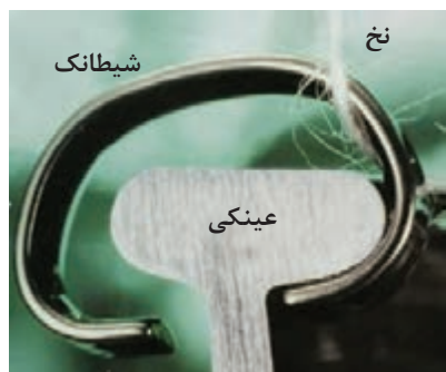
شکل ۱۹- محل عبور نخ از بین شیطانک و عینکی می‌گذرد
