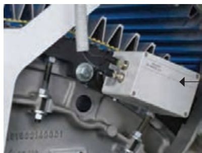
شکل ۳۵- موتور تنظیم فاصله کلاhek و سیلندر
