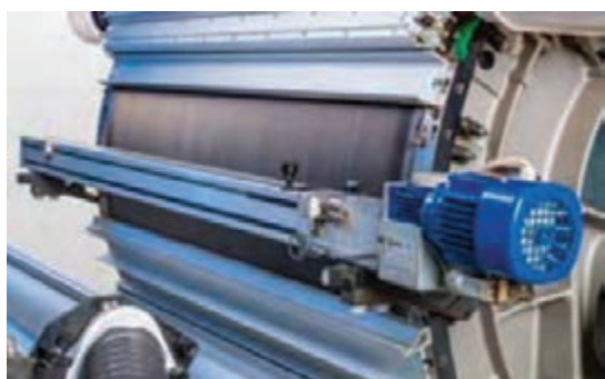
شکل ۲۳- ابزار آلات مخصوص سنگ زدن وایرهای سلیندر و دافر
