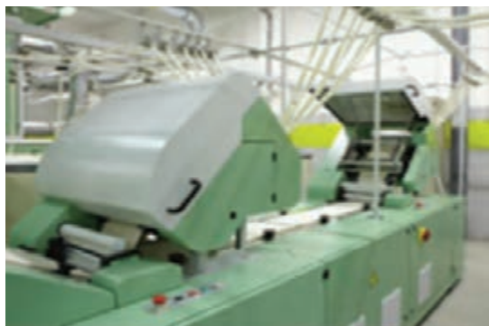
شکل ۲۳- نمای عمل تغذیه و کشش در ماشین بالشچه
