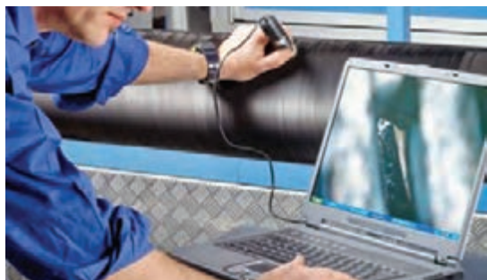
شکل ۲۲- ابزارهای مشاهده عیوب نوار اره‌ای (وایر) کارد
