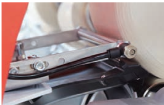
شکل ۴۹- کنترل فشار و اندازه بوبین و داف کردن
