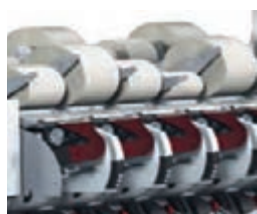
شکل ۴۸- فشار بدون وزنه (مکانیکی) فشار به وسیله وزنه
