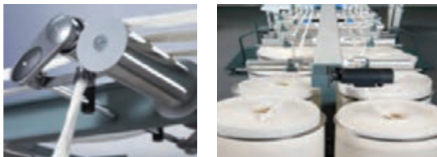
شکل ۲- قسمت تغذیه ماشین هشت لاکنی فتیله و راهنمای فتیله
