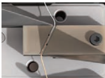
۲ پیچیدن دو نخ و تاب دادن
