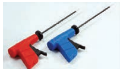
شکل ۳۷- تمیزکننده ماشه ای (رول پیکر) جهت پرزگیری ماشین رینگ و ماشین های دیگر
