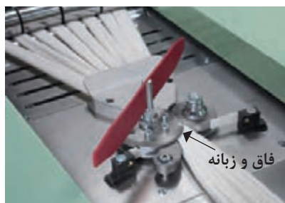
شکل ۱۴- روش فاق و زبانه (غلتک شیاردار زبانه‌دار)
