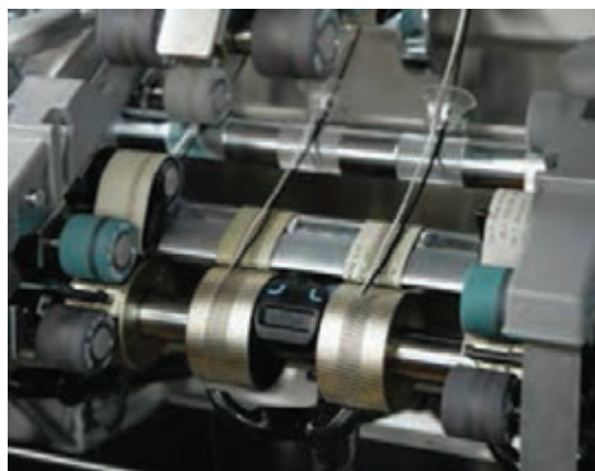
شکل ۱۵- یک واحد غلتک مشبک کشش رینگ (کامپکت)
