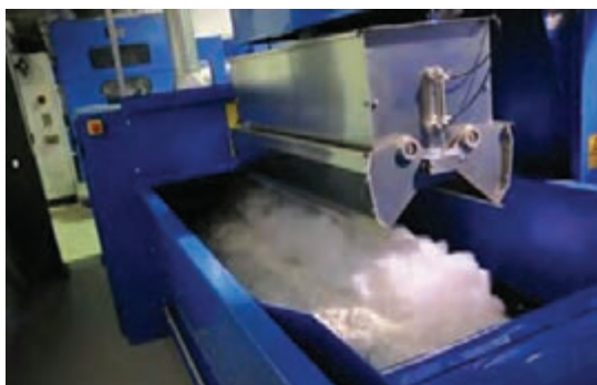
شکل ۵- سیستم تغذیه با یک ترازو (وزنی)
