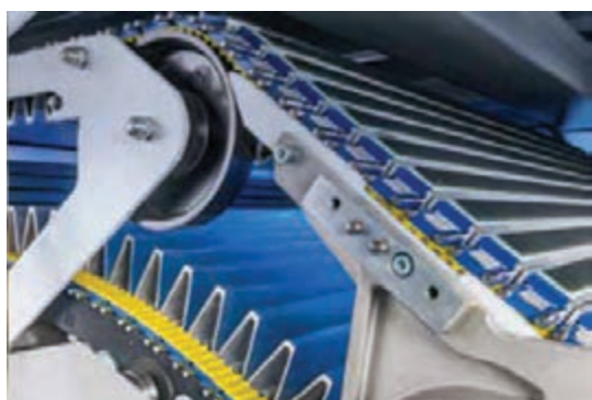
شکل ۲۹- حرکت پروفیل های فلت روی تسمه های کلاhek
