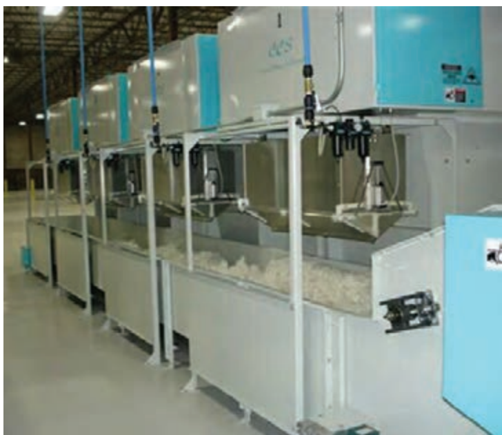
شکل ۶- دستگاه تغذیه وزنی چند ترازویی و عملکرد درون آن
