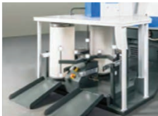
شکل ۴۹- تعویض اتوماتیک بانکه در ماشین کارد با جابه‌جایی بانکه
