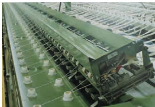
شکل ۳۳- خروج نیمچه نخ از منطقه کشش
