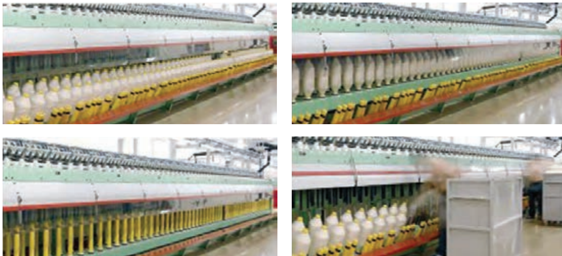
شکل ۴۸- مراحل داف نیمه‌اتوماتیک
