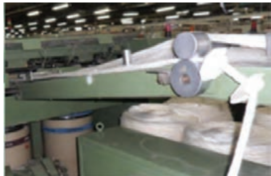
شکل ۴- جفت غلتک راهنمای فتيله و قطع‌کننده حرکت ماشین در صورت پارگی فتيله
