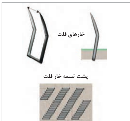
شکل ۲۸- شکل سوزن های انعطاف پذیر فلت باروکش مناسب
