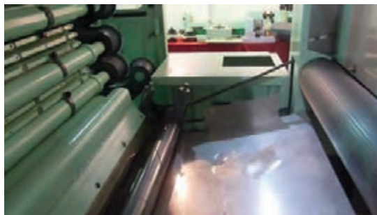
شکل ۱۰- سینی و غلتک تغذیه در سیستم قدیمی
