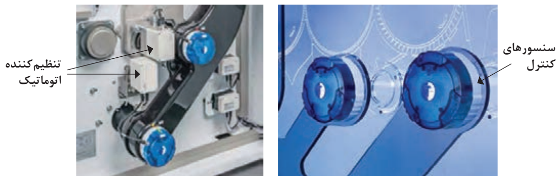
شکل ۵۱ - سنسور کنترل ضایعات در تمیزکننده‌ها
