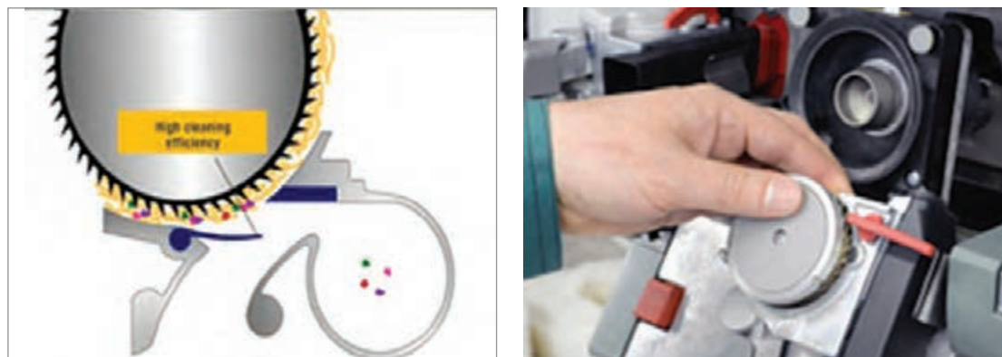
شکل ۱۱- نمایشی از سیستم تغذیه زننده‌ای در ماشین چرخانه‌ای
