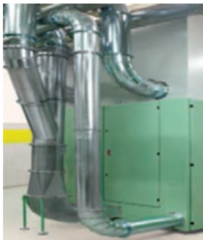
شکل ۲۴- نمونه اتصالات شوت فید
