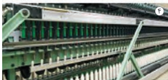
شکل ۳۴- مراحل داف اتوماتیک در ماشین رینگ و مراحل آن
