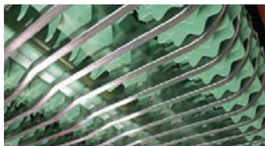
شکل ۲۷- نمای تیغه‌های دستگاه عدل بازکن و نمای داخلی هد دستگاه و زننده آن
