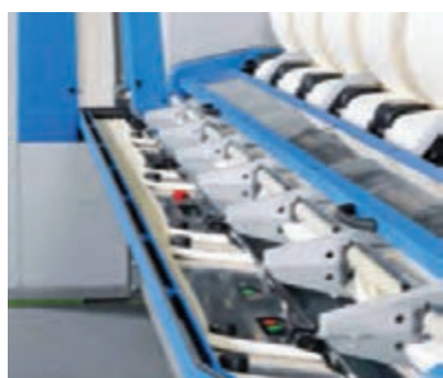
شکل ۳۹- انتقال فتیله ها به بخش کشش از روی سینی انتقال
