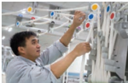
شکل ۲۲- ناحیه کشش و صفحه تغذیه راهنمای فتیله در ماشین بالشچه
