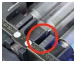
شکل ۹- تنظیم فاصله نواحی کشش بین غلتک‌ها
