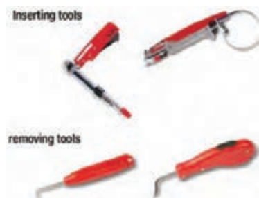
شکل ۲۴- ابزار خارج کردن یا انداختن شیطانک روی عینکی
