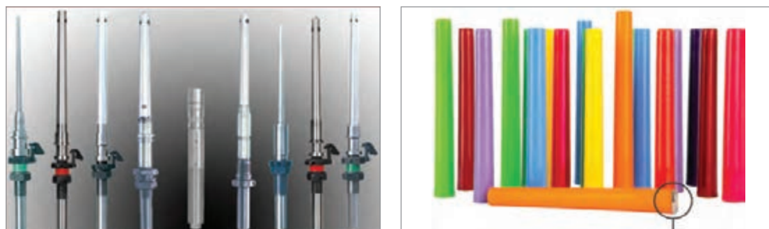
شکل ۲۶- انواع ماسوره پلاستیکی رینگ و انواع اسپیندل رینگ
