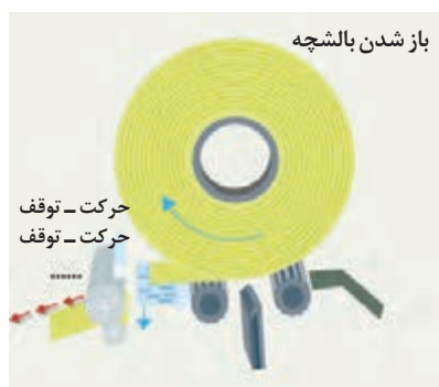
شکل ۳۲- بخش باز شدن لایه بالشچه یا تغذیه
