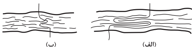
شکل ۸- نمایش قرار گرفتن مولکول‌های بلند و کوتاه در داخل لیف
