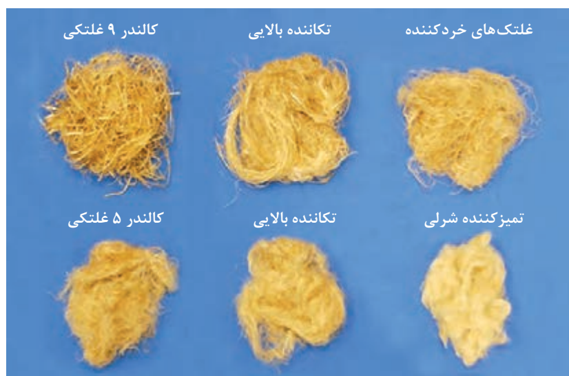
شکل ۲۶- تصویر الیاف کتان پس از انجام مراحل مختلف
