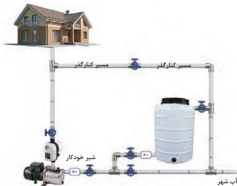
شکل ۵- تأمین آب با پمپ و مخزن ذخیره
