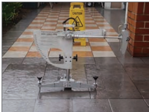
شکل ۲۷- دستگاه آزمایش لغزندگی سرامیک در پای کار
