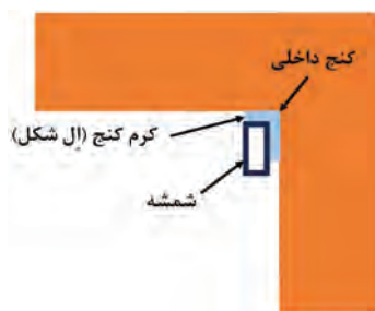
شکل ۱۴- اجرای کنج داخلی به شیوه کرم کنج
