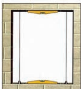
شکل ۴۱- کنترل گشودگی به کمک تراز و شاقول
