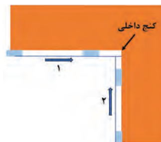
شکل ۱۳- اجرای کنج داخلی به شیوه اتصال اندودهای دو دیوار
