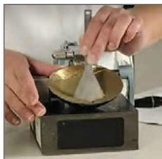
شکل ۱۶- ایجاد خط در مرکز نمونه
