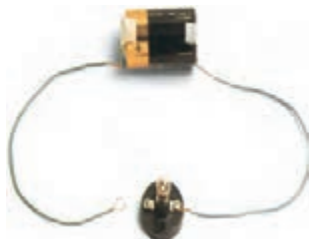
شکل ۵-۸ قطع شدگی در مدار
