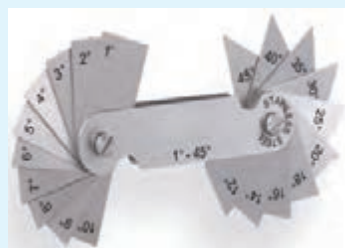
شابلون زاویه (اندازه‌گیری زاویه قطعات)
