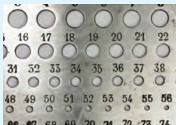
شابلون میله (اندازه‌گیری قطر میله‌ها)
