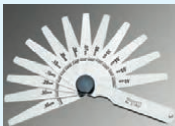
شابلون فیلر (اندازه‌گیری شکاف‌ها و شیارها)
