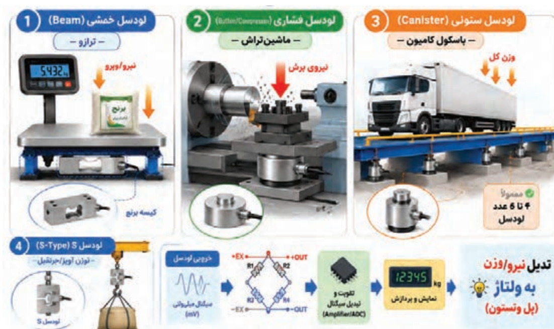
شکل ۳۶ - کاربرد انواع لودسل
