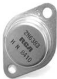
شکل ۱۲- زوج دارلینگتون در یک بسته‌بندی
