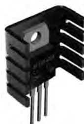
شکل ۷۵- ترایاک متصل شده به گرماگیر
