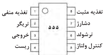
شکل ۶۱- نقشه بلوکی و پایه های آی سی ۵۵۵
