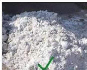
شکل ۳-۳۶ آهک سرنده (الک) شده و آماده برای ساخت شفته
