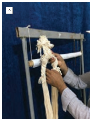
شکل ۳-۳- انتقال چله بردار
