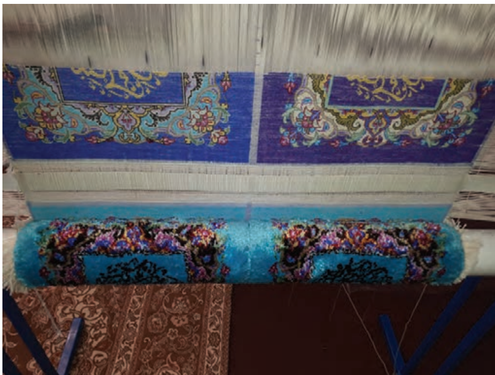
شکل ۱-۵ - یک نمونه قالی پایین‌کشی شده بر روی دار
