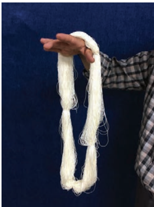
شکل ۲-۲۲- برداشتن کلاف و باز کردن تاب کلی
