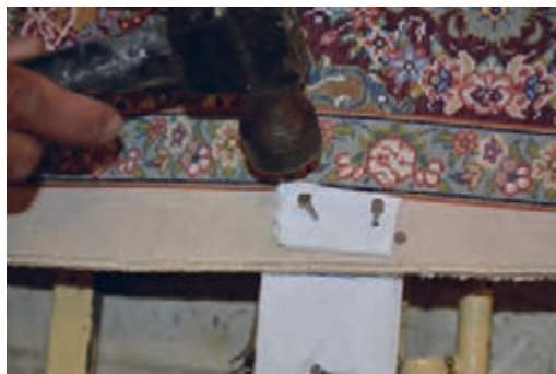
شکل ۲۴-۵ - ثابت کردن فرش با میخ
