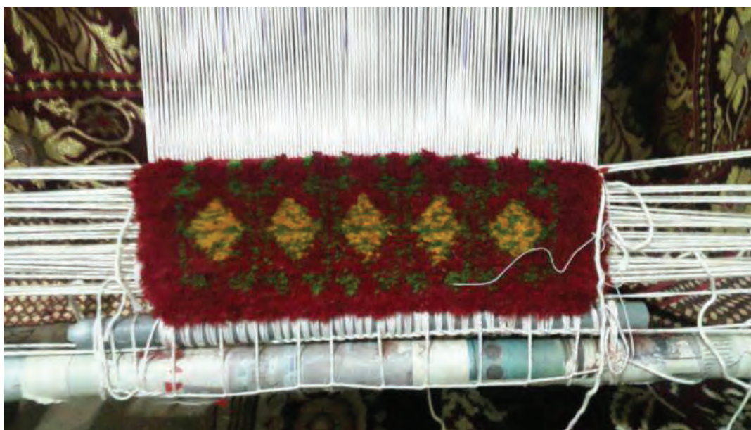
شکل ۱۲-۳- نمونه دیگری از دوخت به روش میله کمکی
