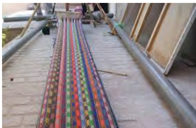
شکل ۲۰-۳- چله کشی بر روی دار در حالت افقی برای بافت جاجیم
