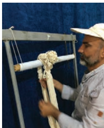
شکل ۳-۴- انتقال سردار بر روی دار فندک دار
