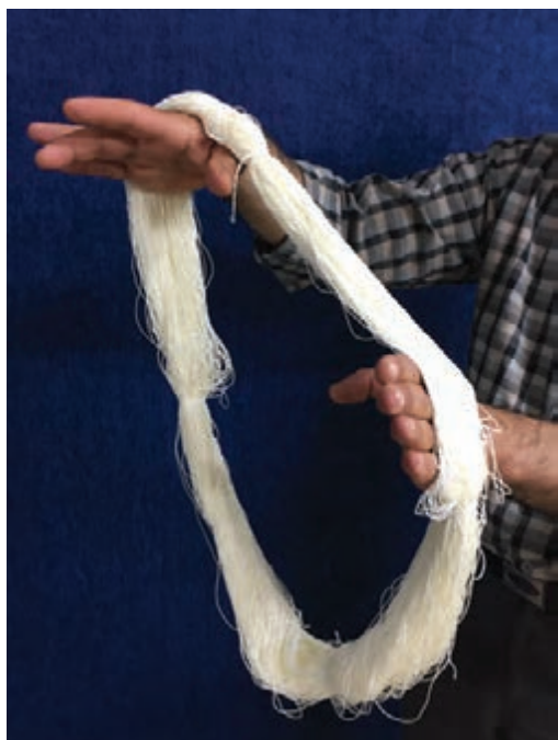
شکل ۲-۲۳- وارد کردن دست‌ها به داخل کلاف و باز کردن تاب‌های فرعی
