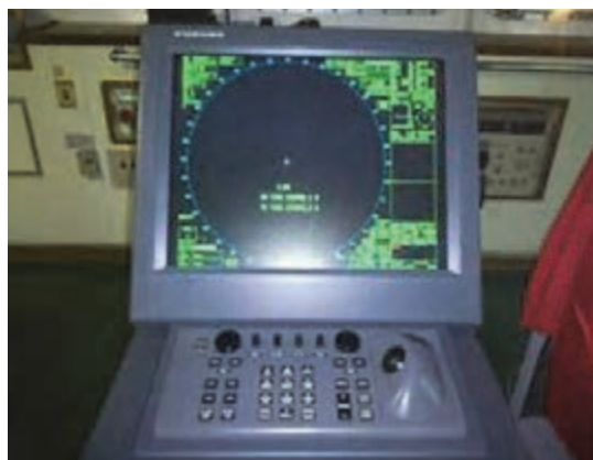
شکل ۷- نمایشگر رادار ناوبری
