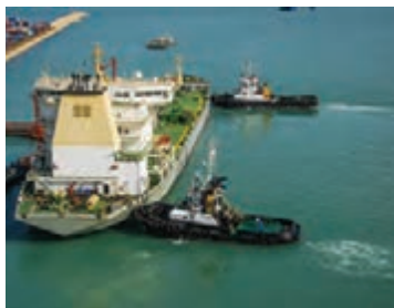
شکل ۲۹- عملیات یدک‌کشی پهلوبه‌پهلوی
