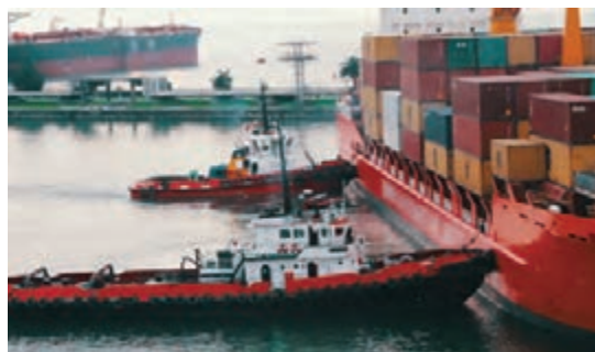
شکل ۳۰- عملیات یدک کشی به روش پهلوبه پهلو یا هل دادن
