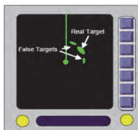
شکل ۱۶- نمایش پژواک‌های جانبی در صفحه نشانگر رادار
