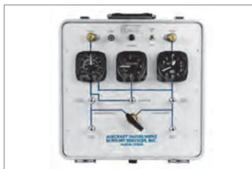
شکل ۲۴- نشان‌دهنده ولوله پیتوت (رادومتر)
