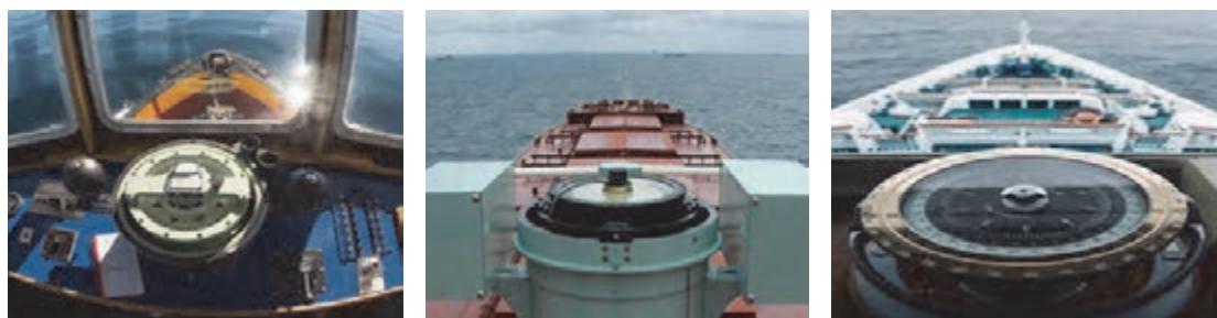
شکل ۱- چند نمونه قطب‌نمای مغناطیسی
