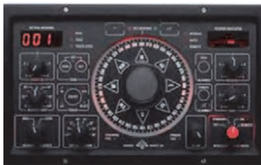
شکل ۲۷- قسمت قرار دادن راه (Set Course Unit)
