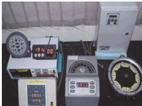
شکل ۳- قطب‌نمای الکتریکی (جایرو) و متعلقات آن
