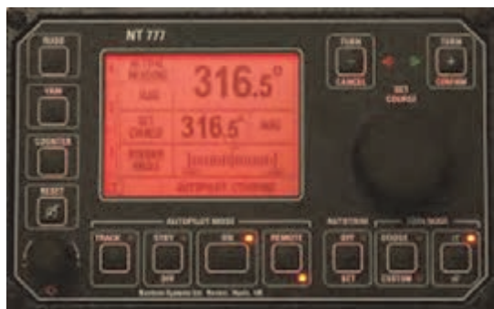
شکل ۲۷- قسمت قرار دادن راه (Set Course Unit)
