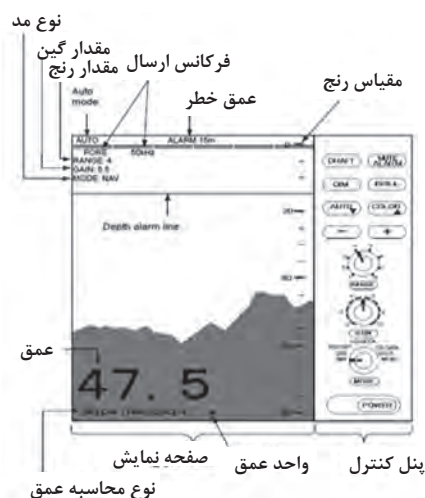
شکل ۱۸- مشخصه‌ها و نشانه‌های نمایشگر عمق‌یاب
