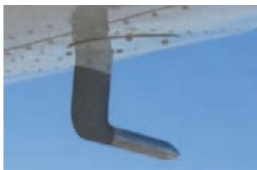
شکل ۲۴- نشان‌دهنده ولوله پیتوت (رادومتر)
