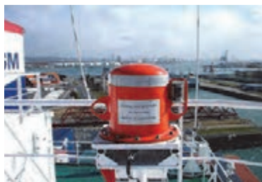
شکل ۳۳- سامانه ثبت اطلاعات سفرهای دریایی (VDR)
