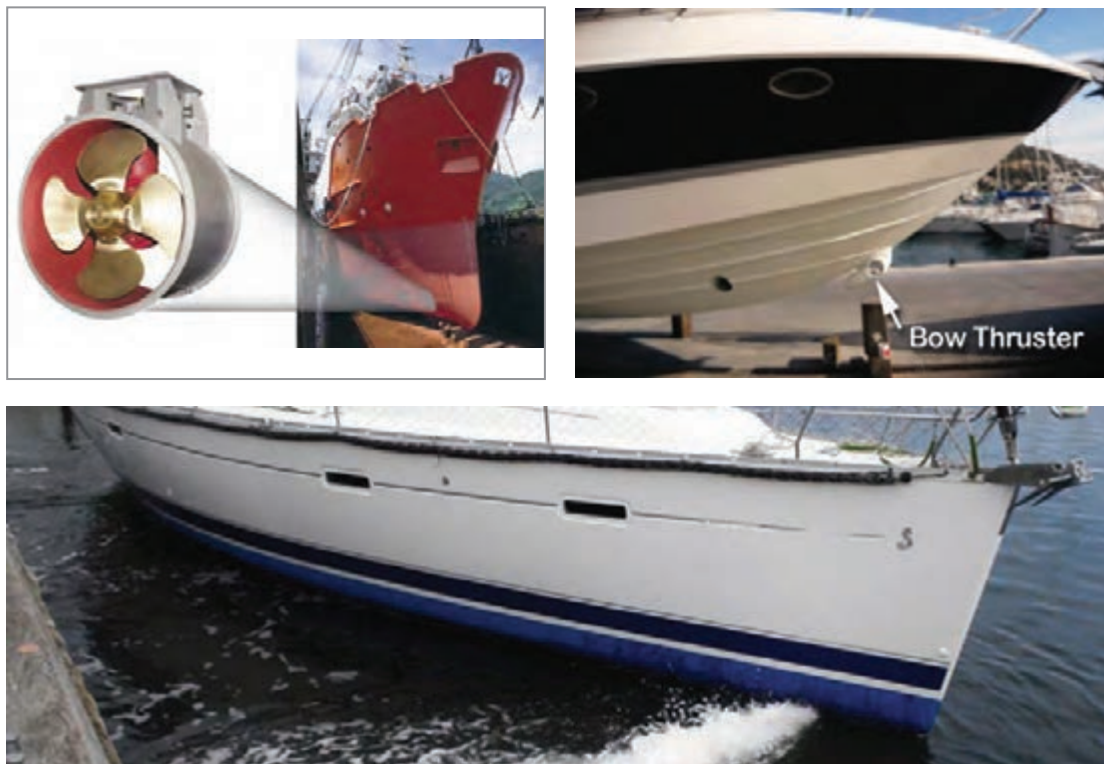
شکل ۶- پروانه‌های جانبی سینه شناور (Bow Thruster)
