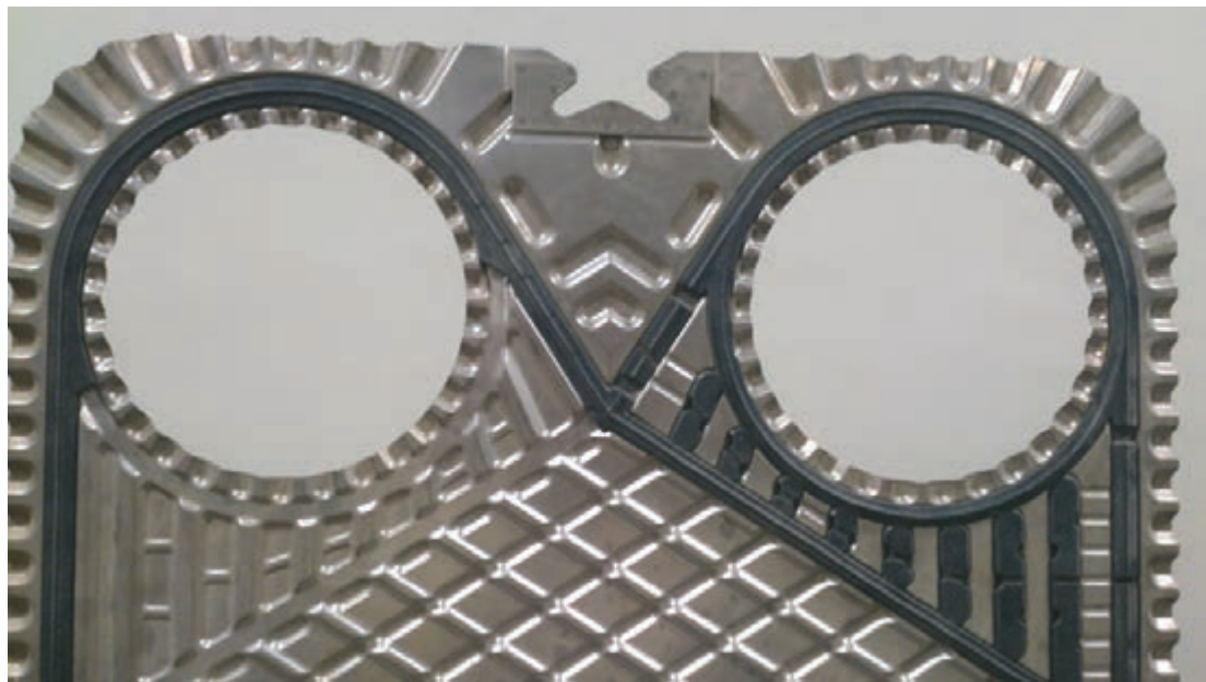
شکل ۱۲ - نوار آببندی ورود و خروج سیال
