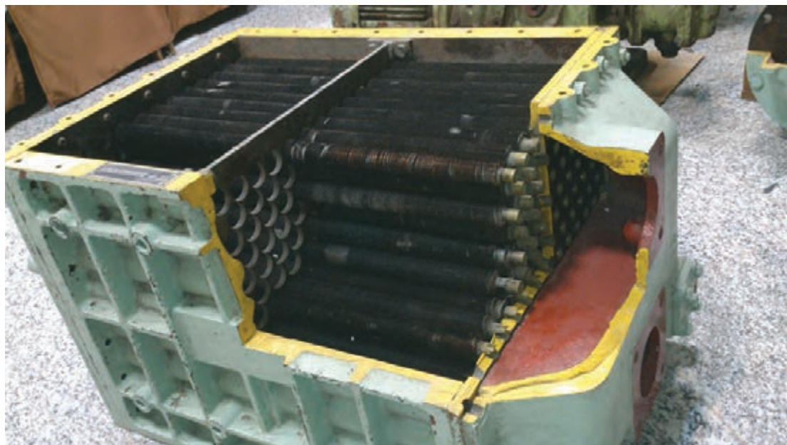
شکل ۲- کولر هوای یک موتور دیزل
