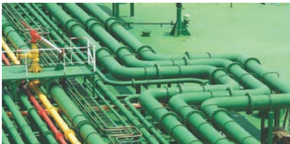
شکل ۲۹- سامانه لوله‌کشی روی عرشه یک نفتکش
