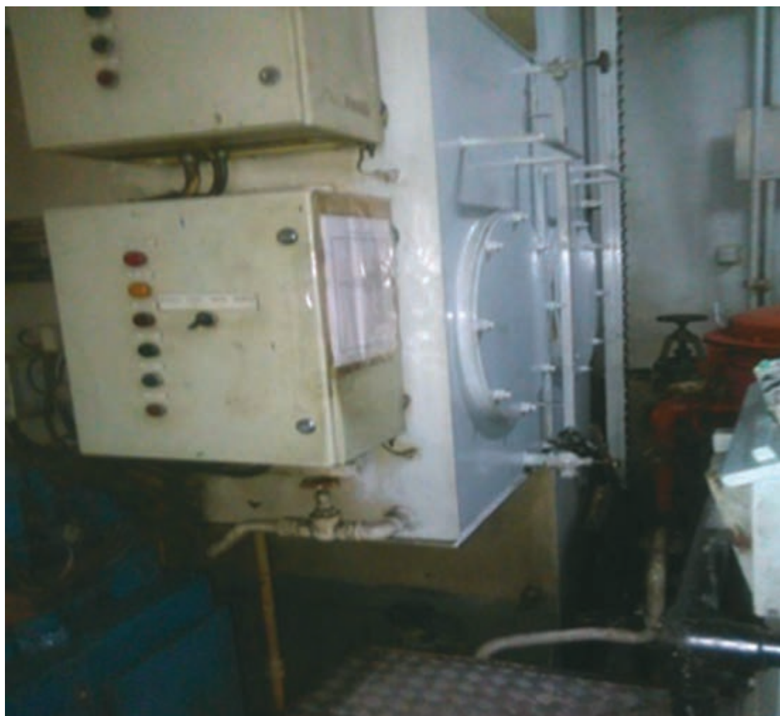
شکل ۲۳- مخزن سوخت روزانه یک شناور
