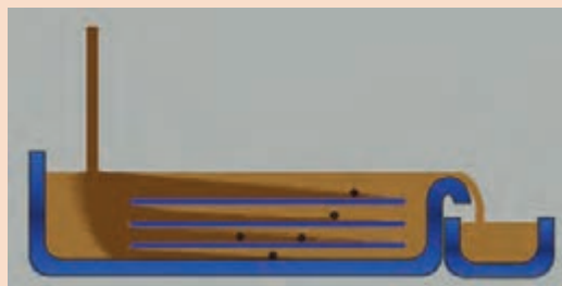
شکل ۲۰- نحوه قرار دادن صفحات موازی درون فیلتر
