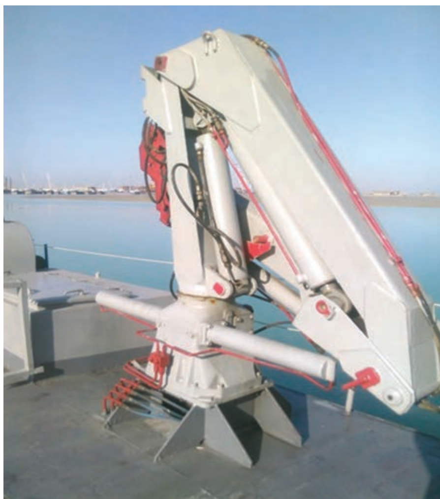
شکل ۲۲- جک هیدرولیکی بر عرشه یک شناور
