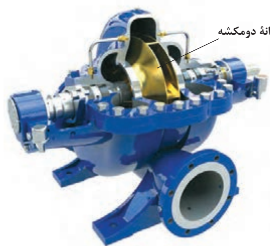
شکل ۴۱ - پمپ‌های دو مکشه برای افزایش دبی خروجی
