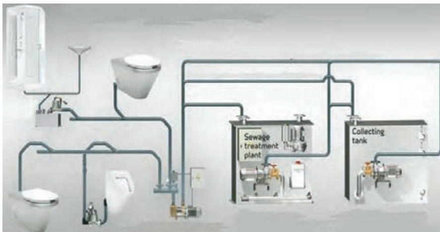
شکل ۱۴- نمودار سامانه دفع فاضلاب یک کشتی
