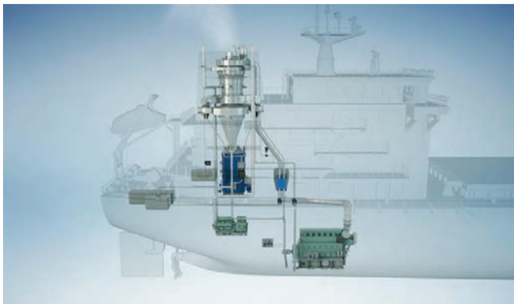
شکل ۲۶- نمایی از سامانه تخلیه دود یک کشتی
