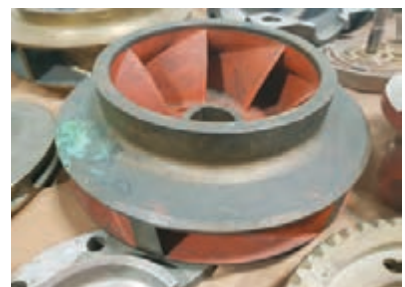
شکل ۳۶ ب) - پروانه بسته
