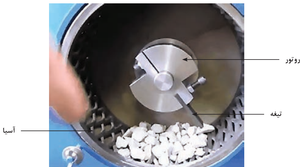
شکل ۳- نمای داخلی آسیای استاندارد ساینده باند
