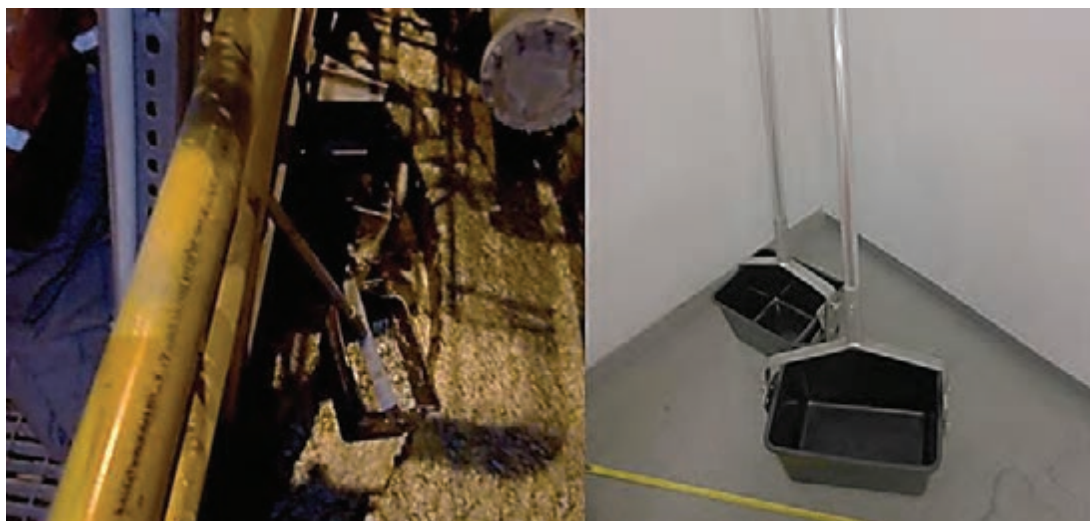
شکل ۳۴- تجهیزات نمونه گیری از سرریز سلول فلوتاسیون
