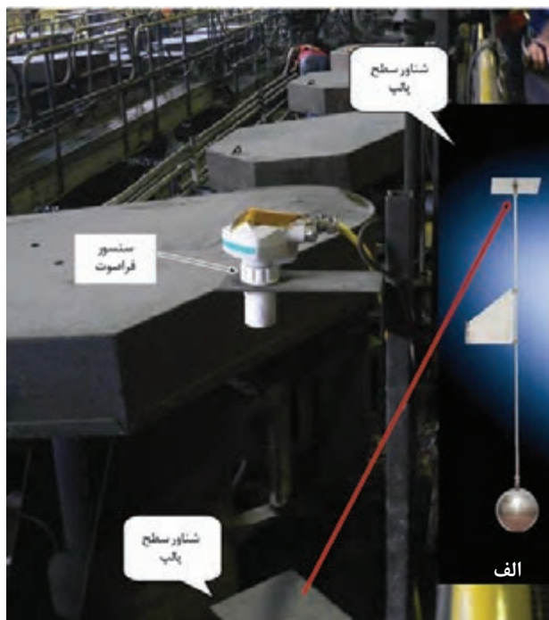
شکل ۴۱- الف) تجهیزات اندازه‌گیری عمق کف در سطح سلول فلوتاسیون، ب) شیر تخلیه سوزنی و پیستون آن
