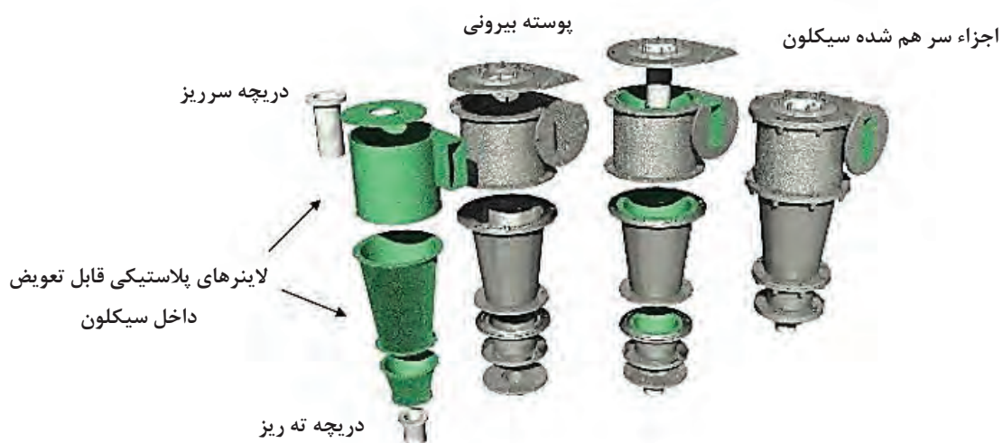
شکل ۲۱- اجزاء تشکیل دهنده سیکلون
