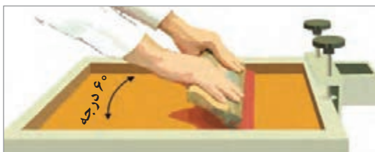
شکل ۱۶- نحوه کشیدن راکل به روش دستی
