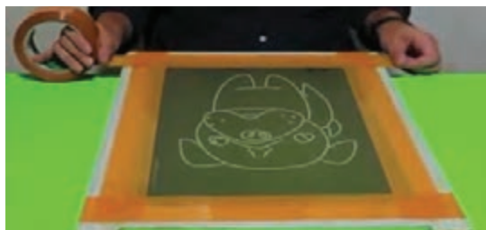
شکل ۱۴- نحوه چسب زدن پشت توری
