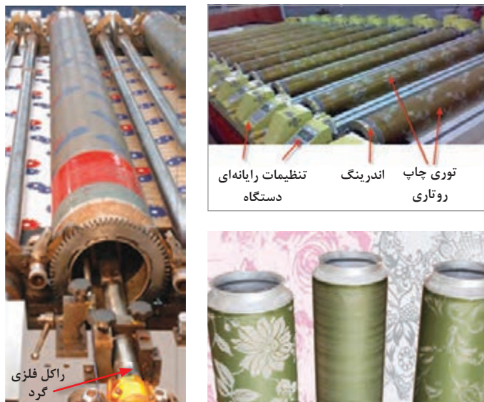
شکل ۲۱- اندیرینگ و نحوه قرارگیری آن روی شابلون روتاری و محل قرارگیری راکل و شفت
