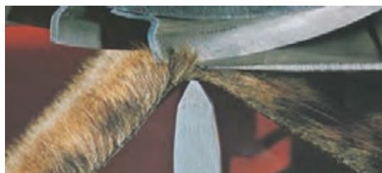
شکل ۱۰- تصویر تیغه مارپیچی و ماشین تراش پارچه
