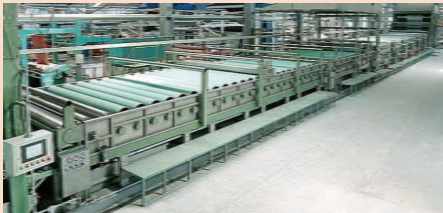
شکل ۱۲- نمایی از ماشین مرسریزاسیون غلتکی بدون زنجیر
