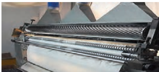
شکل ۱۰- تصویر تیغه مارپیچی و ماشین تراش پارچه
