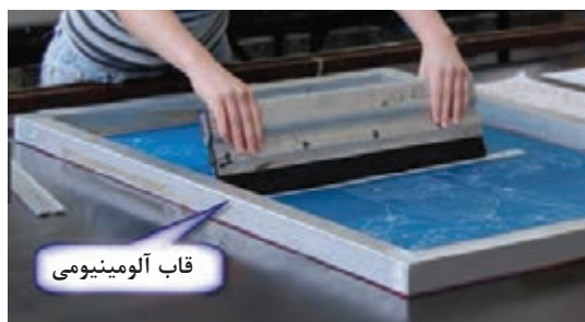
شکل ۵- نمونه‌ای از قاب آلومینیومی و قاب چوبی
