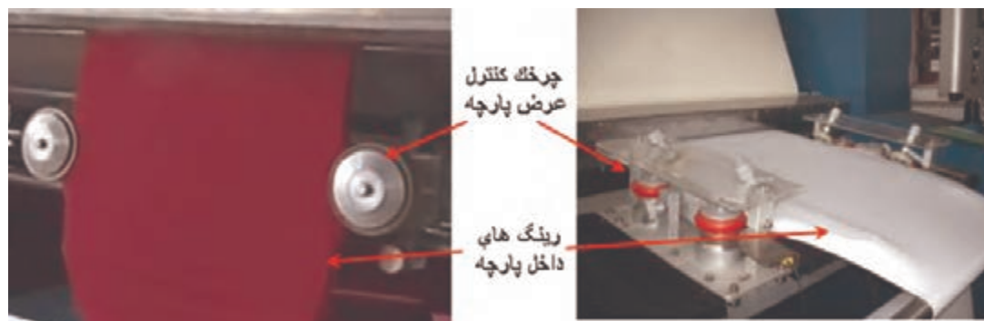
شکل ۳- ورودی پارچه برای ماشین کامپکت بغل بسته
