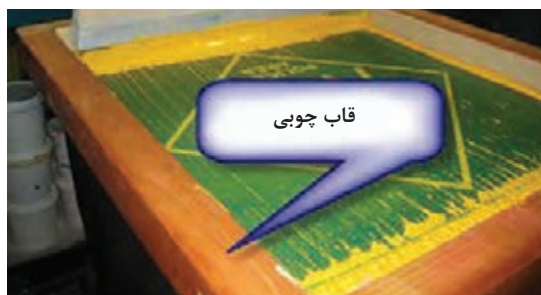
شکل ۵- نمونه‌ای از قاب آلومینیومی و قاب چوبی
