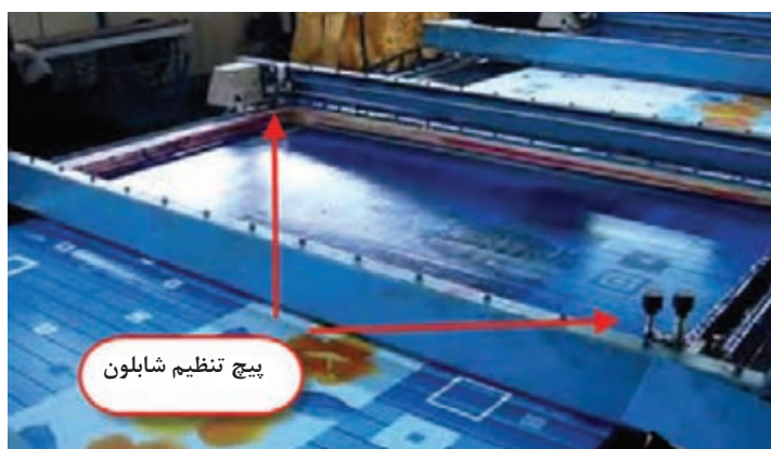
شکل ۱۰- پیچ های تنظیم شابلون
