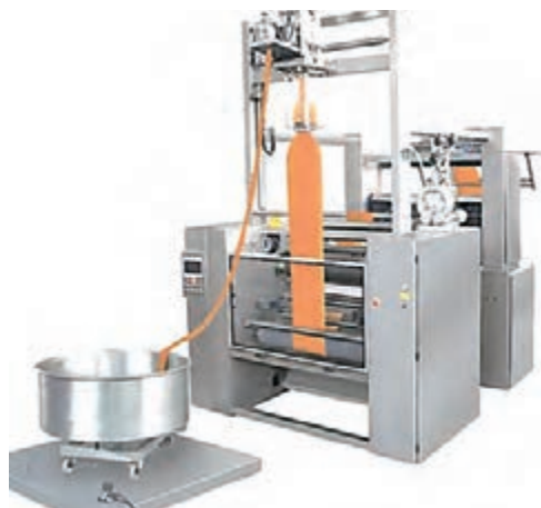
شکل ۱۴- تصویر یک آبگیر - تاب‌گیر بالنی
