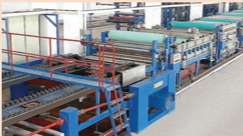
شکل ۱۱- نمای از ماشین مرسریزاسیون زنجیری
